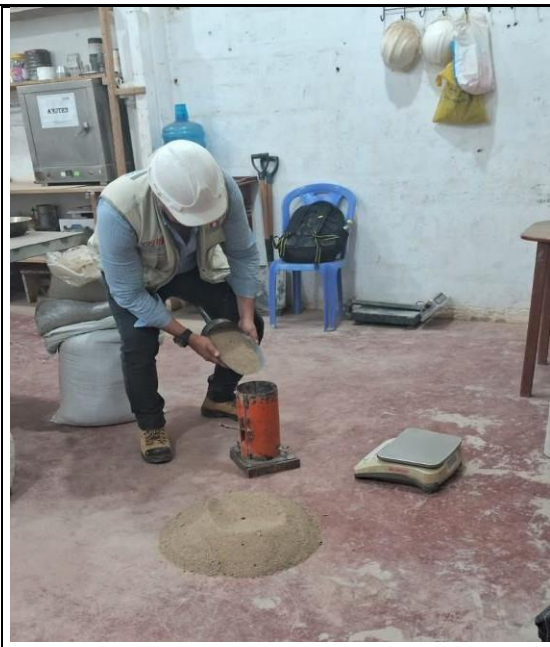
Fotos nº 07-08: En las imágenes podemos observar realización del ensayo de peso unitario.
