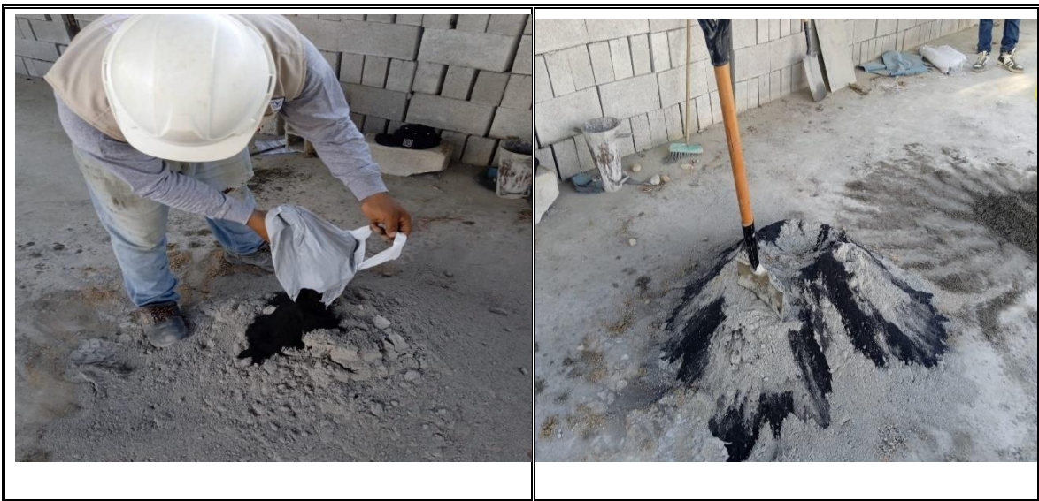
Fotos nº 15-16: En las imágenes podemos observar la preparación de mezcla de concreto para los bloques con adición de ceniza de cascarilla de arroz y sin adición de ceniza de cascarilla de arroz.
