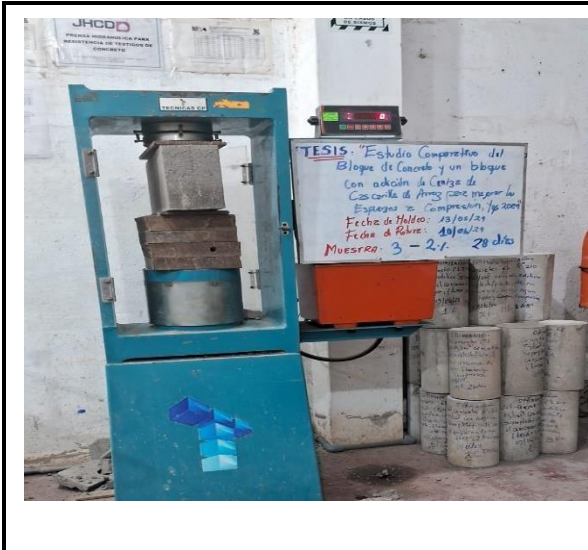
Fotos nº 24-25: En las imágenes podemos observar la resistencia a la compresión axial de los bloques de concreto.
