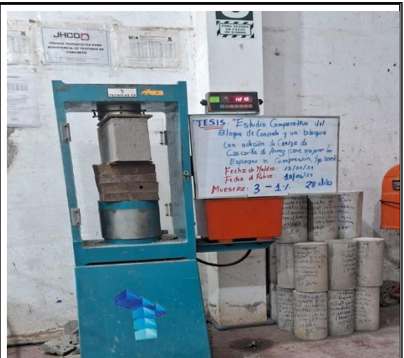
Fotos nº 23-24: En las imágenes podemos observar la resistencia a la compresión axial de los bloques de concreto.
