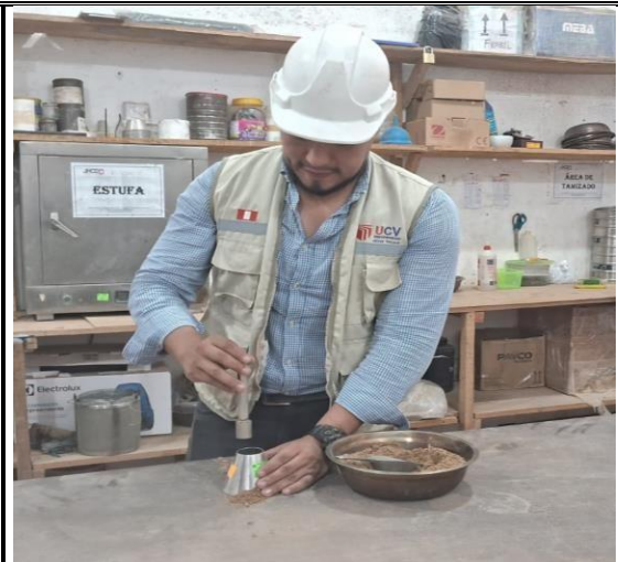
Fotos nº 05-06: En las imágenes podemos observar el ensayo de gravedad específica.
