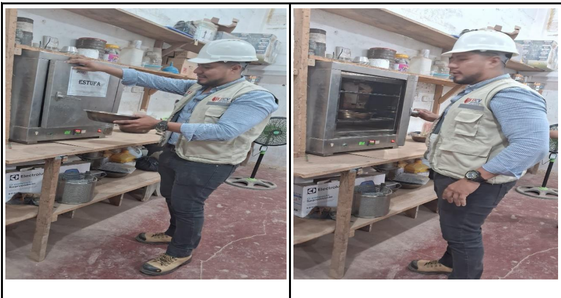
Fotos nº 11-12: En las imágenes podemos observar realizando control de humedad de los agregados.
