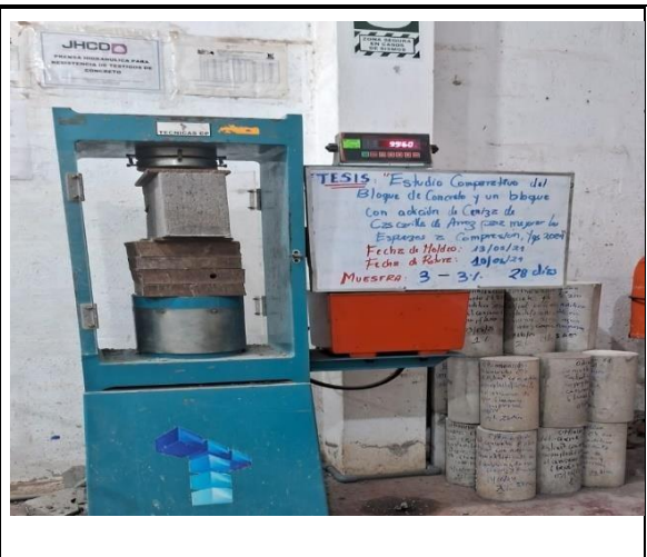
Fotos nº 26-27: En las imágenes podemos observar la resistencia a la compresión axial de los bloques de concreto.
