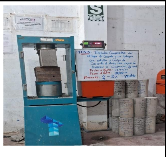
Fotos nº 24-25: En las imágenes podemos observar la resistencia a la compresión axial de los bloques de concreto.
