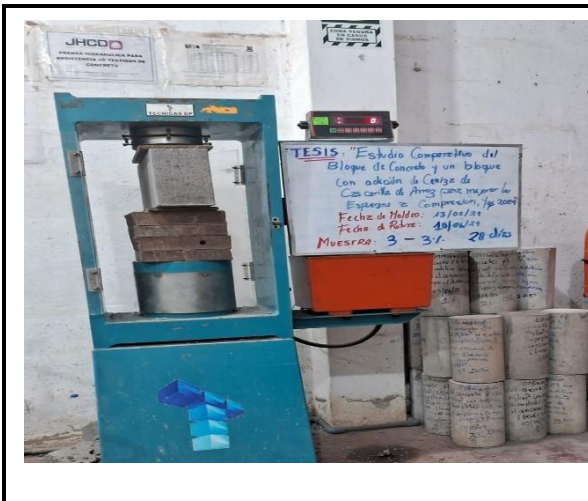
Fotos nº 26-27: En las imágenes podemos observar la resistencia a la compresión axial de los bloques de concreto.
