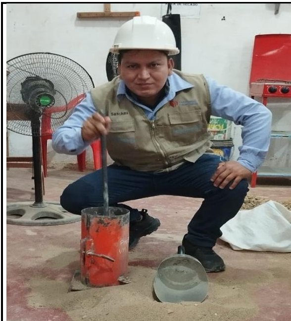
Fotos nº 07-08: En las imágenes podemos observar realización del ensayo de peso unitario.
