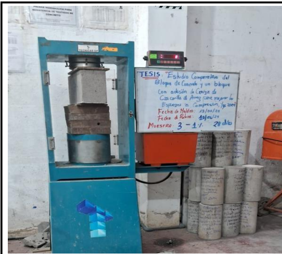
Fotos nº 23-24: En las imágenes podemos observar la resistencia a la compresión axial de los bloques de concreto.
