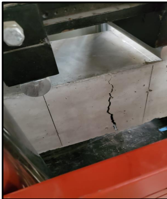
FOTO 29: fisuras de la viga. Fuente: elaboración propia (2023)
