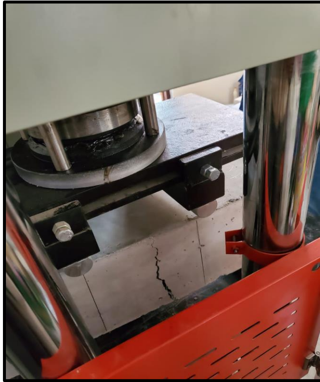
FOTO 28: ruptura de vigas en la prensa hidráulica. Fuente: elaboración propia (2023)
