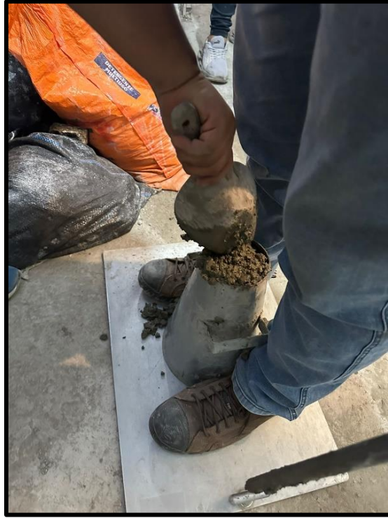
FOTO 14: llenado del cono de Abrams Fuente: elaboración propia (2023)
