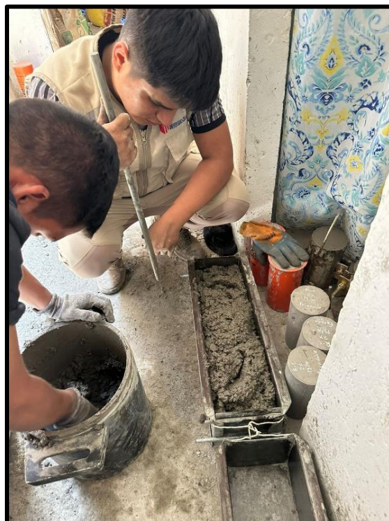
FOTO 19: Llenado del concreto a la viga Fuente: elaboración propia (2023)
