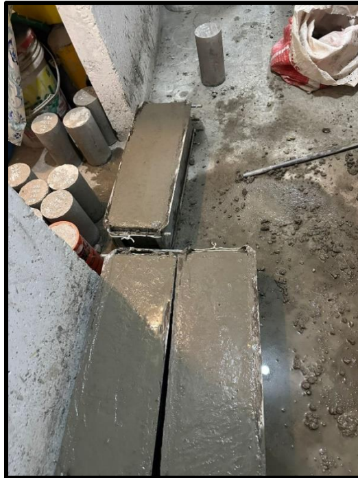
FOTO 24: vigas de concreto Fuente: elaboración propia (2023)
