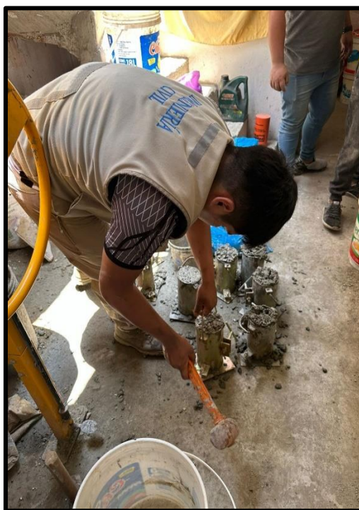
FOTO 7: 25 golpes a las probetas de concreto
