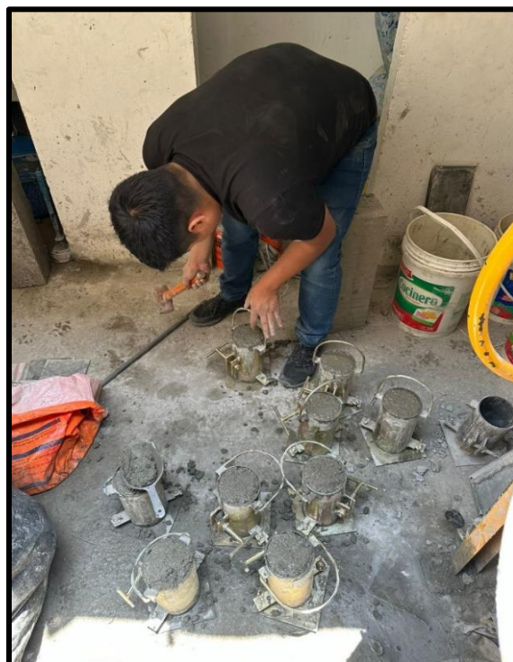
FOTO 11: perfilado de probetas Fuente: Elaboración propia (2023)
