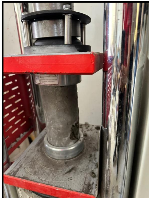
FOTO 25: roturas de concreto en el laboratorio Fuente: elaboración propia (2023)
