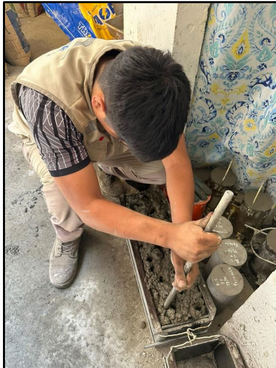
FOTO 21: golpes y varillados de la viga Fuente: elaboración propia (2023)
