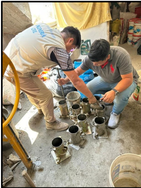
Figura 29: llenado y varillado de probetas Fuente: Elaboración propia (2023)
