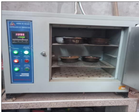
Figura 20. Ensayo de Contenido de Humedad (ASTM D - 2216)
