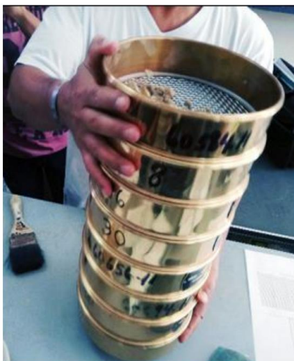
Figura 4. Tamizado del suelo por todas las mallas
