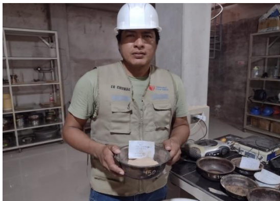
Figura 19. Ensayo de Contenido de Humedad (ASTM D - 2216)
