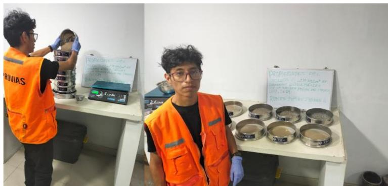
Figura 6. Granulometr a del agregado fino
