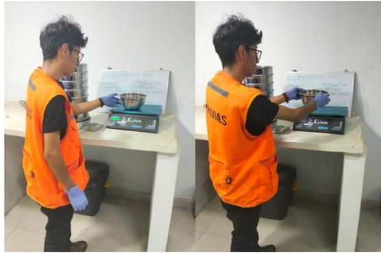
Figura 8. Granulometría del agregado grueso
