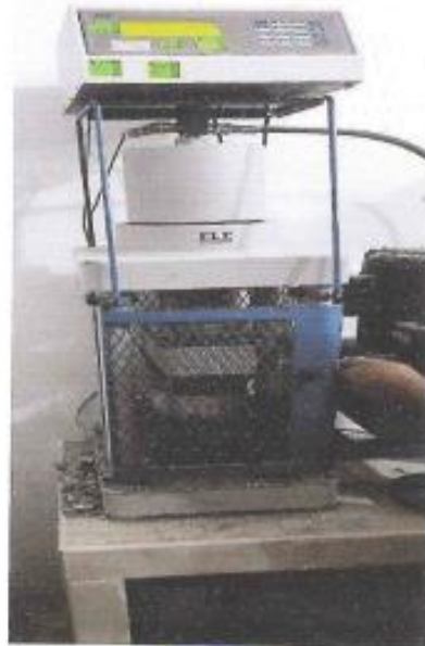
Foto 15. Proceso de rotura del ladrillo mediante prensa hidráulica.
