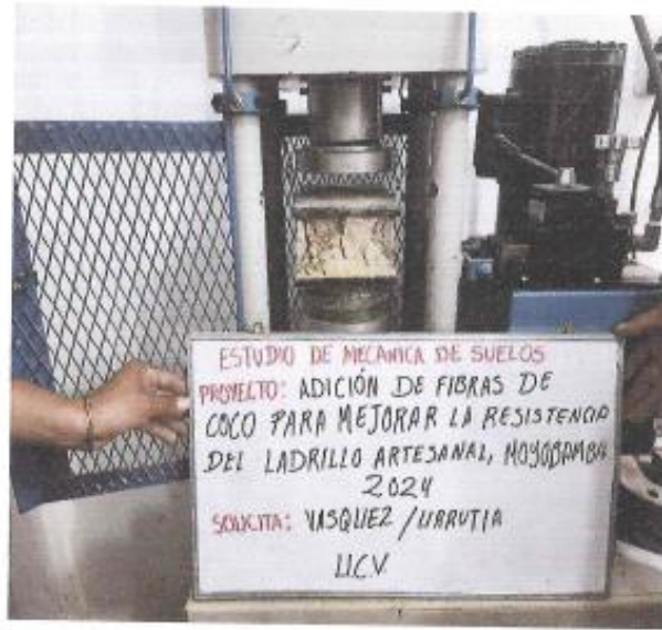
Foto 16. Término la rotura del ladrillo mediante prensa hidráulica.
