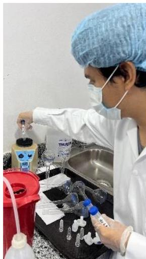
**Limpieza del Electrodo:** El electrodo, tras ser extraído de su solución de almacenamiento, fue limpiado con agua desionizada y secado con una toalla de un solo uso.
