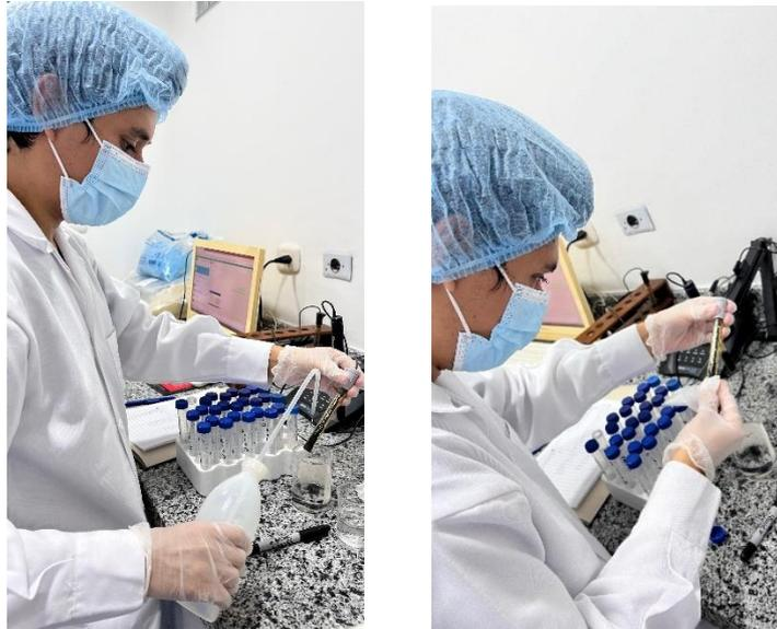
**Posicionamiento de los Viales:** Se posicionaron los viales para que el electrodo estuviera completamente sumergido.
