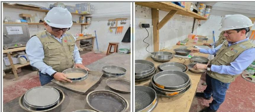
Fotos nº 01-02: En las imágenes se puede apreciar el ensayo de análisis granulométrico y lavado del agregado.
