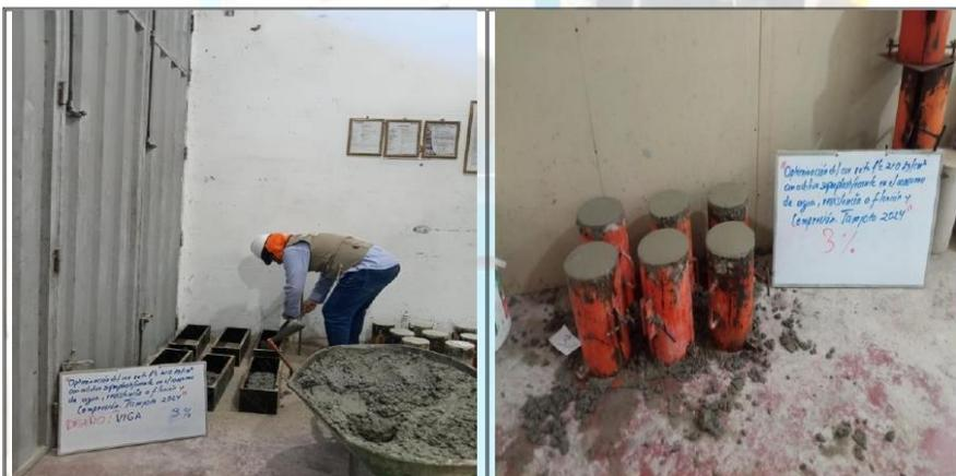
Fotos nº 15-16: En las imágenes podemos observar al personal realizando moldeo de vigas de concreto.
