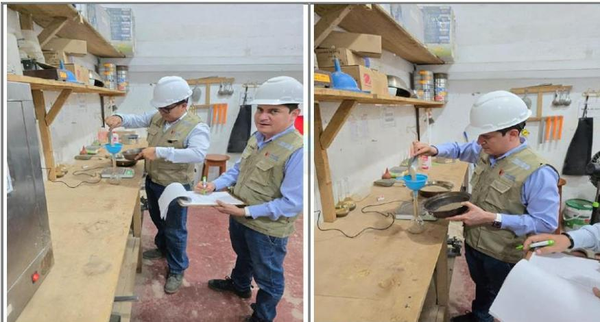
Fotos nº 09-10: En las imágenes podemos observar realización del ensayo de peso unitario.
