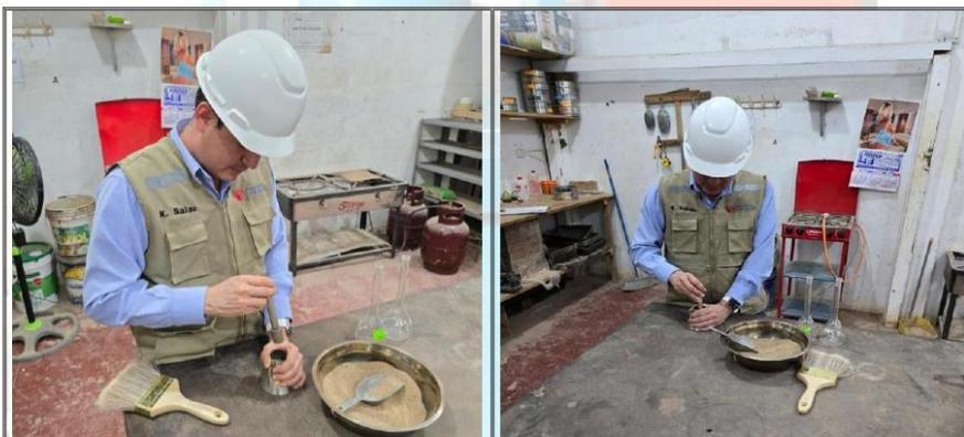
Fotos nº 03-04: En las imágenes podemos observar el ensayo de gravedad específica.
