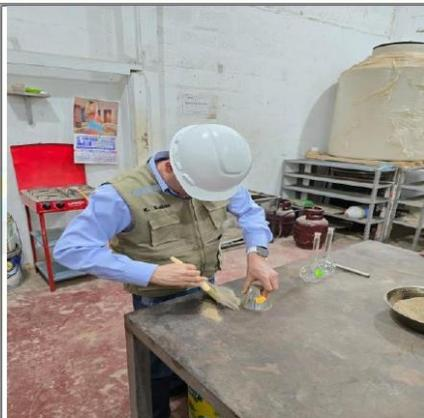
Fotos nº 05-06: En las imágenes podemos observar el ensayo de gravedad específica.
