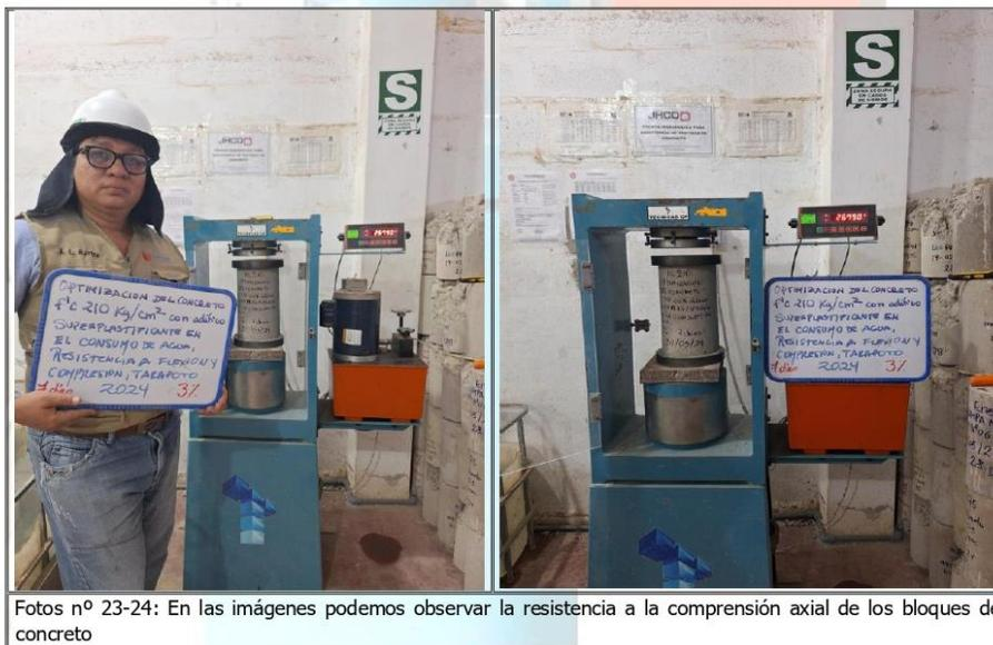
Fotos n° 23-24: En las imágenes podemos observar la resistencia a la compresión axial de los bloques de concreto
