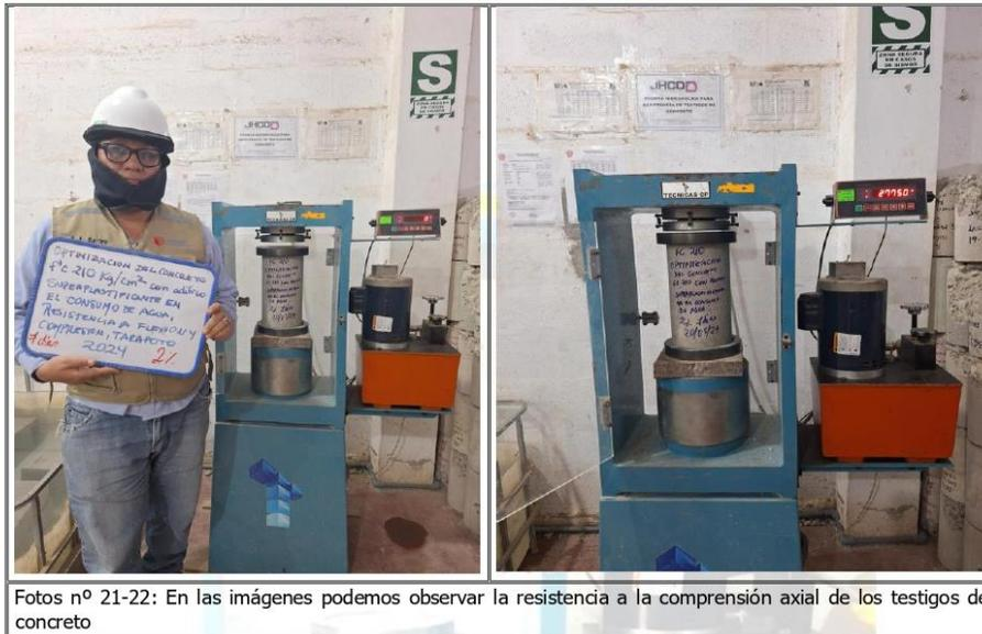
Fotos n° 21-22: En las imágenes podemos observar la resistencia a la compresión axial de los testigos de concreto
