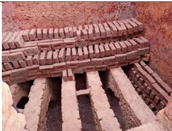
**Fotografía 14:** Proceso de carga al horno
