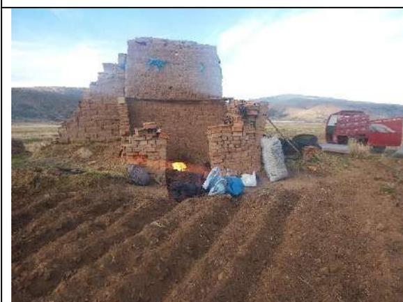
**Fotografía 17:** Proceso de cocción por 8 horas
