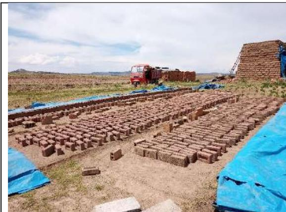
**Fotografía 13:** Secado de los ladrillos
