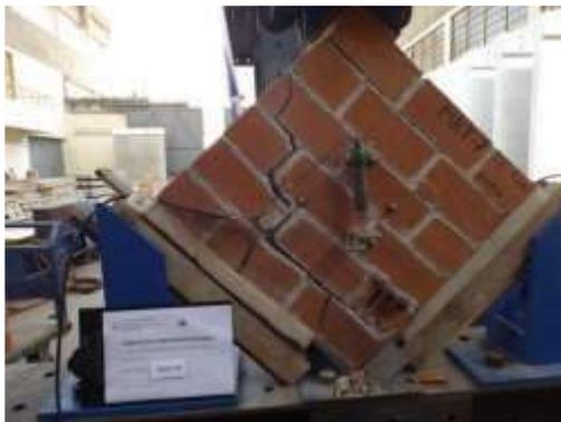
*Figura 7.* Falla escalonada en murete
