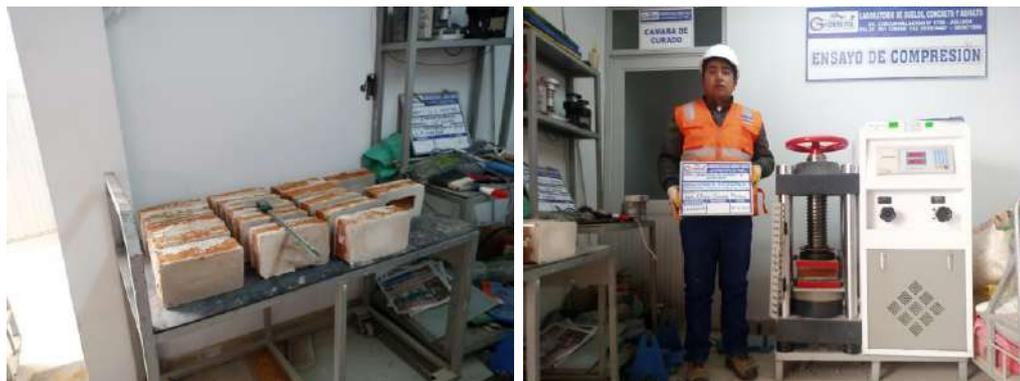
Figura 27. Ensayo de compresión
