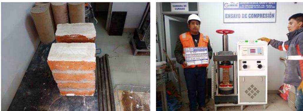
Figura 29. Ensayo de compresión en pilas
