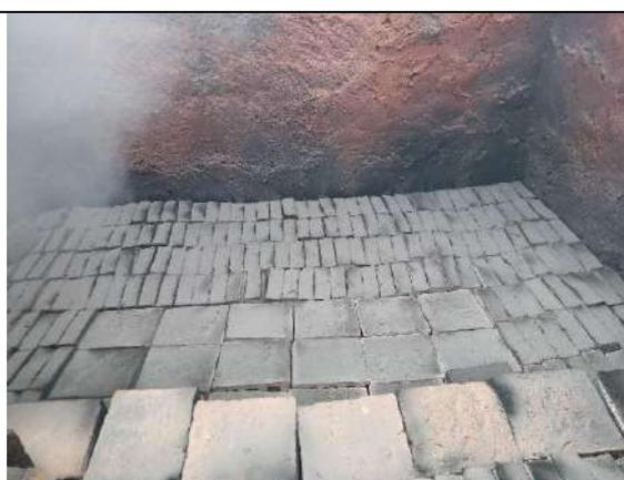
**Fotografía 18:** Proceso de cocción por 8 horas
