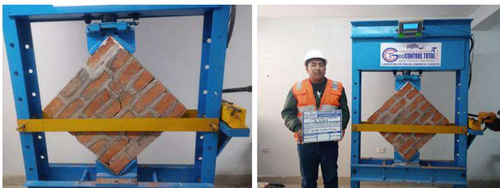
Figura 31. Ensayo de compresión diagonal
