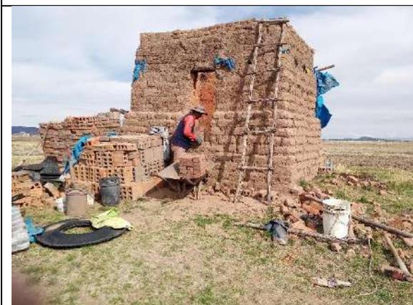
**Fotografía 15:** Proceso de carga al horno
