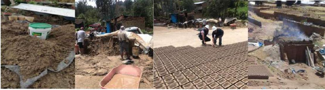
Figura 11. Proceso de elaboración del ladrillo
