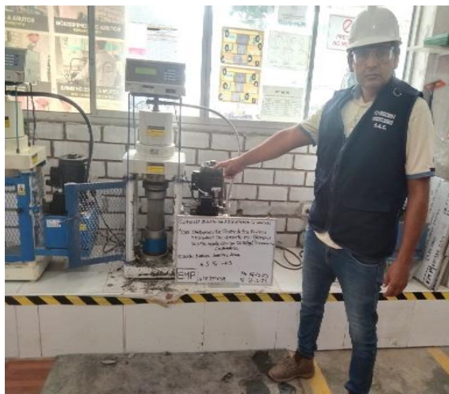
Figura 26. Ensayo de Resistencia a compresión Fuente. Propia
