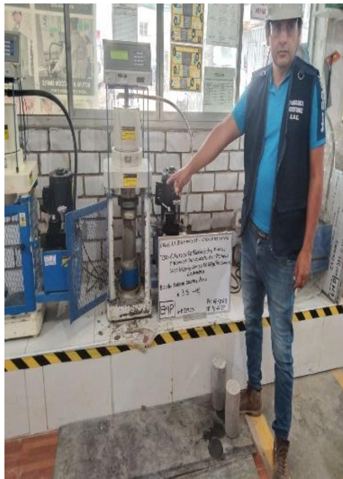
Figura 30. Ensayo de Resistencia a compresión Fuente. Propia
