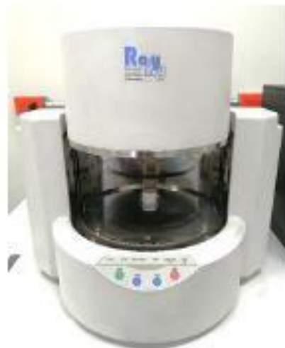
FIGURA N°2. Espectrómetro de fluorescencia de Rayos X de energía dispersiva (SHIMADZU, EDX-800HS).
