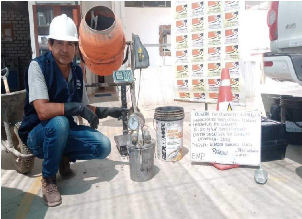
Figura 22. Contenido de Aire Fuente. Propia
