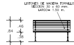
DETALLE DE BANCA VISTA FRONTAL ESC. 1/25
