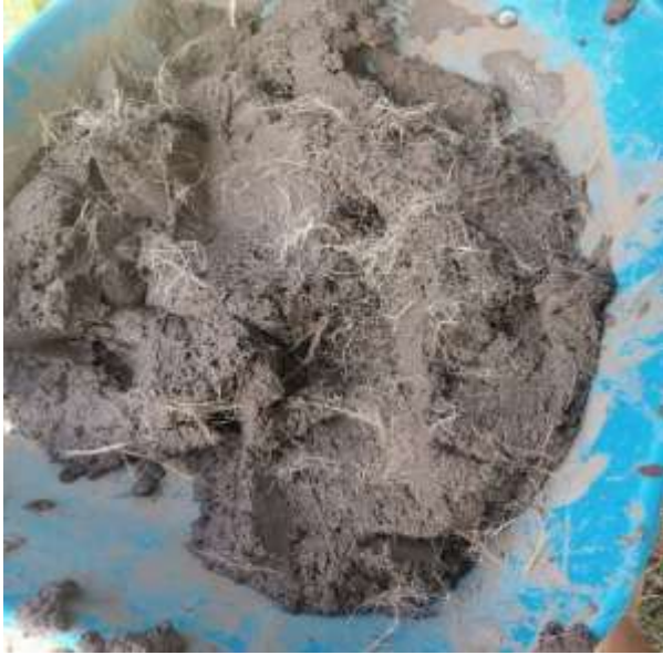
Adición de los aditivos, fibra de cabuya, en los porcentajes de 1%,2% y 3%
