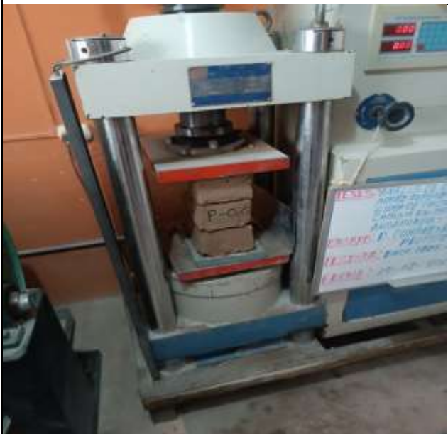
Ensayo resistencia a la compresión Prototipo (Pilas) al 0% Patrón
