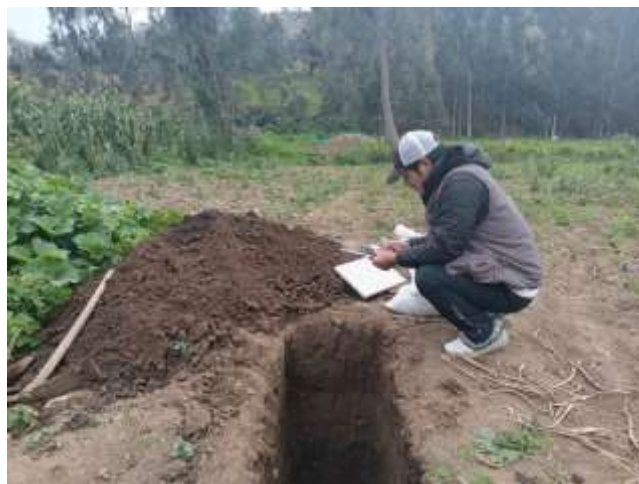
Figura 42. Toma de coordenadas de la calicata
