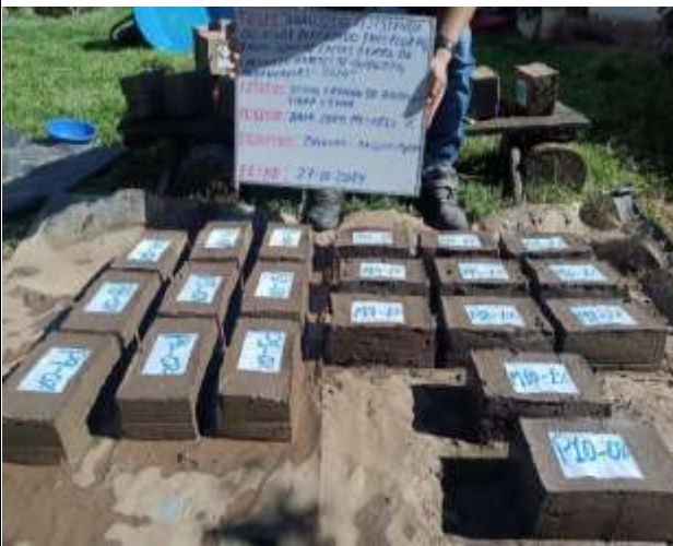
Elaboración de Bloques de adobe con adición de aditivos al 2%
