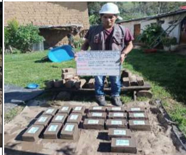
Elaboración de Bloques de adobe con adición de aditivos al 3%
