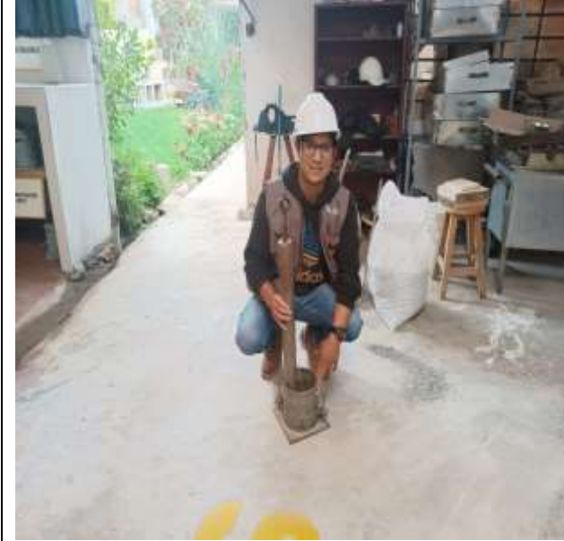
Ensayo de Proctor standar, molde de 6" y martillo de 10 lbf, de 18"
