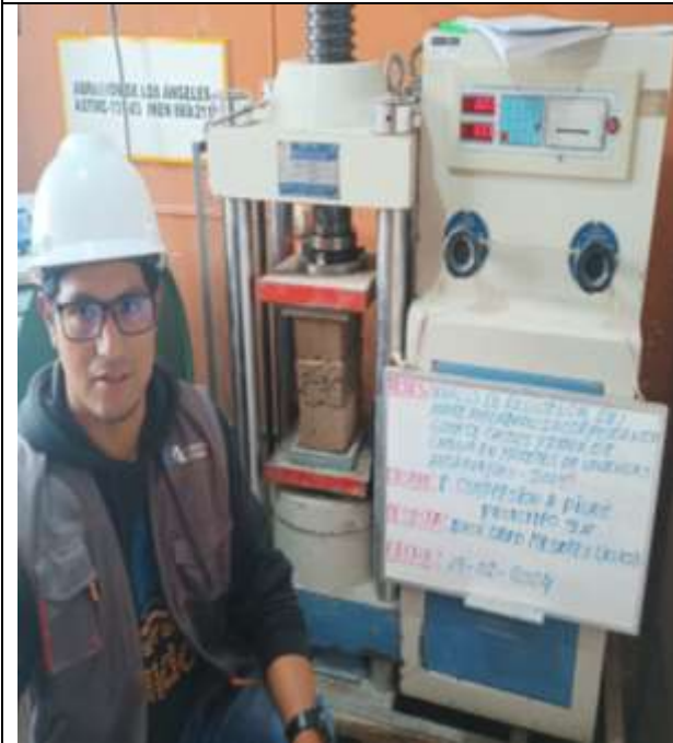
Ensayo resistencia a la compresión Prototipo (Pilas) al 3%
