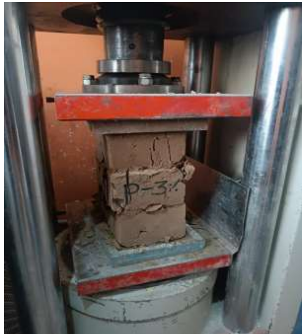
Figura 26. Ensayo de Compresión de Pilas 3%
