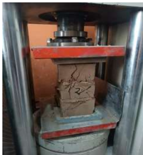
Figura 25. Ensayo de Compresión de Pilas 2%
