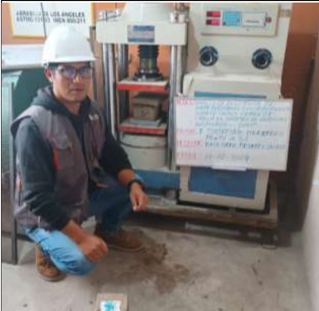
Ensayo resistencia a la compresión de la Muestras al 3%
