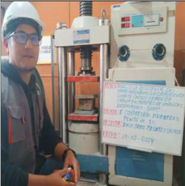
Ensayo resistencia a la compresión de la Muestras al 1%
