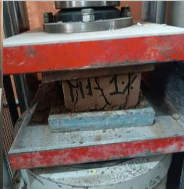
Ensayo resistencia a la compresión de la Muestras al 1%, punto de falla.
