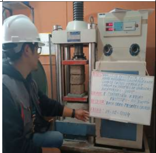
Ensayo resistencia a la compresión Prototipo (Pilas) al 0% Patrón
