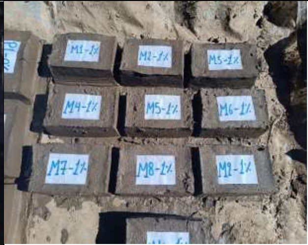
Elaboración de Bloques de adobe con adición de aditivos al 1%
