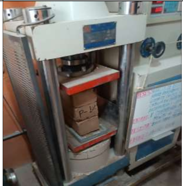
Ensayo resistencia a la compresión Prototipo (Pilas) al 1%
