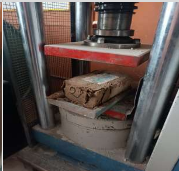
Ensayo resistencia a la compresión de la Muestras al 2%, punto de falla
