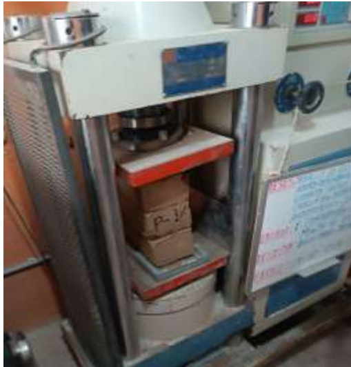
Figura 24. Ensayo de Compresión de Pilas 1%
