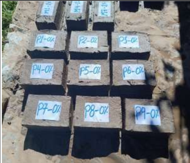
Elaboración de Bloques de adobe con adición de aditivos al 0% patrón
