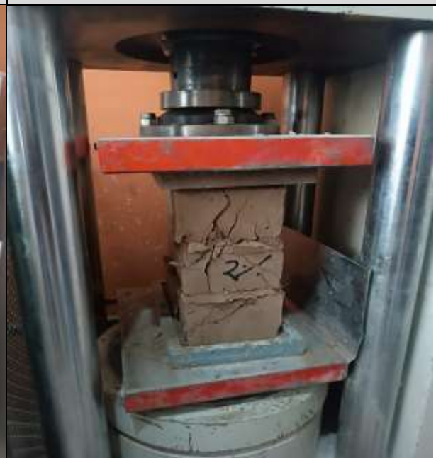
Ensayo resistencia a la compresión Prototipo (Pilas) al 2%, punto de falla
