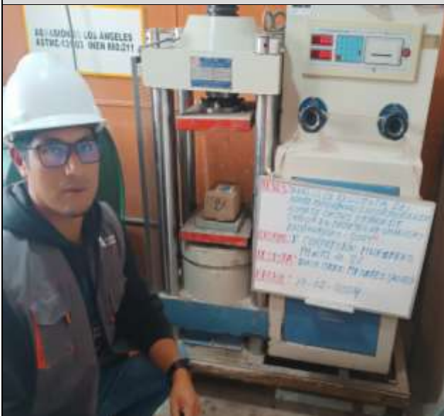
Ensayo resistencia a la compresión de la Muestras al 2%
