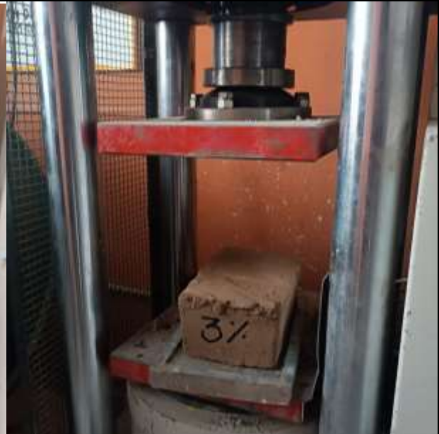
Ensayo resistencia a la compresión de la Muestras al 3%, punto de falla
