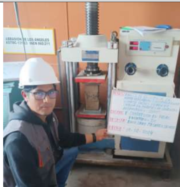
Ensayo resistencia a la compresión Prototipo (Pilas) al 2%
