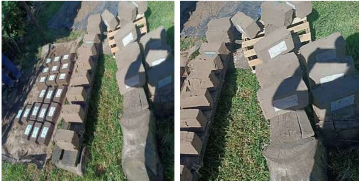
Figura 10. Preparación de muretes para ensayos estructurales
