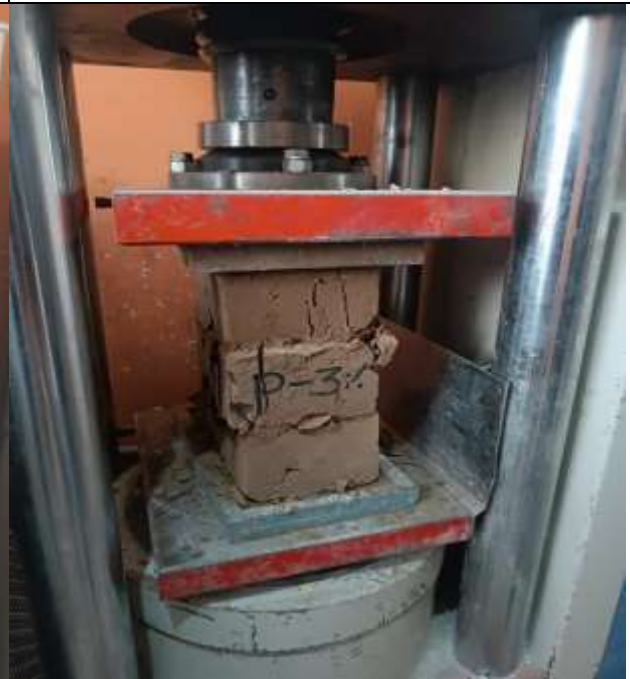
Ensayo resistencia a la compresión Prototipo (Pilas) al 3%, punto de falla
