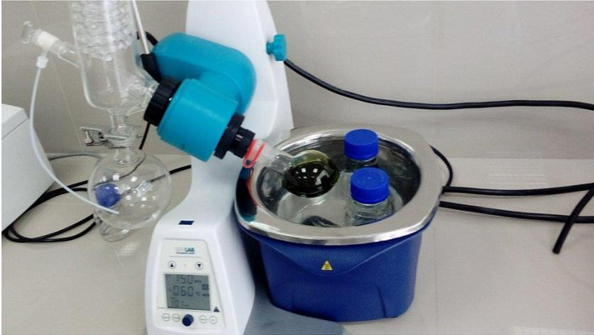
Figura 03: Concentración del extracto con un rotavapor a 55°C y 150 RPM por un periodo de evaporando 80% del solvente teniendo por resultado 30ml
