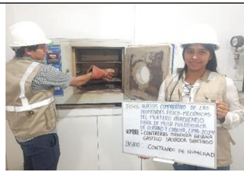
Foto 10: Contenido de Humedad
