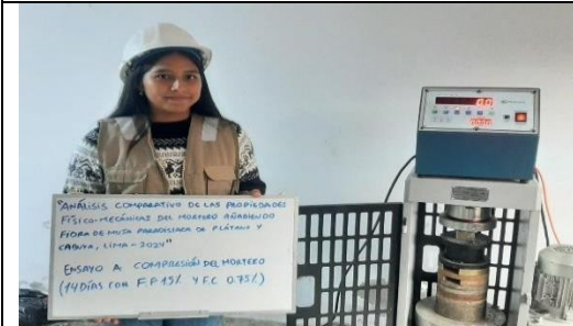
Foto 21: Ensayo de Compresión del mortero 14 días
