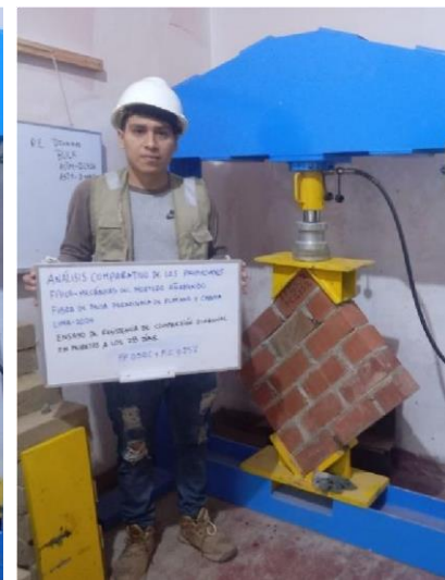
Figura 5: Ensayo resistencia a la compresión diagonal en muretes
