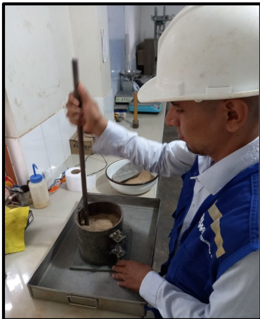
Procedimientos para PUC peso unitario compactado
