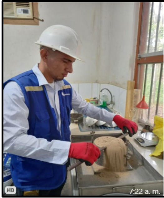
Procedimientos para peso unitario suelto
