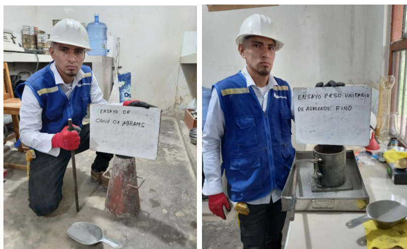
Figura 19: Medición de asentamiento
