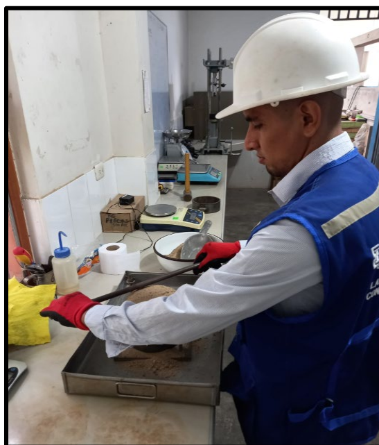
Procedimientos para PUC peso unitario compactado
