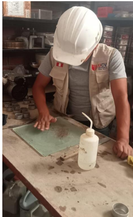
Figura 15: Trabajos en el laboratorio Wimi Construcciones – Limites Atterberg
