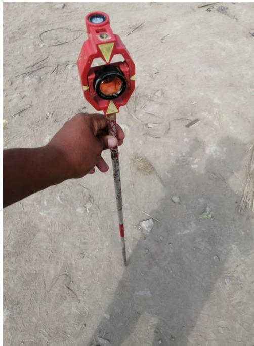
Figura 08: Prisma utilizada para el levantamiento topográfico Centro Poblado La Unión – Distrito de Pomalca – Lambayeque
