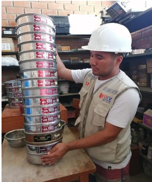
Figura 13: Trabajos en el laboratorio Wimi Construcciones – Análisis Granulométrico Fuente: Elaboración Propia
