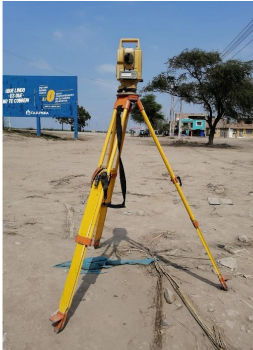
Figura 07: Estación total utilizada para el levantamiento topográfico Centro Poblado La Unión-Distrito de Pomalca – Lambayeque
