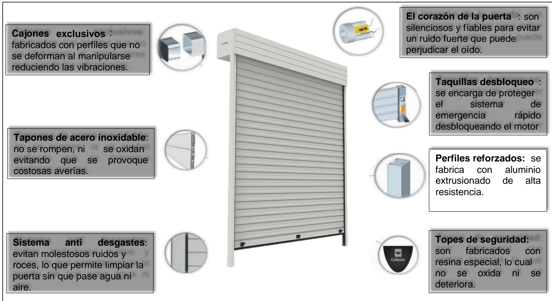
Figura 25. Composición de la puerta enrollable
