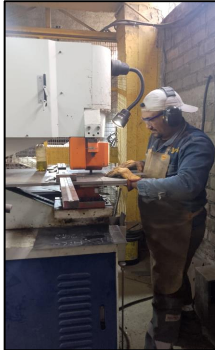
Figura 9. Troquelado en máquina Iron Worker
