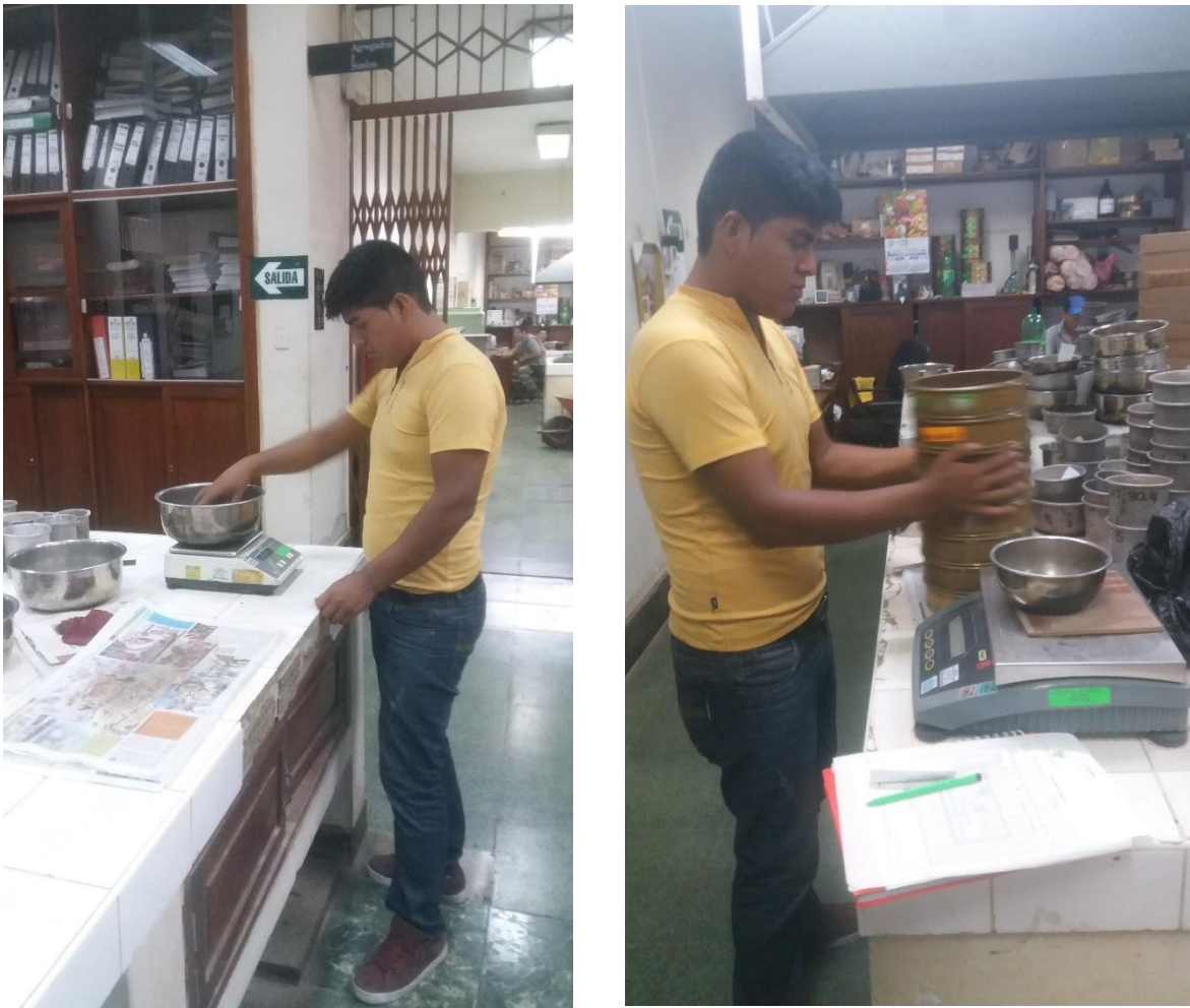
Imagen 3.4. Peso de la muestra para el ensayo granulométrico y tamizado
