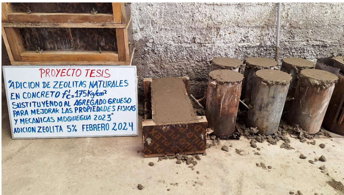
ELABORACION DE VIGAS Y PROBETAS
