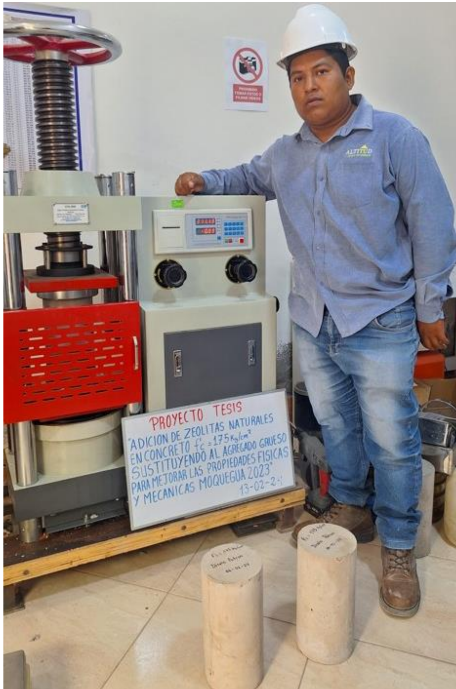
ROTURA DE ESPECIMEN A COMPRESION
