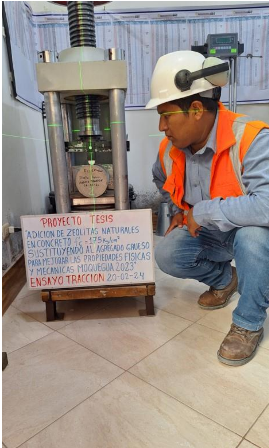
ROTURA DE ESPECIMEN A TRÁCCION
