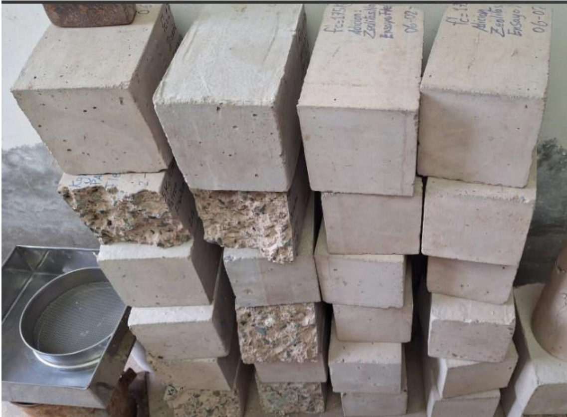
ROTURAS DE VIGAS
