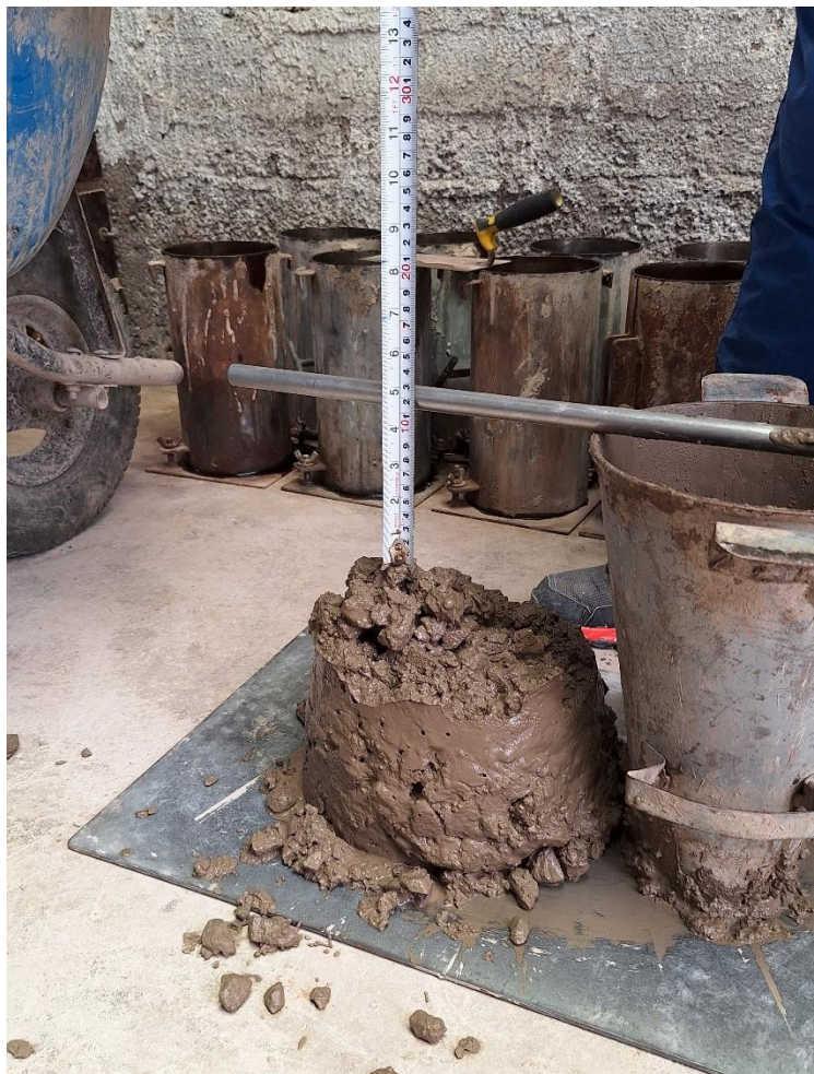
PRUEBA DE SLUMP
