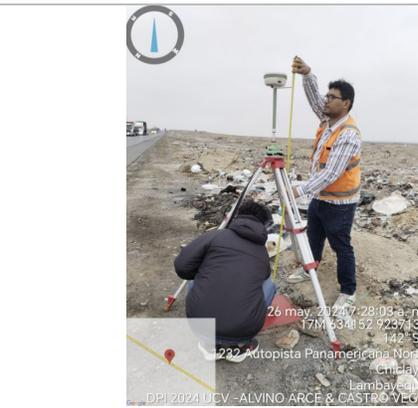
Foto 16: Mediciones de altura de antena
