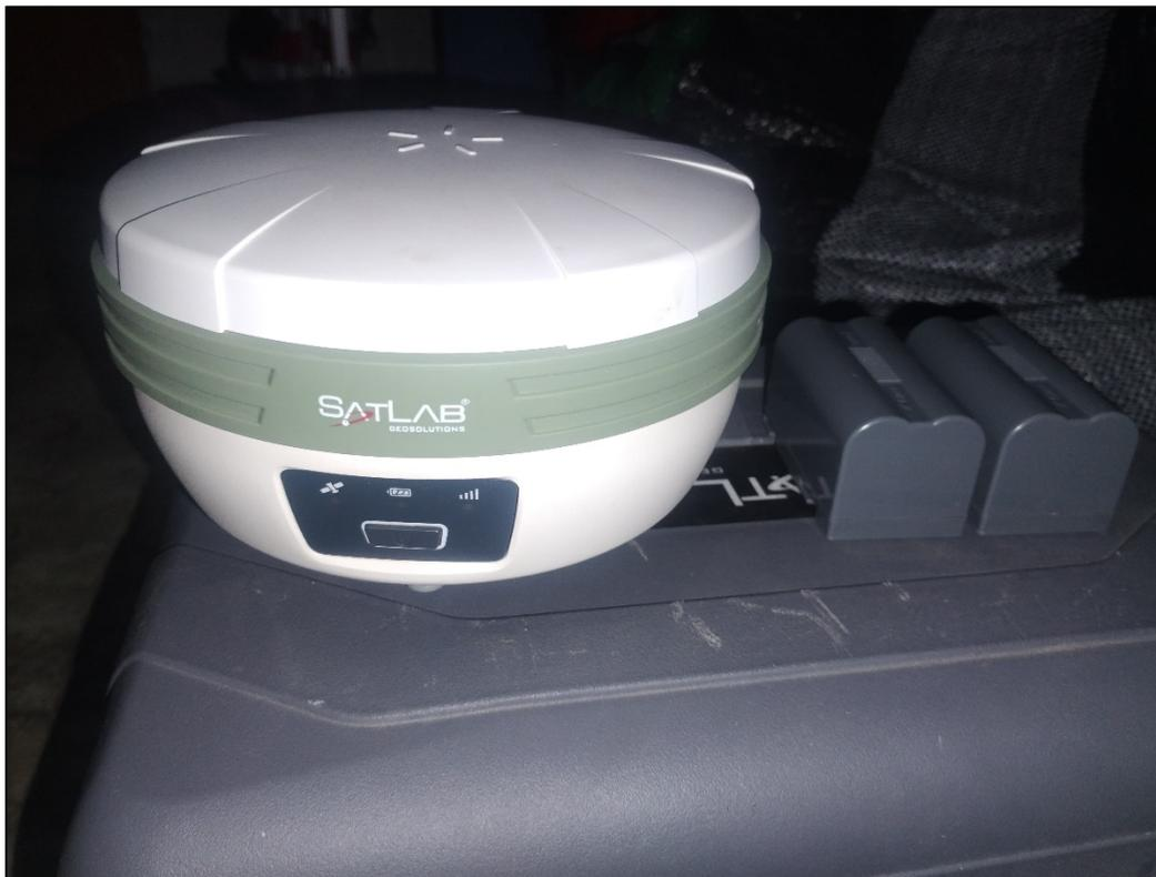
*Figura 4:* Equipo Receptor GNSS SatLan utilizado para georreferenciar el levantamiento fotogramétrico
