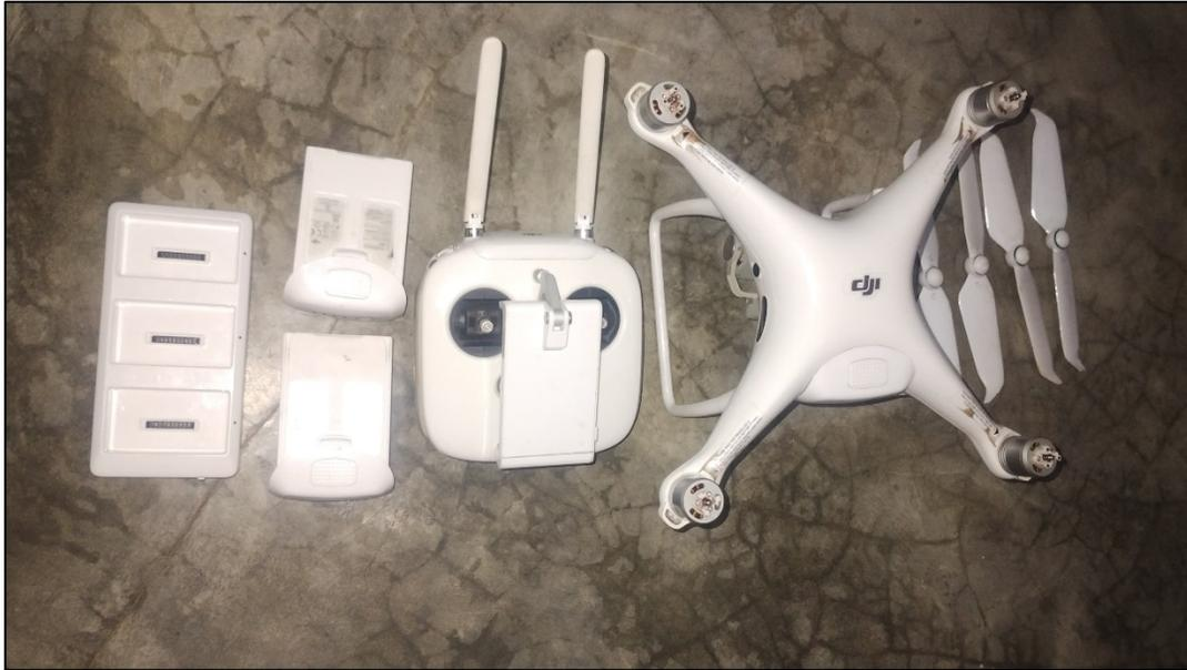
*Figura 3:* Equipo Drone Phantom 4 Pro v2 utilizado para vuelo fotogramétrico
