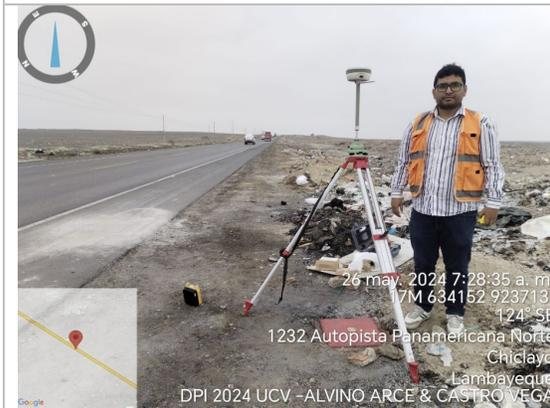
Foto 15: Receptor GNSS instalado
