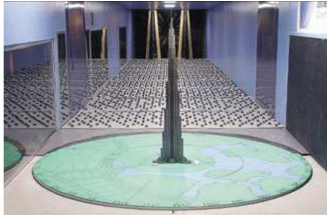
Figura 13: Modelo en Túnel de Viento,
