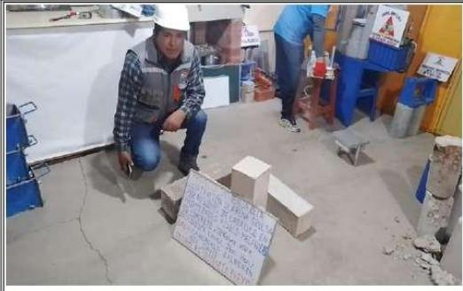
DESCRIPCION : En la fotografia se muestra viga de prueba para analizar resistencia a la flexion y su verificacion en relacion de vacios
