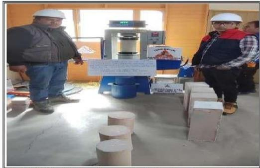
DESCRIPCION: En la fotografia se muestra la briqueta en la prensa hidraulica para su determinacion del tipo de falla.
