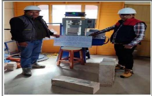
DESCRIPCION : En la fotografia se muestra muestra viga de prueba para analizar resistencia a la flexion y su posterior lectura .
