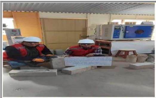
DESCRIPCION: En la fotografia se muestra viga de prueba para analizar resistencia a la flexion y su posterior verificacion el tipo de falla.
