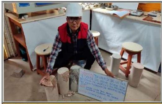
DESCRIPCION : En la fotografia se muestra briquetas para determinar el tipo de falla con incorporacion de ladrillo.
