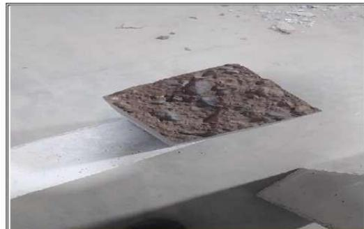
DESCRIPCION : En la fotografia se muestra viga de prueba para analizar resistencia a la flexion con incorporacion de ladrillo .
