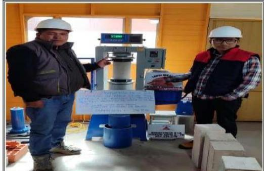
DESCRIPCION: En la fotografia se muestra la colocacion de briquetas en la prensa hidraulica alineándolo al eje central.
