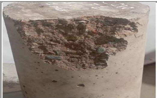
DESCRIPCION : En la fotografia se muestra briquetas con incorporacion con residuos de ladrillos.
