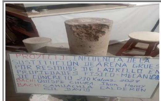
DESCRIPCION: Se muestra briquetas con 0%,5%,10%,15% incorporarios con residuos de ladrillos.
