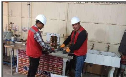
DESCRIPCION: En la fotografia se muestra ensayos de granulometria para agregados arena fina.
