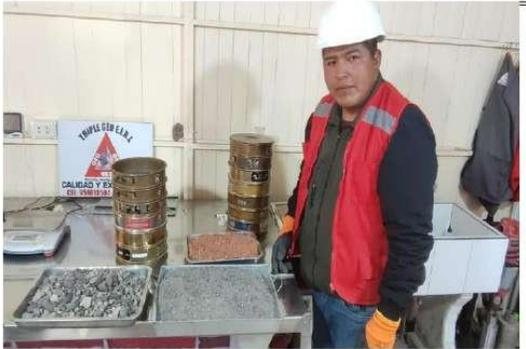
DESCRIPCION : En la fotografia se muestra Agregado fino como agregado Grueso y ladrillo para su respectivo tamizaje.
