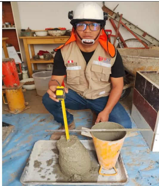
Asentamiento del concreto
