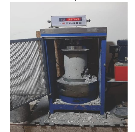
Rotura de probetas cilíndricas patrón 28 días
