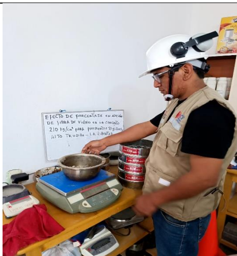
Pesado de agregado grueso
