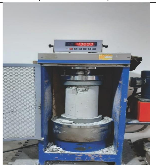
Rotura de probetas cilíndricas con % de adición 28 días
