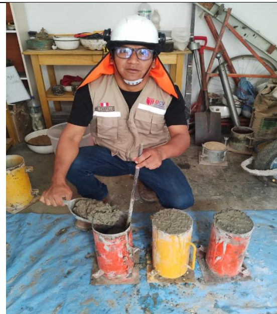
Vaciado de probetas cilíndricas
