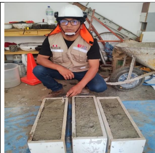
Vaciado de probetas en forma de viga
