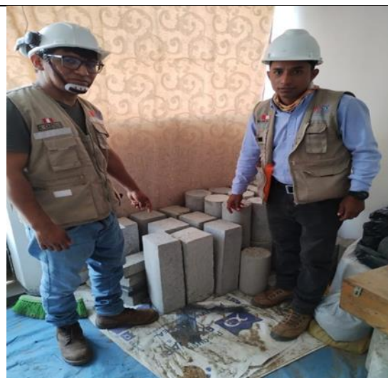
Probetas listas para rotura
