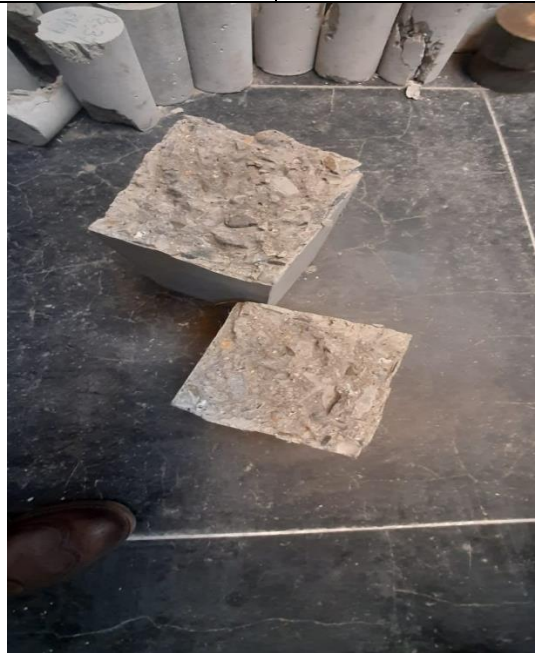
Rotura de probetas de probetas prismáticas en forma de viga
