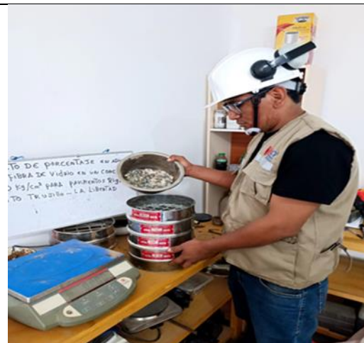
Tamizado para agregado de 1/2"
