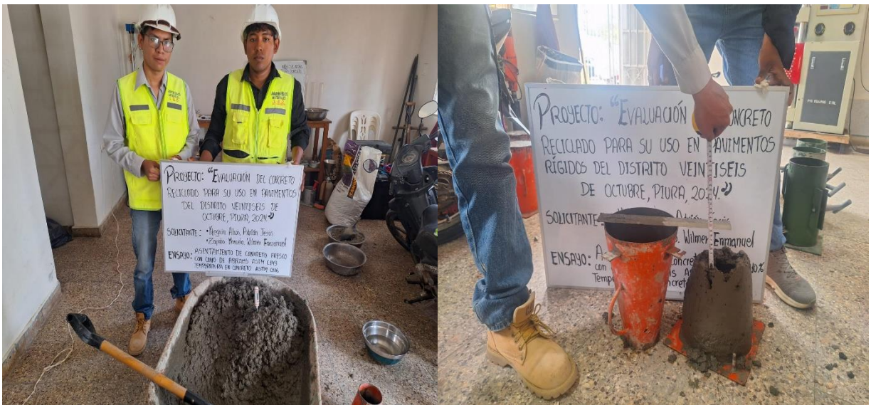
Figura 6. Asentamiento del concreto con cono de Abrams ASTM C143.
