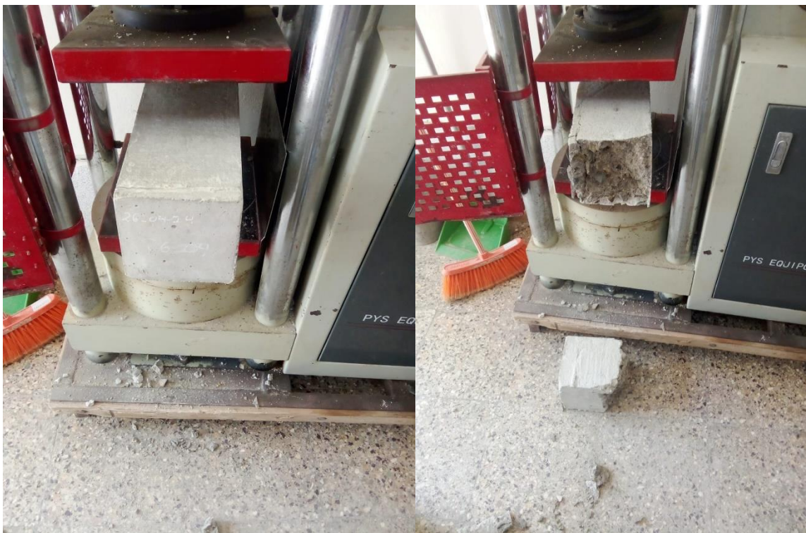
Figura 10. Ensayo de flexión (rotura de vigas)
