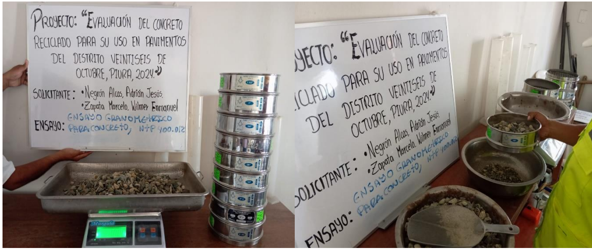
Figura 5. Ensayo granulométrico de los agregados
