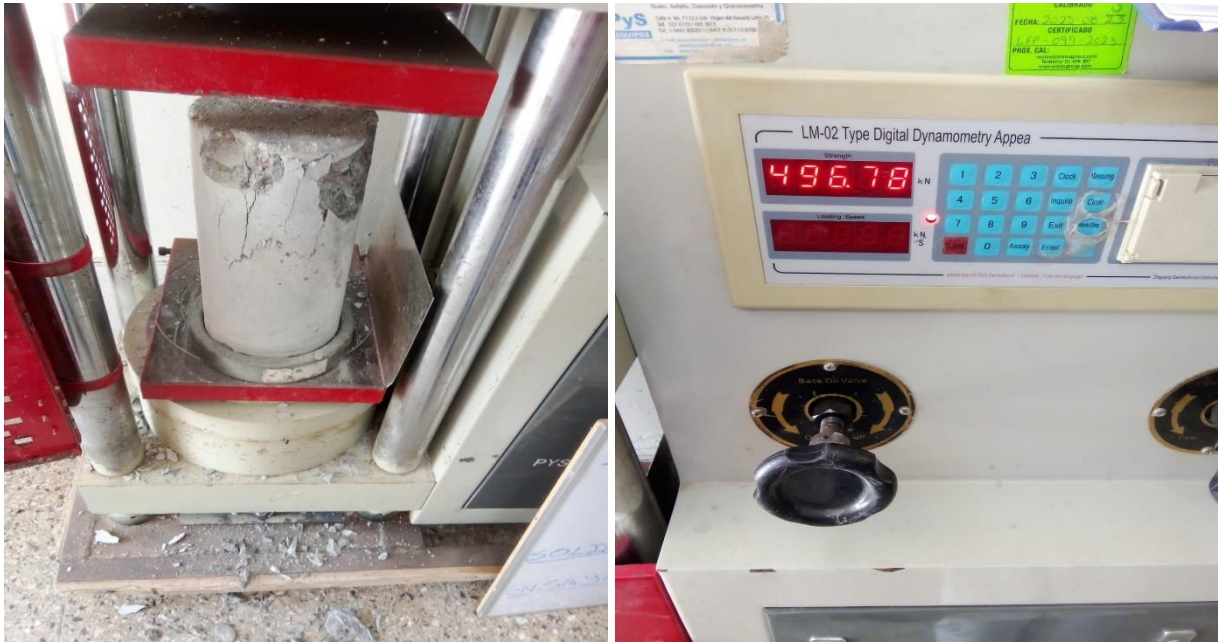
Figura 9. Ensayo de compresión (rotura de probetas)
