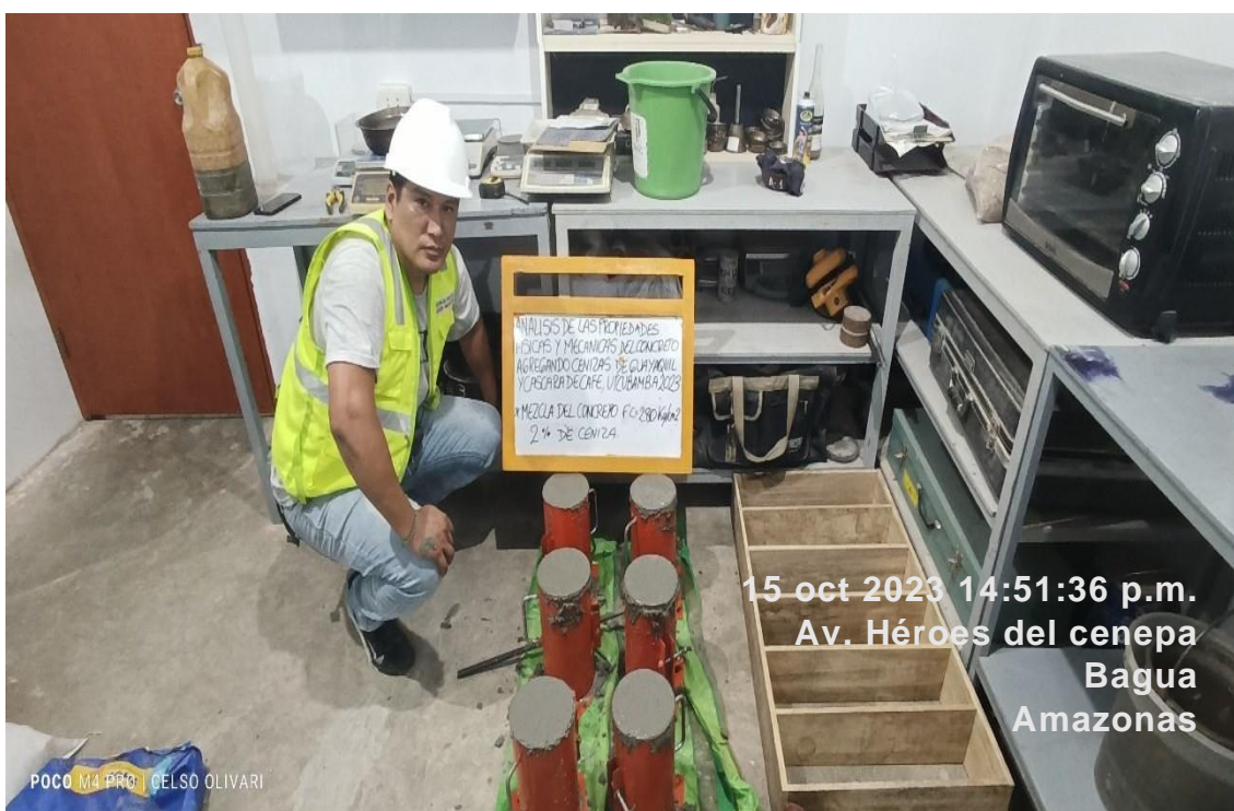
Figura 27. Probetas de concreto con 2% de cenizas Fuente: elaboración propia
