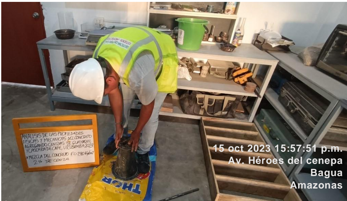
Figura 20. Prueba de asentamiento del concreto en el CONO DE ABRAMS Fuente: elaboración propia
