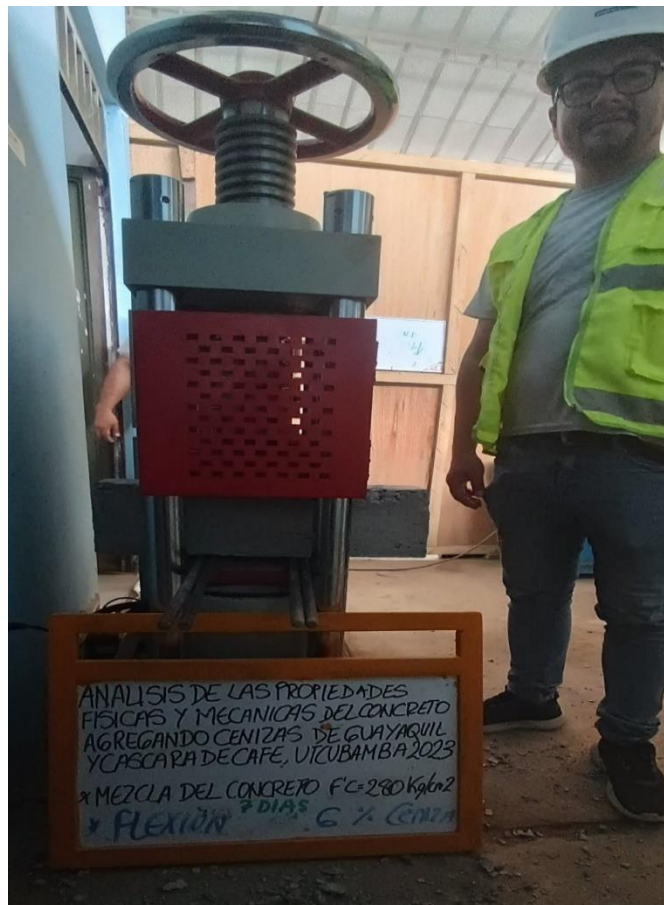
Figura 38. Sometimiento de testigos a los ensayos de resistencia a la flexión
