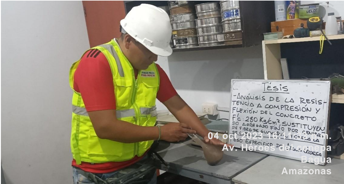
Figura 16. Peso específico de agregado fino – arena gruesa Fuente: elaboración propia
