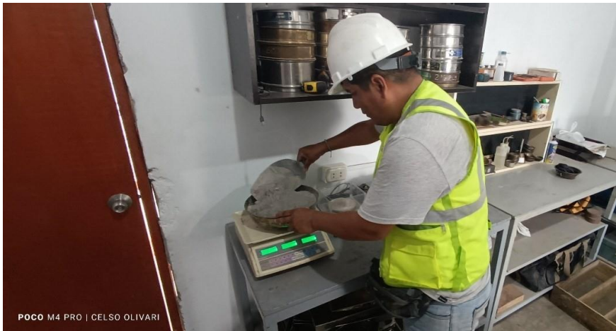
Figura 31. Peso específico cenizas al 2% Fuente: elaboración propia
