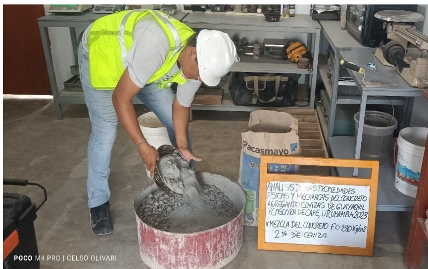
Figura 30. Agrado fino y grueso con cenizas al 2% Fuente: elaboración propia
