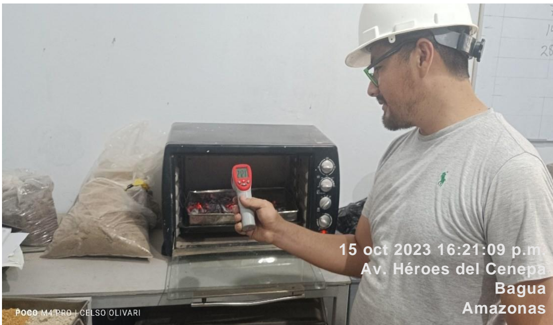
Figura 5. Obtención de las cenizas a través del horno a temperatura de 470° c. Fuente: elaboración propia
