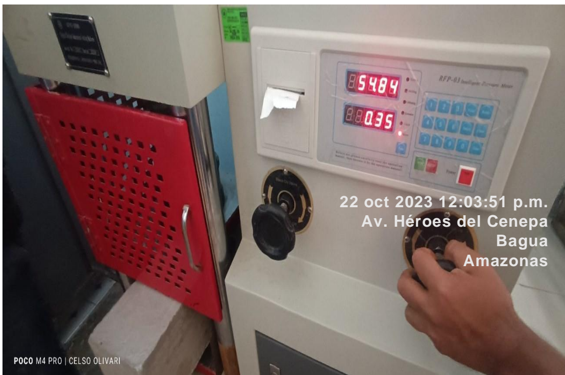
Figura 42. Datos obtenidos en los ensayos de resistencia a la flexión.
