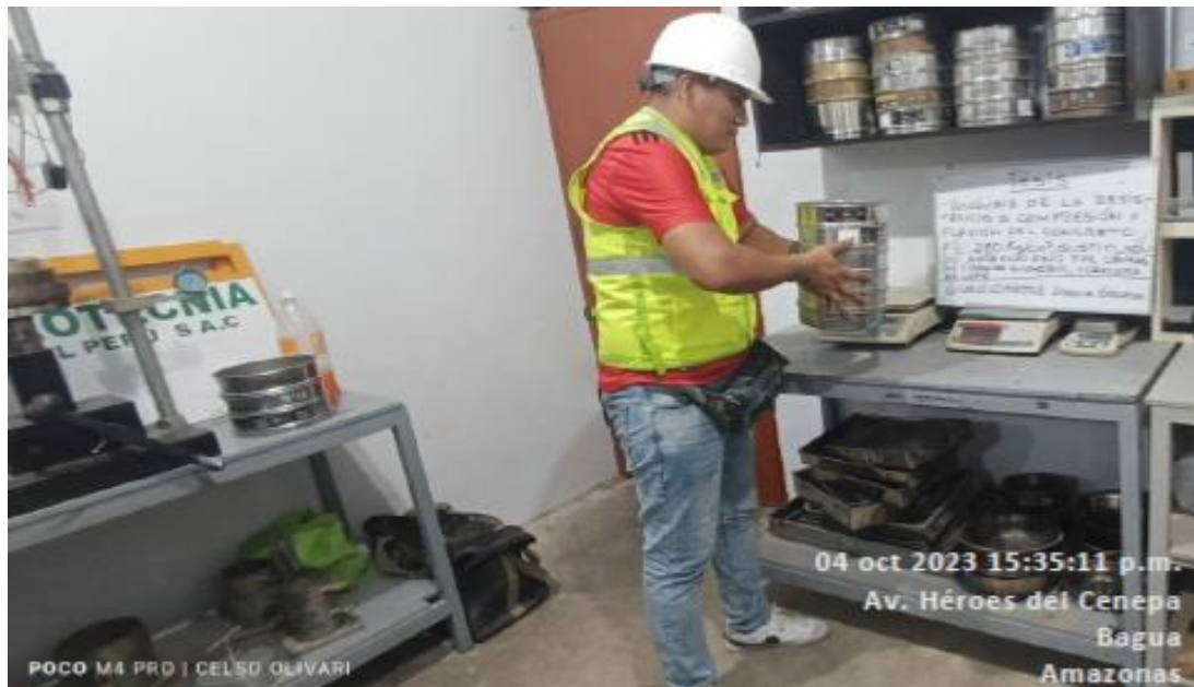
Figura 13. Granulometría de agregado fino – arena gruesa Fuente: elaboración propia
