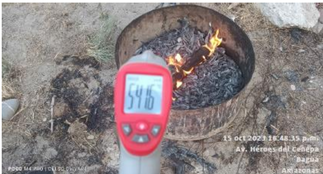
Figura 7. Obtención de las cenizas al quemarlas en batea de acero - temperatura de 541°C
