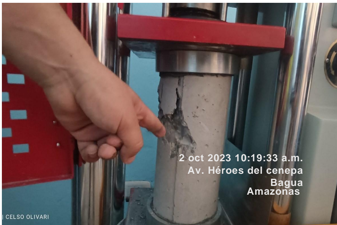
Figura 33. Ensayos de fuerza compresión
