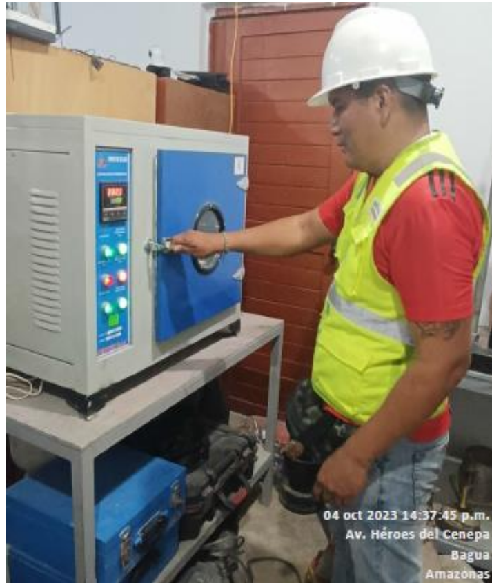
Figura 12. Contenido de humedad de los agregados Fuente: elaboración propia
