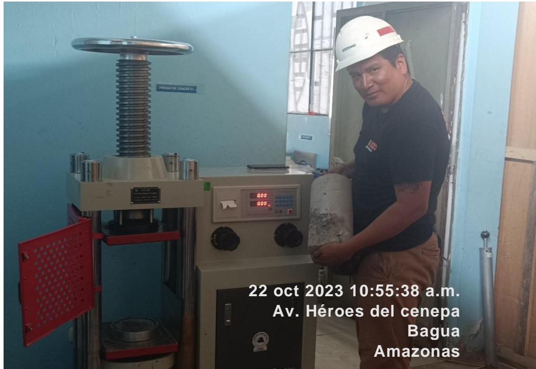
Figura 36. Rotura de testigos, ensayos de fuerza compresión Fuente: elaboración propia
