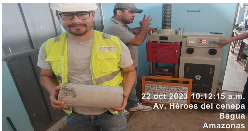
Rotura de testigos, ensayos de fuerza compresión Fuente: elaboración propia
