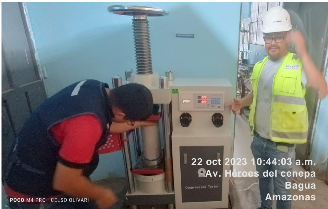
Figura 35. Ensayos de fuerza compresión, concreto con adición de cenizas Fuente: elaboración propia
