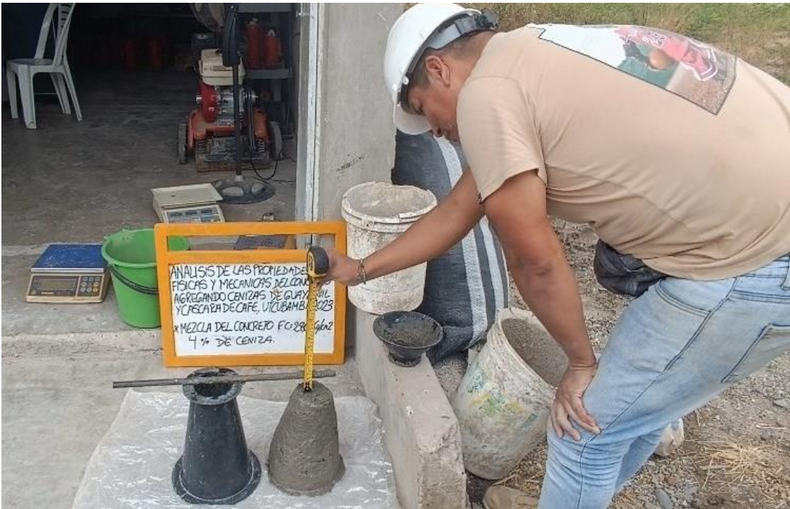
Figura 19. Ensayos de asentamiento (Slump) Fuente: elaboración propia
