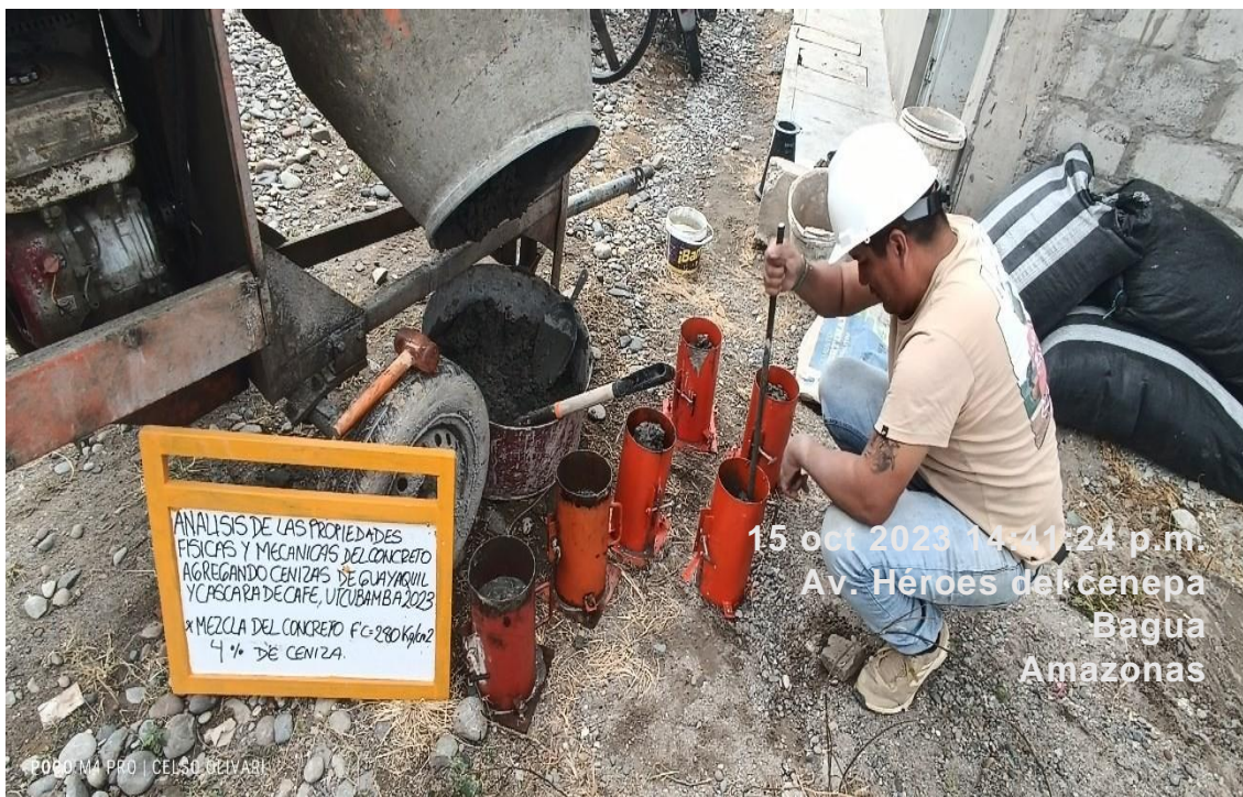
Figura 26. Elaboración de testigos de concreto con 4% de cenizas Fuente: elaboración propia
