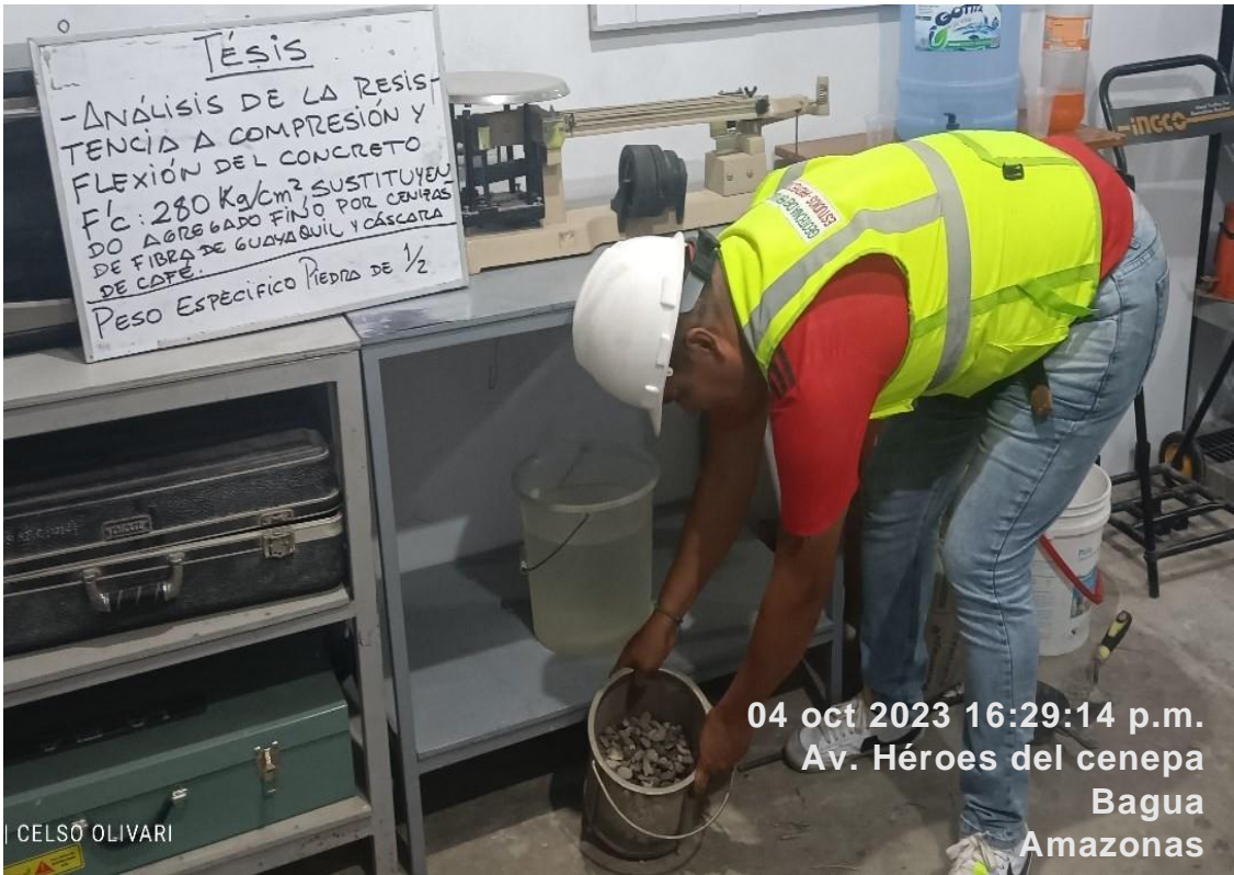
Figura 17. Peso específico de agregado grueso – piedra chancada de 1/2 Fuente: elaboración propia
