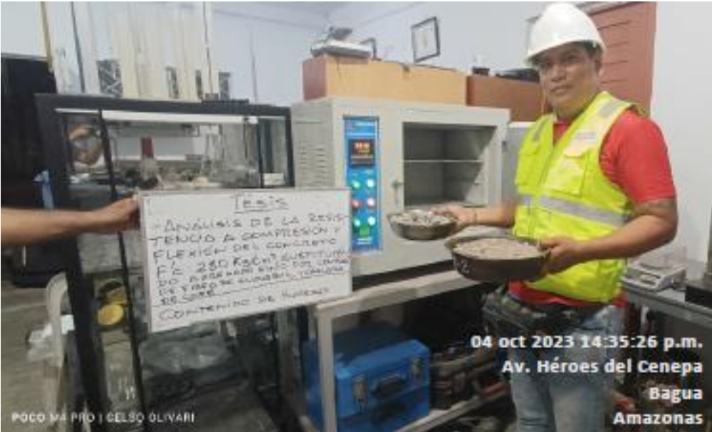
Figura 11. Ensayos físicos, contenido de humedad de los agregados
