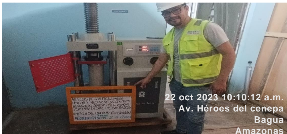
Figura 32. Ensayos de laboratorio - análisis de compresión Fuente: elaboración propia
