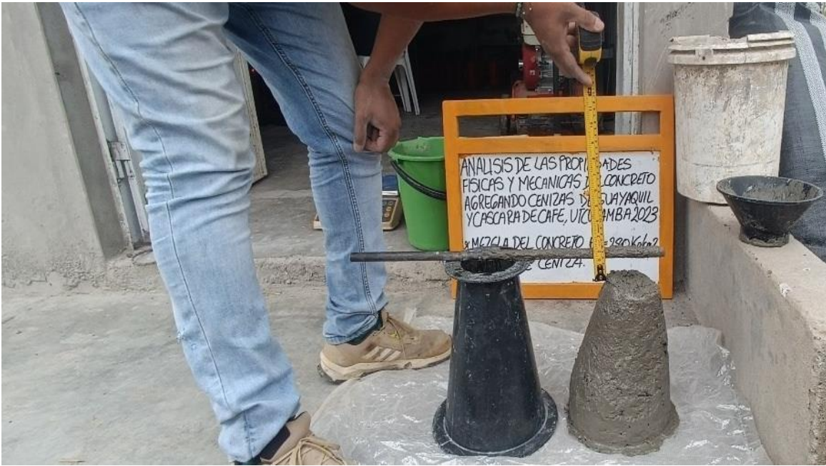
Figura 18. Ensayos de asentamiento (Slump) Fuente: elaboración propia
