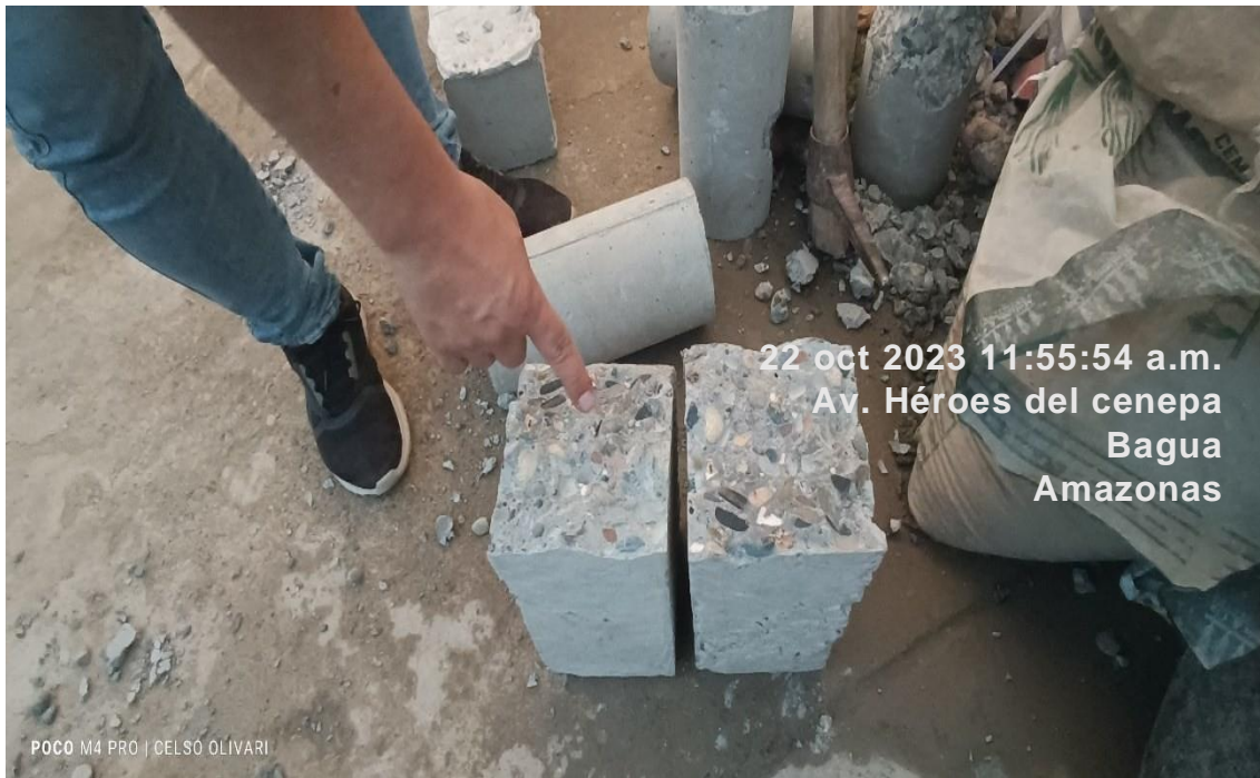
Figura 41. Fractura de testigos en el laboratorio
