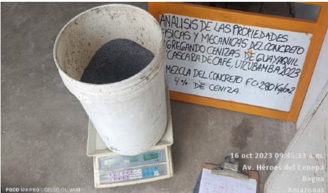
Figura 9. Pesado de cenizas para la elaboración de probetas
