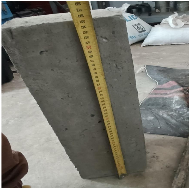
Figura 24. Testigo de concreto con 6% de cenizas Fuente: elaboración propia
