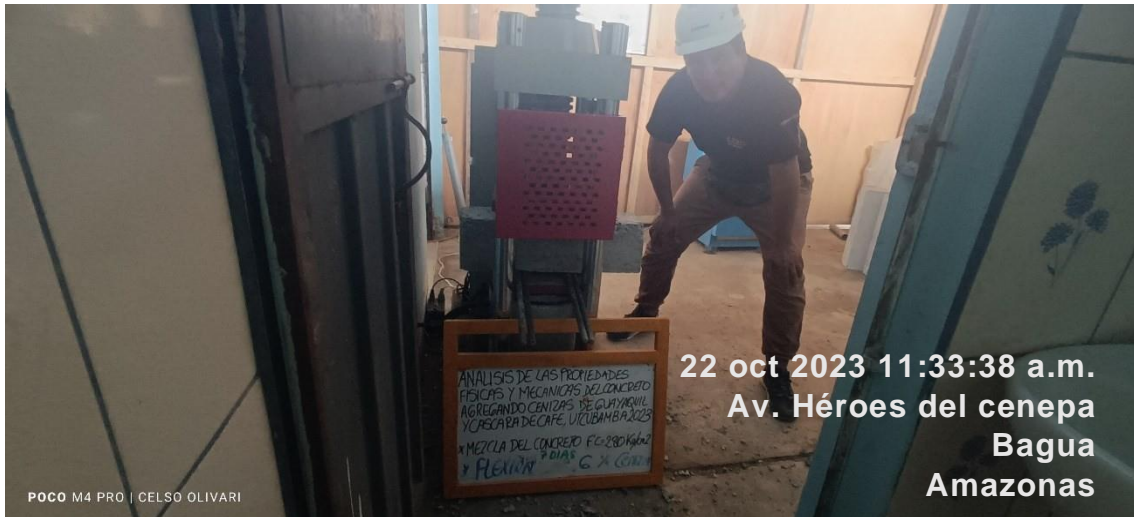
Figura 39. Sometimiento de testigos a los ensayos de resistencia a la flexión Fuente: elaboración propia
