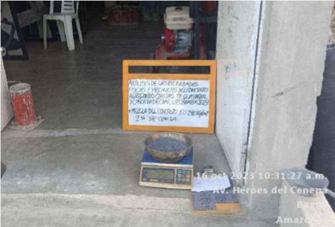
Figura 10. Pesado de cenizas para la elaboración de probetas
