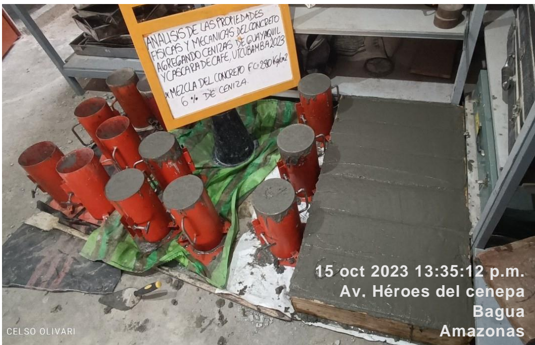
Figura 23. Concreto f'c=280 \text{ kg/cm}^2 con 6% de cenizas Fuente: elaboración propia
