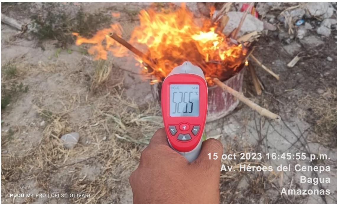
Figura 6. Obtención de las cenizas al quemarlas en batea de acero - temperatura de 525°C
