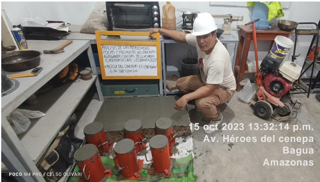
Figura 22. Elaboración de vigas y probetas
