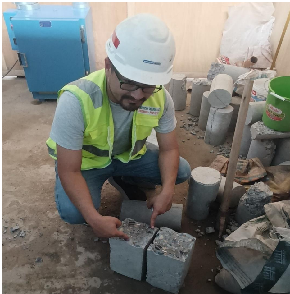
Figura 39. Sometimiento de testigos a los ensayos de resistencia a la flexión Fuente: elaboración propia
