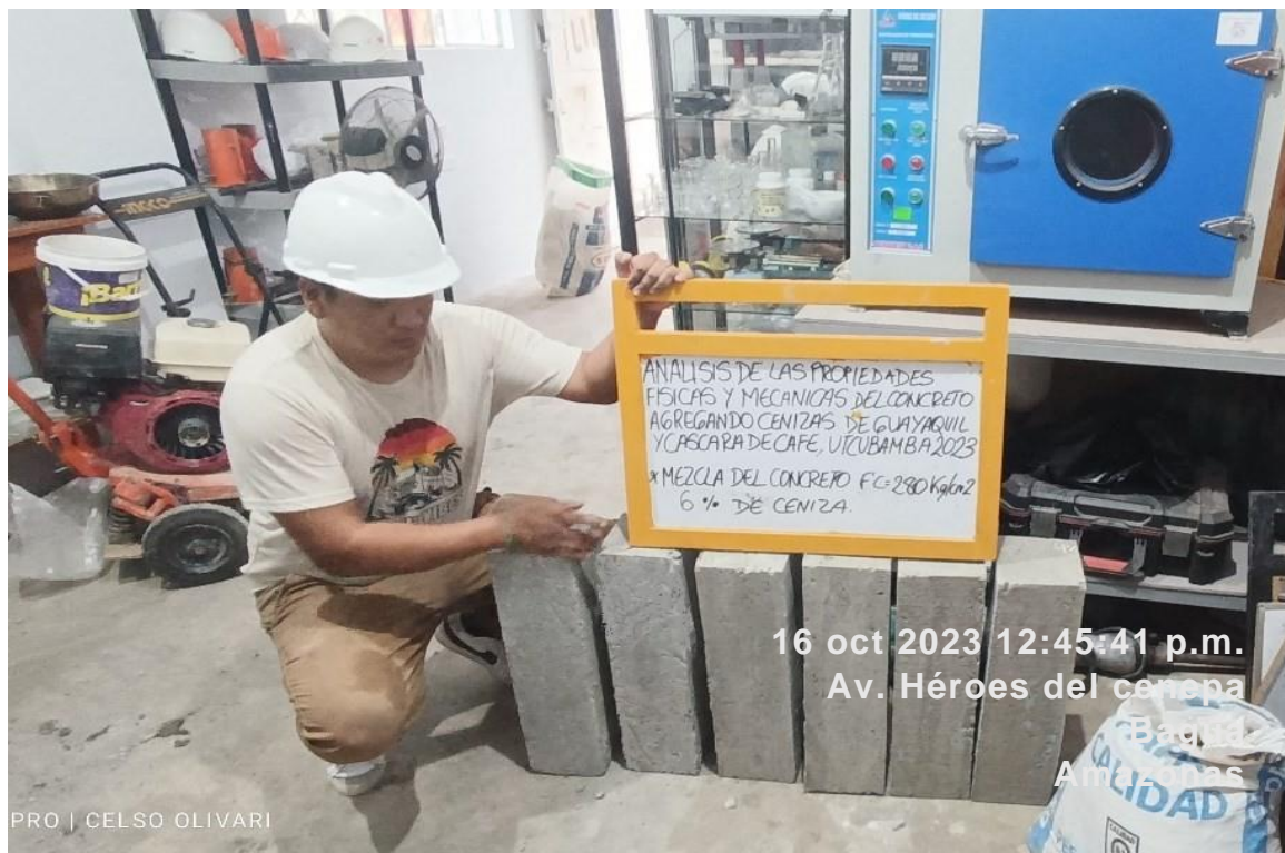
Figura 25. Testigos para rotura em ensayos de laboratorio Fuente: elaboración propia
