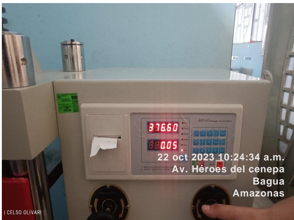
Figura 34. Obtención de datos de los ensayos de fuerza compresión
