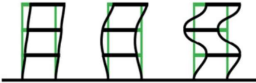
Figura 1: modos de vibración de la estructura.
