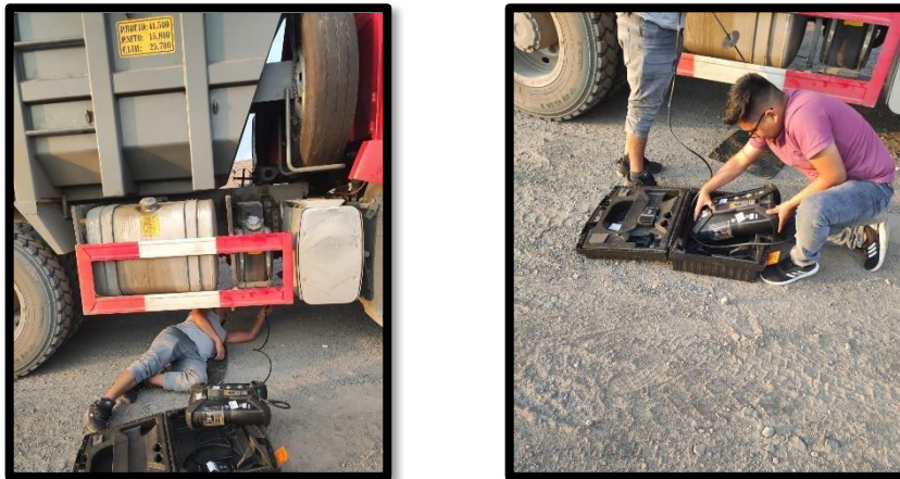
Figura 10. Primera medición de gases del vehículo
