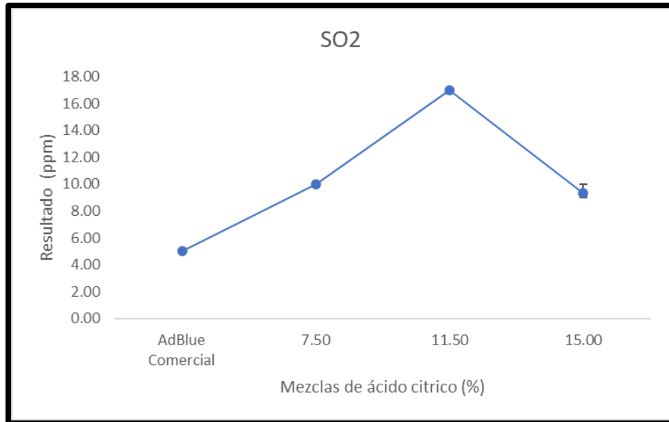
Figura 23. Resultado de las mezclas de ácido cítrico en el parámetro SO 2
