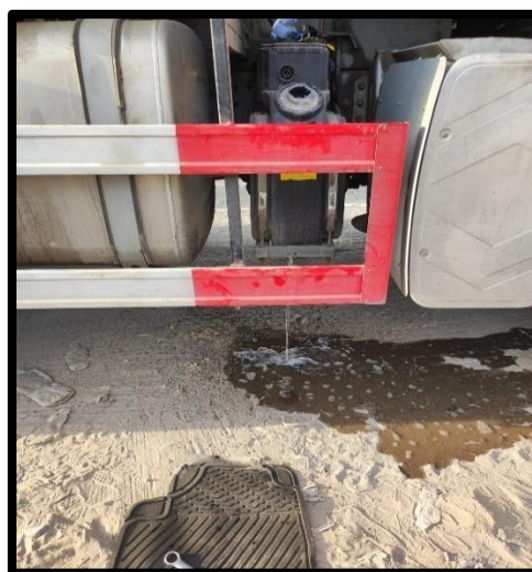
Figura 11. Drenado de tanque de Adblue
