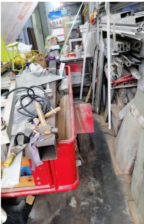
Figura 21. Inadecuada ubicación de materiales y herramientas
