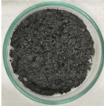
**FIGURA N°1.** Muestra de cenizas de paja de trigo
