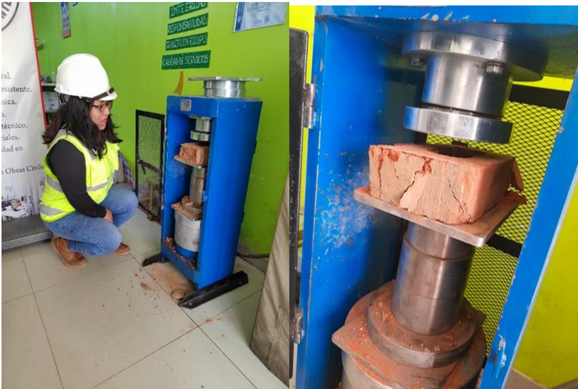
En el ensayo de compresión empleado a cada una de las muestras de los ladrillos artesanales.
