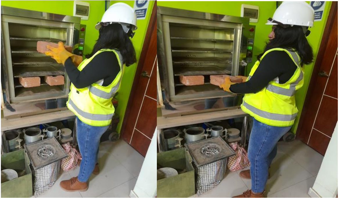
Sacando las muestras del horno para pasar al ensayo de Absorción
