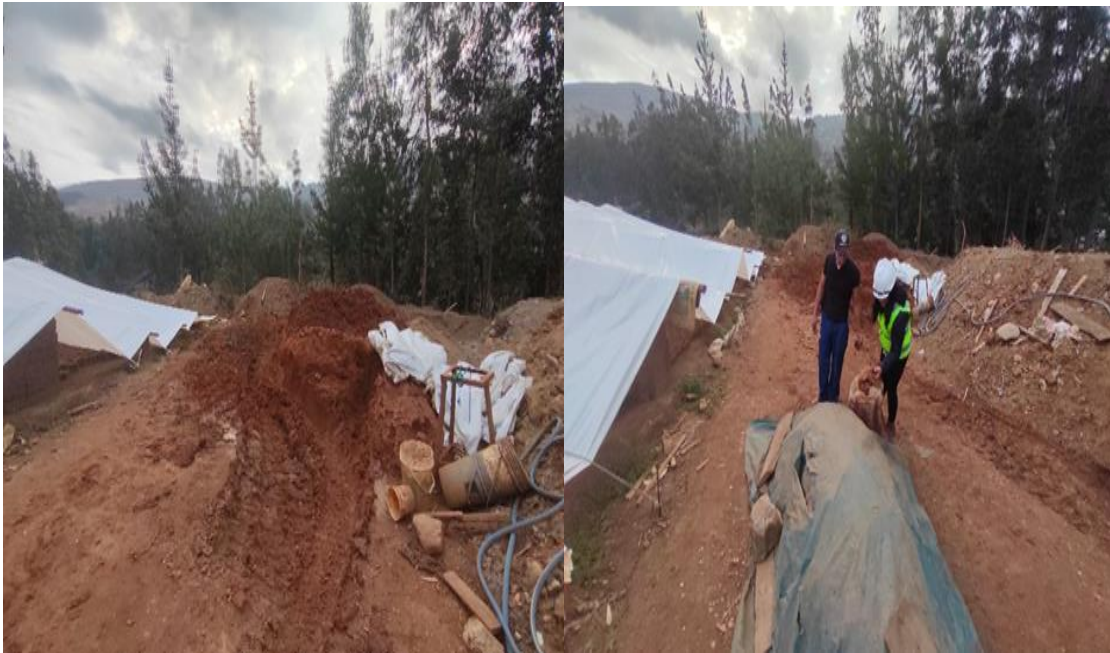
LOS MATERIALES PARA LA ELABORACION DE LOS LADRILLOS ARTESANALES: ARCILLA, BETA, BIRUTA Y AGUA.
