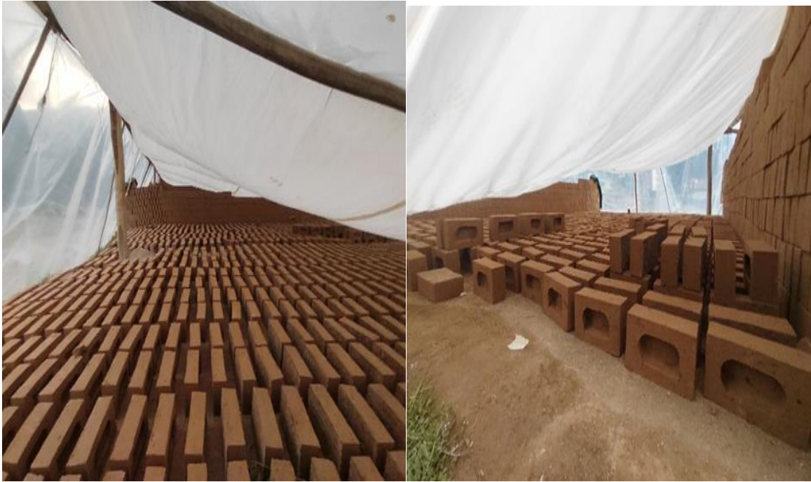
MOLDEADO Y SECADO DE LOS LADRILLOS
