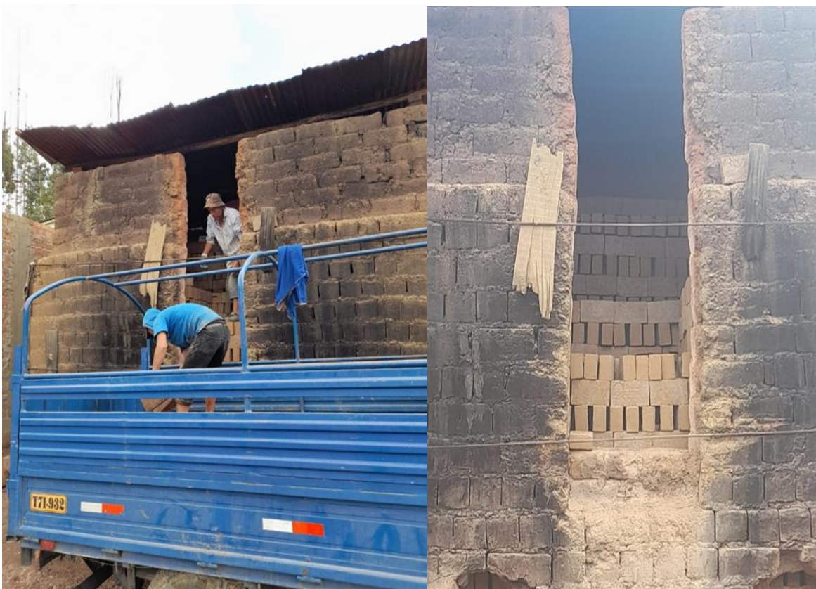
COLOCACION DE LOS LADRILLOS PARA SU COCCIÓN POR 36 HORAS
