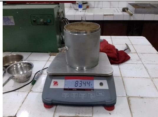
Se compacta en 5 capas y 25 golpes a la segunda muestra y se pesa el suelo compactado
