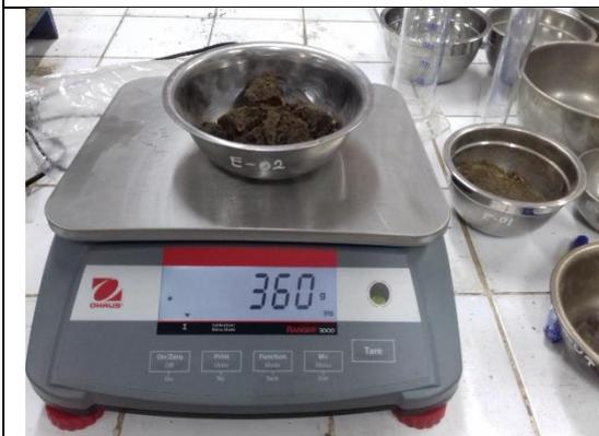
Se toma una pequeña muestra para determinar el contenido de humedad de la segunda muestra compactada
