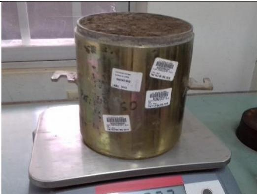
Se compacta en 5 capas y 56 golpes a la primera muestra, 5 capas y 25 golpes a la segunda muestra, 5 capas
