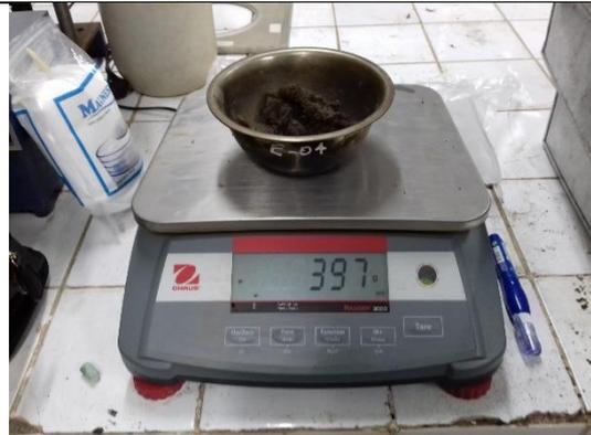
Se toma una pequeña muestra para determinar el contenido de humedad de la cuarta muestra compactada.
