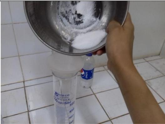
Se mezcla el agua con el cloruro de magnesio
