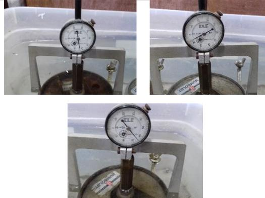
Una vez compactado todo, se procede a sumergir los moldes con el suelo compactado en agua para saturarlas durante 4 días.
