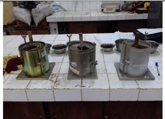
Se preparan los moldes para ser suemrgidas en agua para saturarlas
