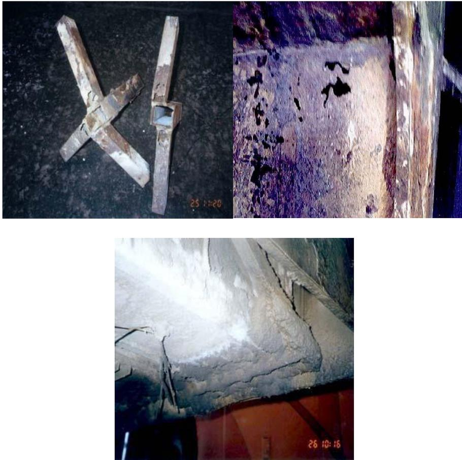
Deterioro de vehículos al estar en contacto con caminos estabilizados con cloruro de magnesio.
