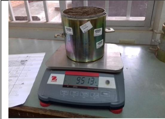
Se compacta en 5 capas y 56 golpes a la primera muestra y se pesa el suelo compactado
