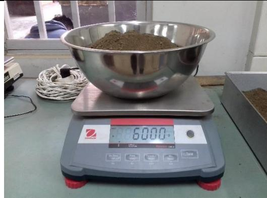
Se seleccionan 3 muestras de 6 kilos cada una. A las cuales se las llevo al optimo contenido de humedad obtenido en el ensayo de proctor.
