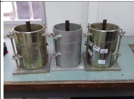
Se preparan los moldes para ser suemrgidas en agua para saturarlas
