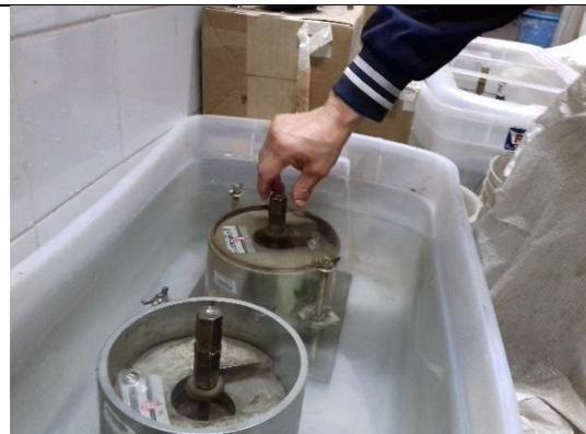
Una vez compactado todo, se procede a sumergir los moldes con el suelo compactado en agua para saturarlas durante 4 dias.
