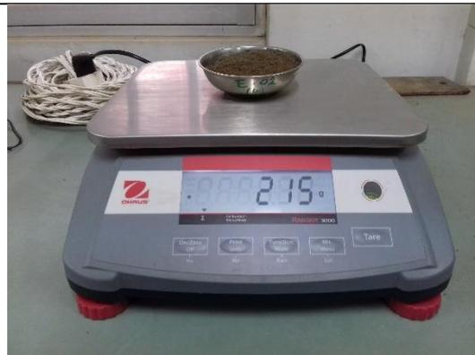
Se toman muestras para verificar el contenido de humedad y se las seca en el horno por 24 horas.
