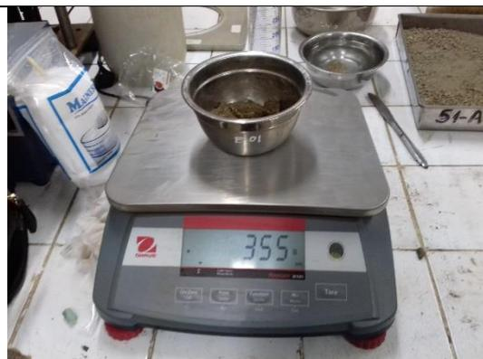
Se toma una pequeña muestra para determinar el contenido de humedad de la primera muestra compactada.
