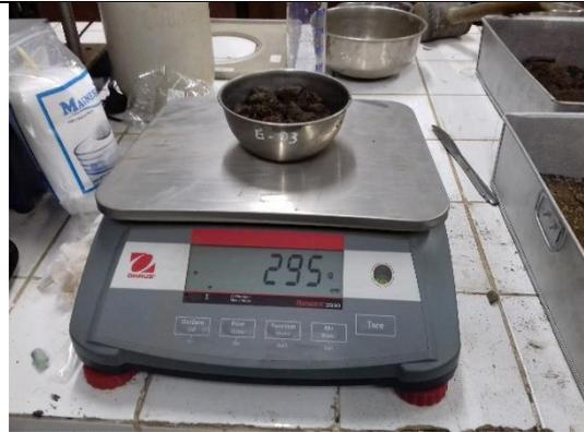
Se toma una pequeña muestra para determinar el contenido de humedad de la tercera muestra compactada.
