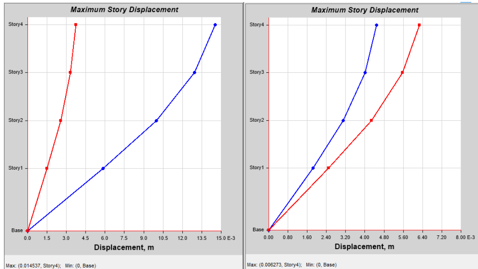
Figura 29. Desplazamiento de la estructura en unidad metros en dirección X-X e Y-Y, respectivamente.
