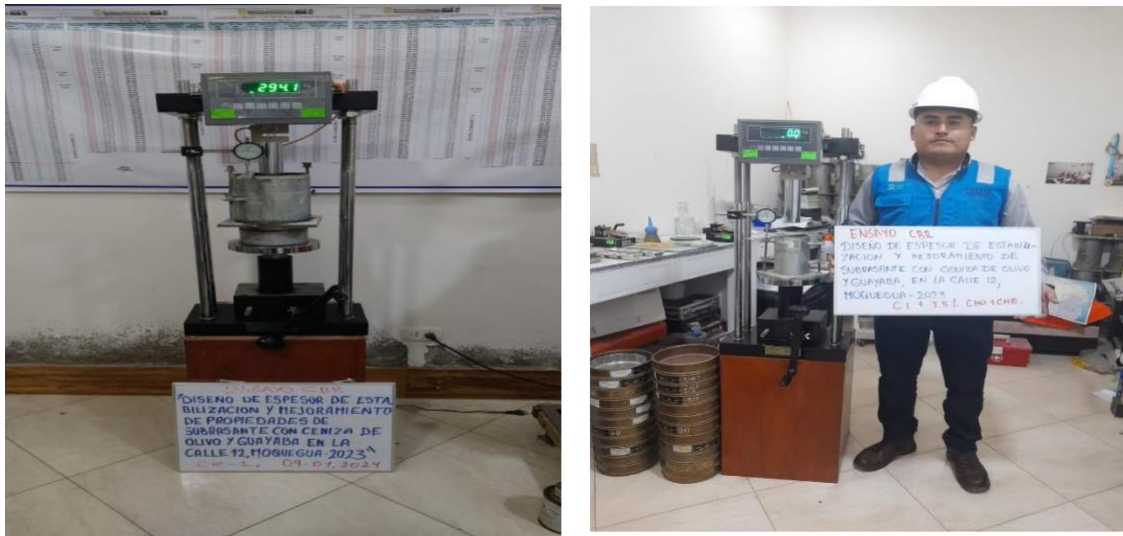
Figura 44. Ensayo CBR para C-1 C-2 C-3 con sus respectivas adiciones de CHO + CHG
