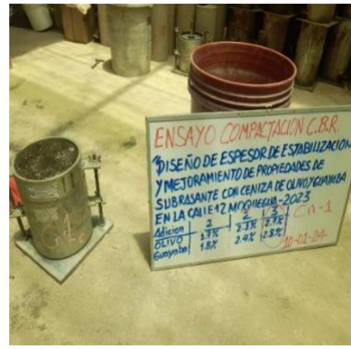
Figura 8. Reposo de muestra compactada a 56 golpes en cilindro por periodo de 72 horas
