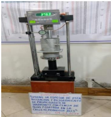
Figura 10. Ensayo de CBR Patrón de la calicata C-1 C-2 C-3
