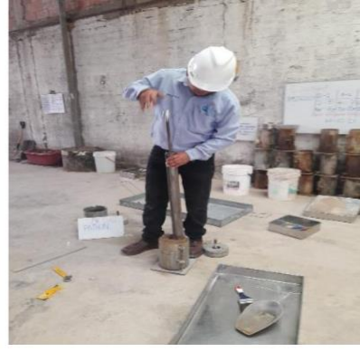
Figura 8. Ensayo de compactación CBR para muestra patrón y adiciones al 3.5% ,4.5%,5.5%
