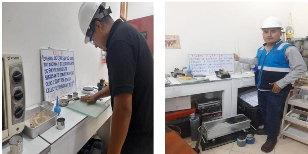
Figura 42. Ensayo de Límites de Límites de Atterberg de C1, C-2, C-3 con sus respectivas adiciones de CHO y CHG
