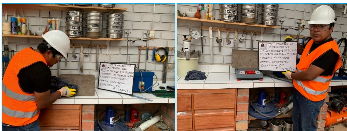
Figura 33. Ensayo absorción en bloques con adiciones: D1, D2, D3, D4. Fuente: Elaboración Propia.
