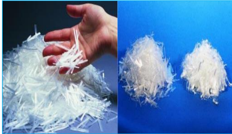
Figura 3. Fibras de polipropileno. Fuente: (KOSMATKA, y otros, 2004, pág. 157)
