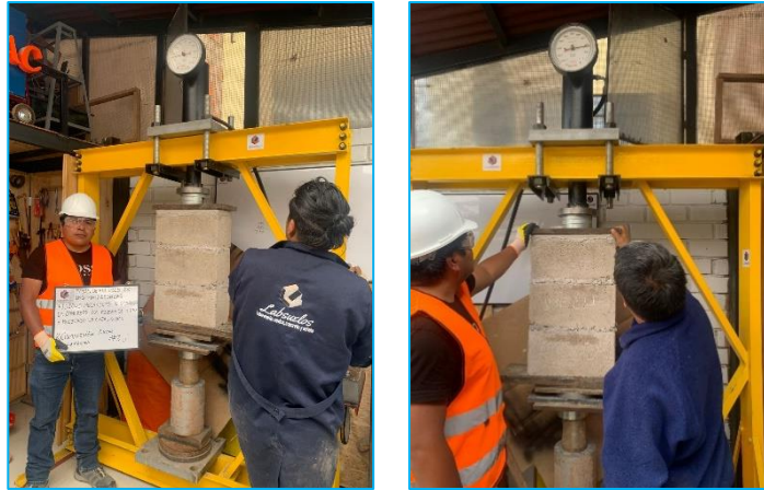
Figura 41. Rc axial de pilas en bloques con adiciones: D1, D2, D3, D4. Fuente: Creación Propia.
