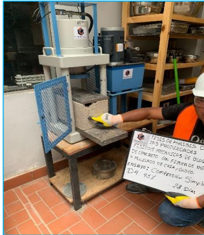
Figura 39. Rc axial en bloques con adiciones: D1, D2, D3, D4, a los 28 días Fuente: Creación Propia.
