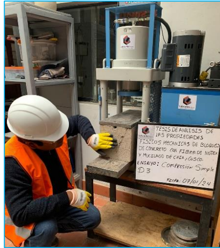
Figura 37. Rc axial en bloques con adiciones: D1, D2, D3, D4, a los 14 días Fuente: Creación Propia.
