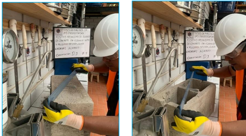
Figura 29. Ensayo alabeo en bloques con adiciones: D1, D2, D3, D4. Fuente: Elaboración Propia.
