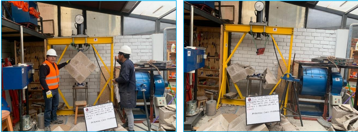
Figura 43. Rc diagonal de muretes en bloques con adiciones: D1, D2, D3, D4. Fuente: Elaboración Propia.
