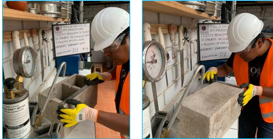
Figura 27. Ensayo VD en bloques con adiciones: D1, D2, D3, D4. Fuente: Elaboración Propia
