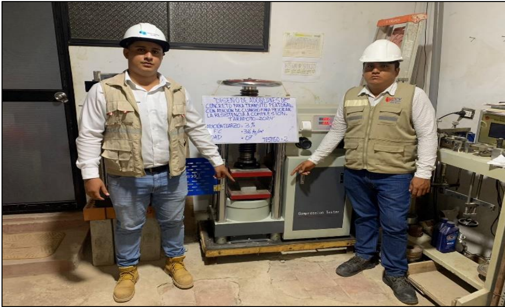
Anexo 39: Fortaleza a compactación del testigo N°2 con inclusión de cuarzo al 3% obteniendo un f_c 218.74 kg/ cm 2
