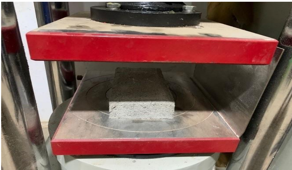
Anexo 56: falla eterna que se presentó en la parte media seccionaría del adoquín con la incorporación del 2% de cuarzo \text{kg/cm}^2
