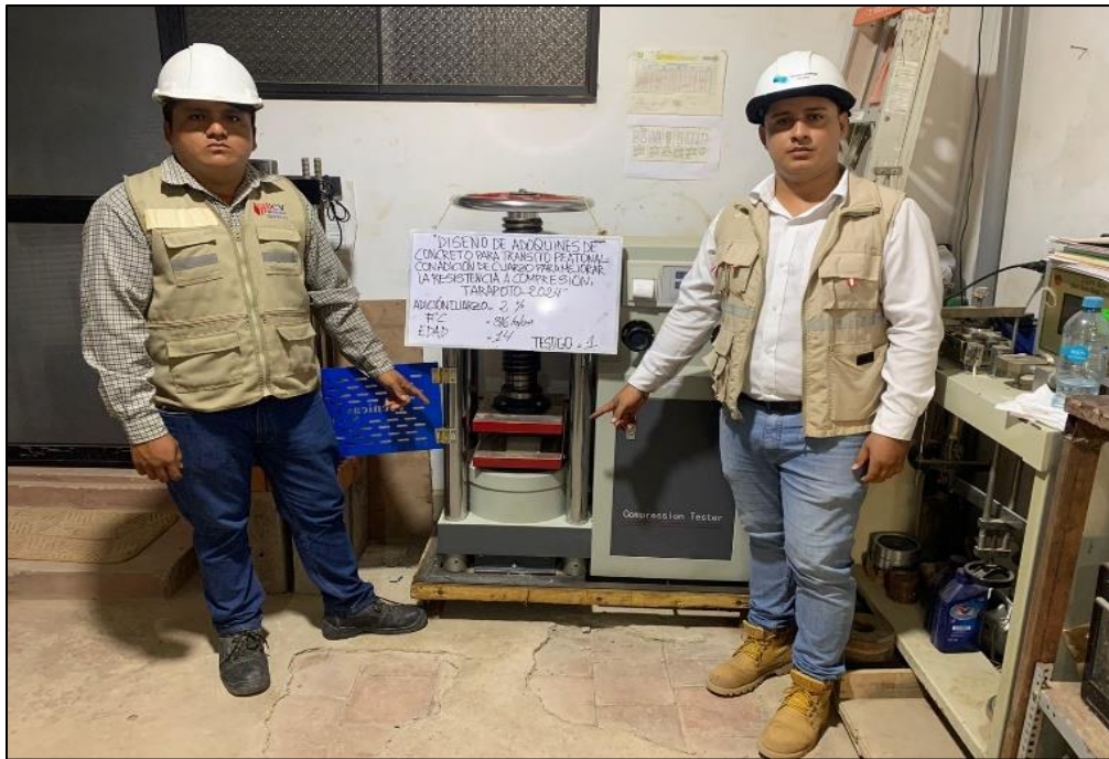
Anexo 47: Fortaleza a compactación del testigo N°1 con inclusión de cuarzo al 2% obteniendo un f_c 211.87 kg/cm 2
