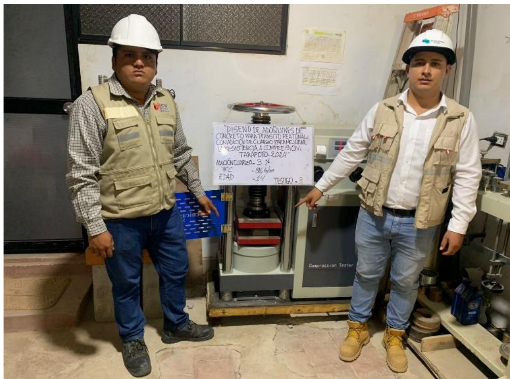
Anexo 52: Fortaleza a compactación del testigo N°3 con inclusión de cuarzo al 3% obteniendo un f_c 330.56 kg/cm 2
