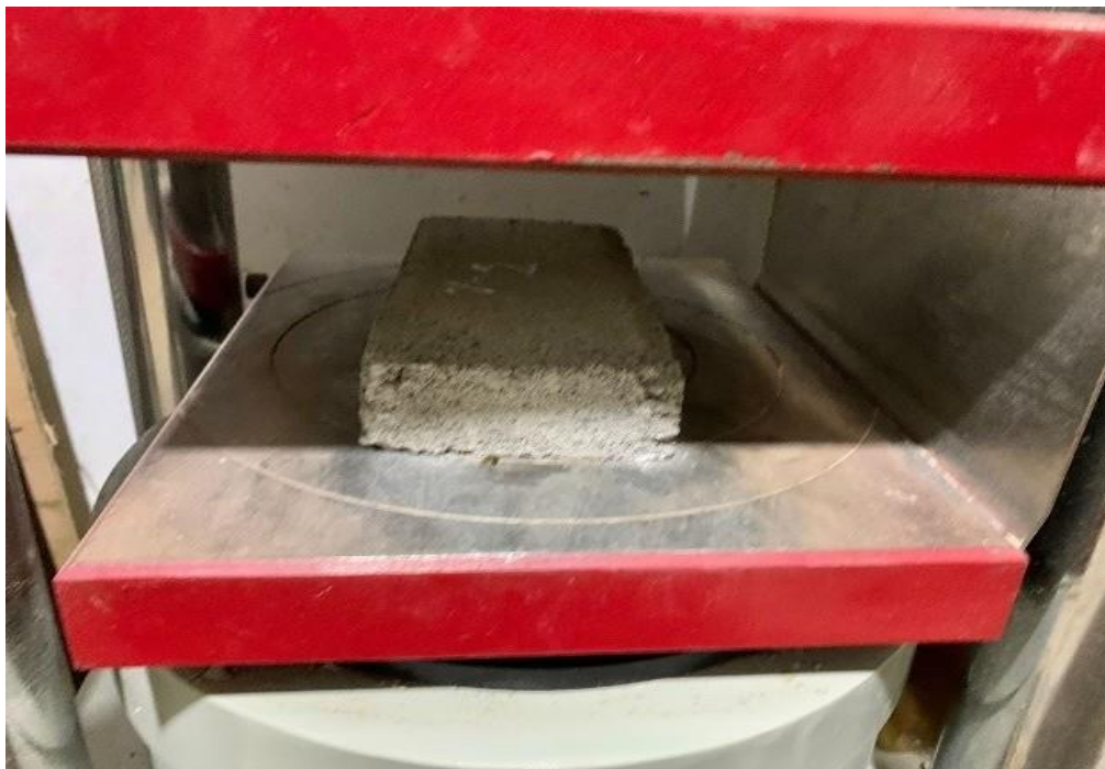
Anexo 58: Fortaleza a compactación del adoquín de hormigón lo que presento falla Interna con incorporación del 1% kg/cm 2
