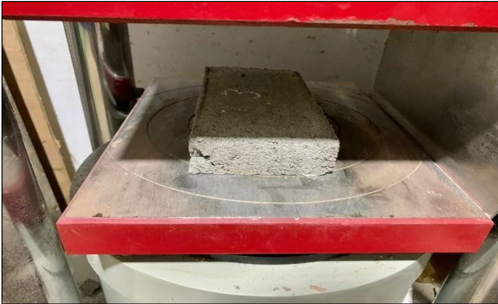
Anexo 55: Fisura externa presentada en la parte de la esquina izquierda inferior del adoquín con el 3% de cuarzo.
