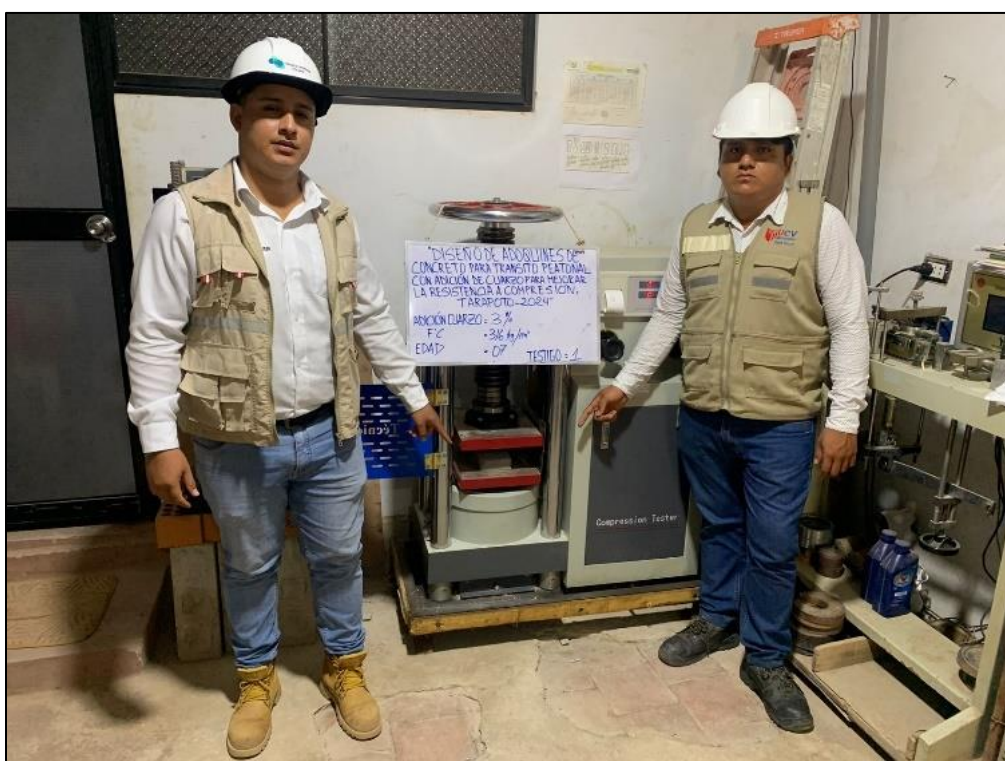
Anexo 38: Fortaleza a compactación del testigo N°1 con inclusión de cuarzo al 3% obteniendo un f_c 156.20 kg/ cm2
