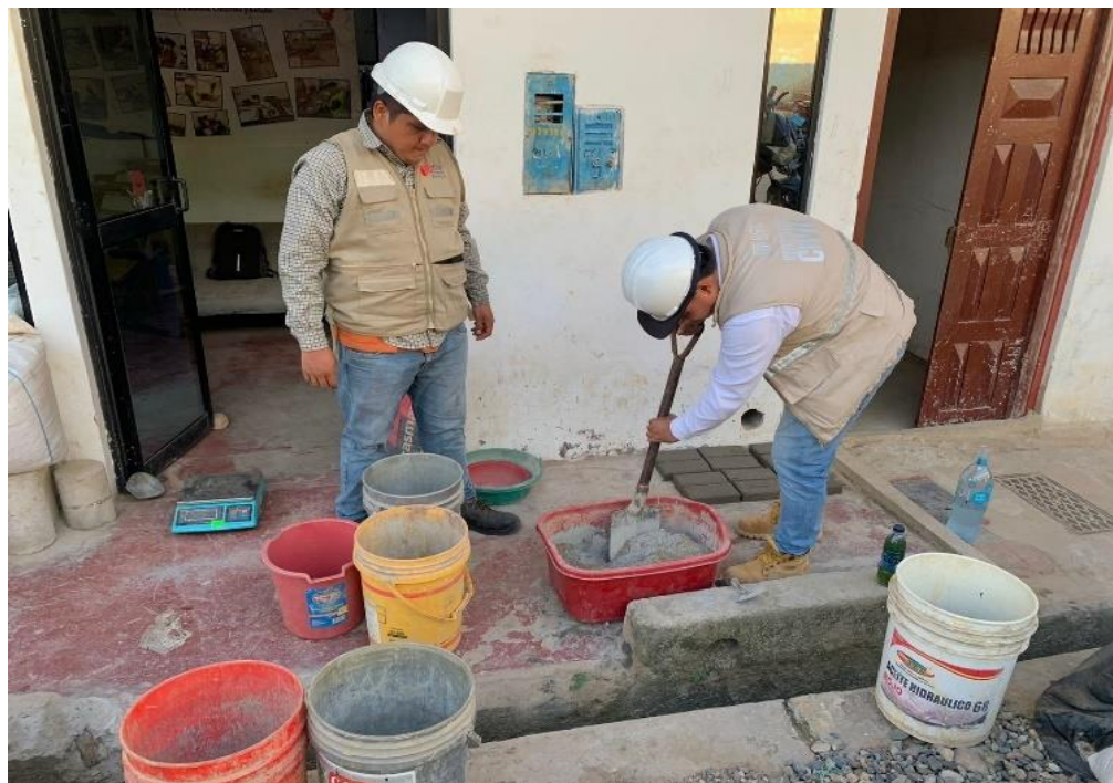
Anexo 22: La dosificación de mezcla con aditivo es el proceso de calcular y combinar de manera precisa los materiales base con aditivos específicos para mejorar las propiedades del mortero, como la fortaleza, trabajabilidad o durabilidad. Así mismo en la imagen se muestra la dosificación de mezcla con cuarzo al 3 % con utilización de arena gruesa, arena triturada, cemento y agua.
