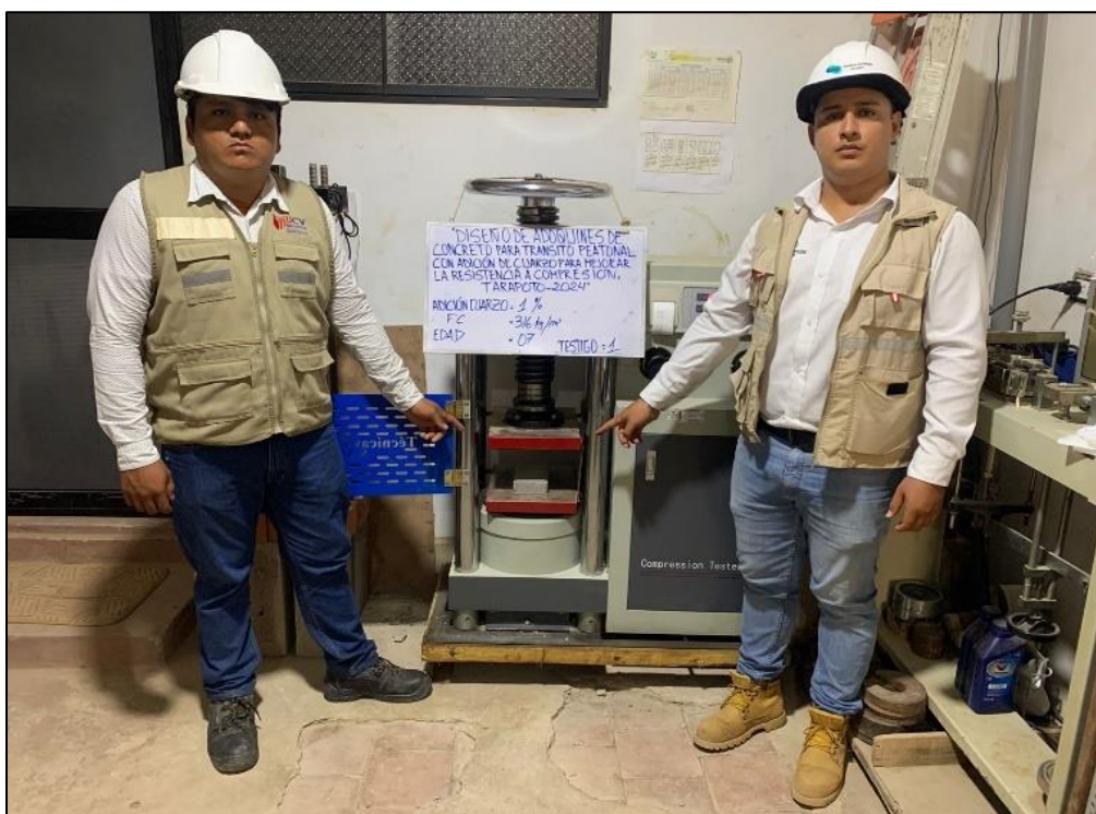
Anexo 32: La fortaleza a compactación del testigo N°1, donde se utilizó una mezcla de hormigón con la incorporación de cuarzo al 1%, ha sido medida y el resultado obtenido es de 153.07 kg/cm 2 . Este valor representa la capacidad del mortero para resistir fuerzas de compresión antes de romperse.
