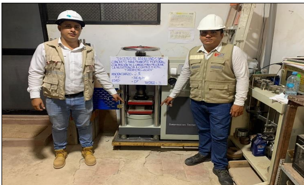
Anexo 37: Fortaleza a compactación del testigo N°3 con inclusión de cuarzo al 2% obteniendo un f_c 325.07kg/ cm2
