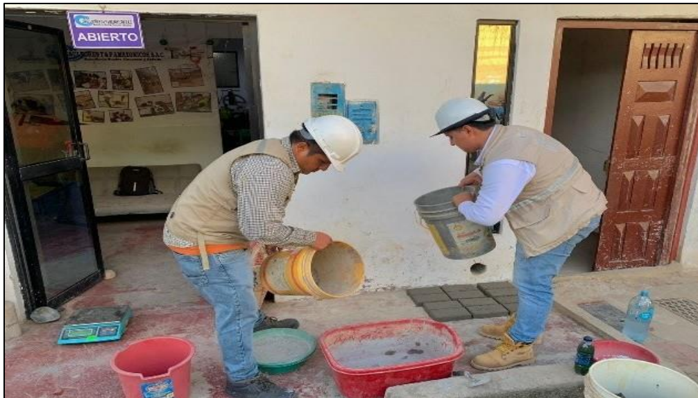
Anexo 21: Dosificación de mezcla con cuarzo al 2 % con utilización de arena gruesa, arena triturada, cemento y agua.
