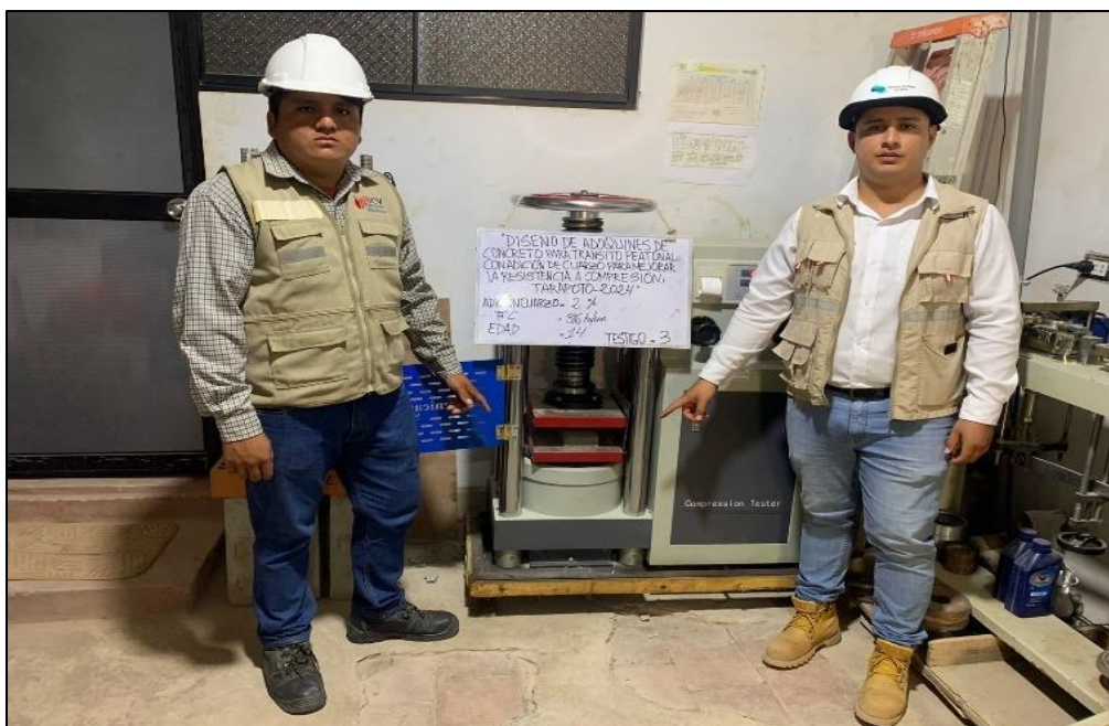
Anexo 49: Fortaleza a compactación del testigo N°3 con inclusión de cuarzo al 2% obteniendo un f_c 371.31 kg/cm 2
