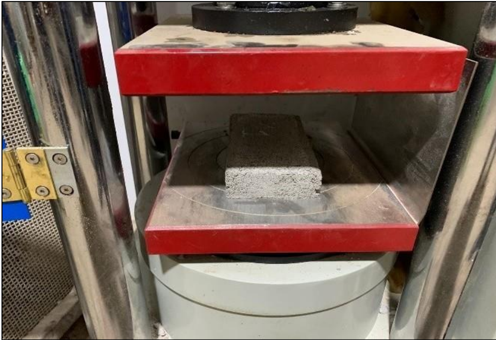
Anexo 57: Fisura interna presentada en el adoquín de hormigón con inclusión de cuarzo al 1%
