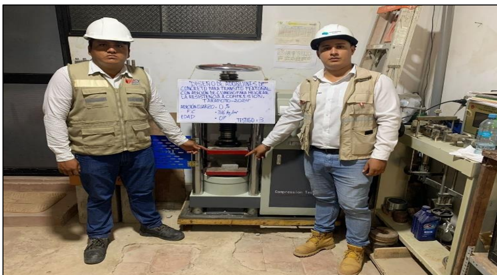
Anexo 31: La fortaleza a compactación del testigo N°3, empleando una mezcla convencional sin la incorporación de cuarzo (0.0%), ha sido medida y el resultado obtenido es de 242 kg/cm 2 .
