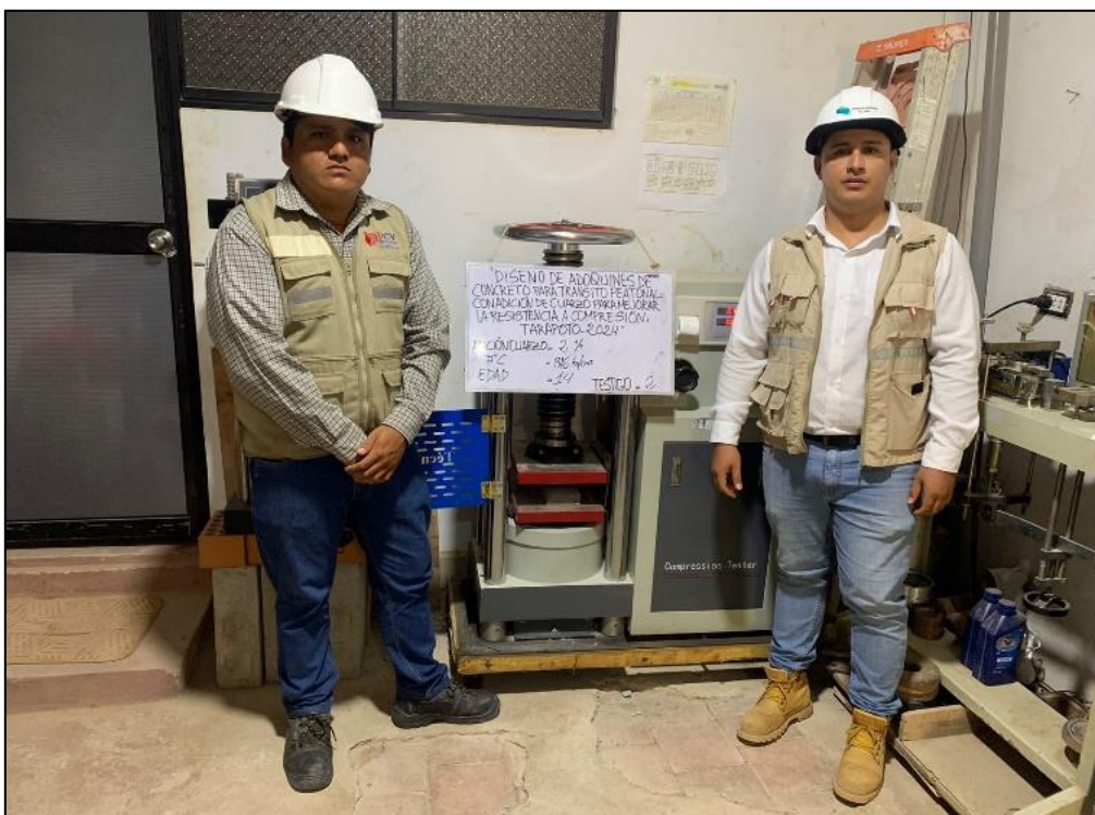
Anexo 48: Fortaleza a compactación del testigo N°2 con inclusión de cuarzo al 2% obteniendo un f_c 284.57 kg/cm 2
