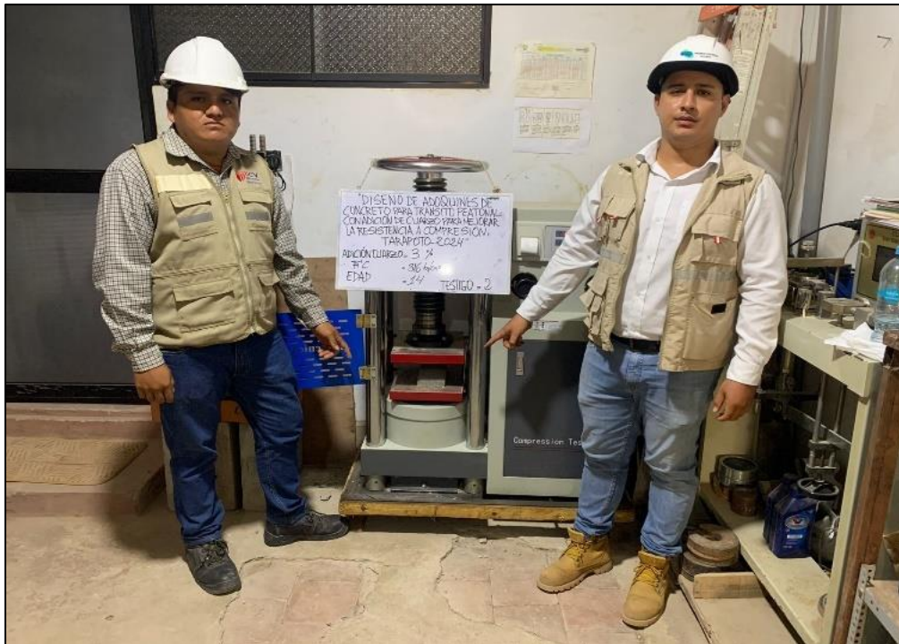
Anexo 51: Fortaleza a compactación del testigo N°2 con inclusión de cuarzo al 3% obteniendo un f_c 252.30 kg/cm 2
