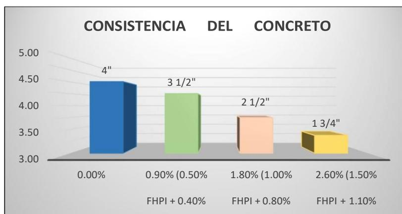
Figura 36. Consistencia del concreto - antecedente
