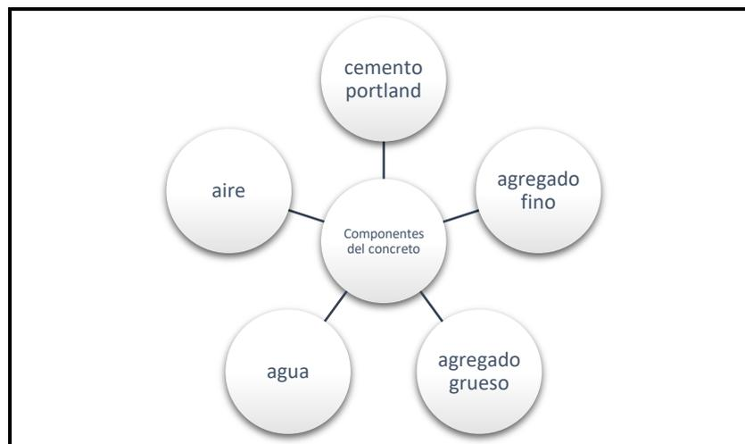
Figura 5. Composición del concreto
