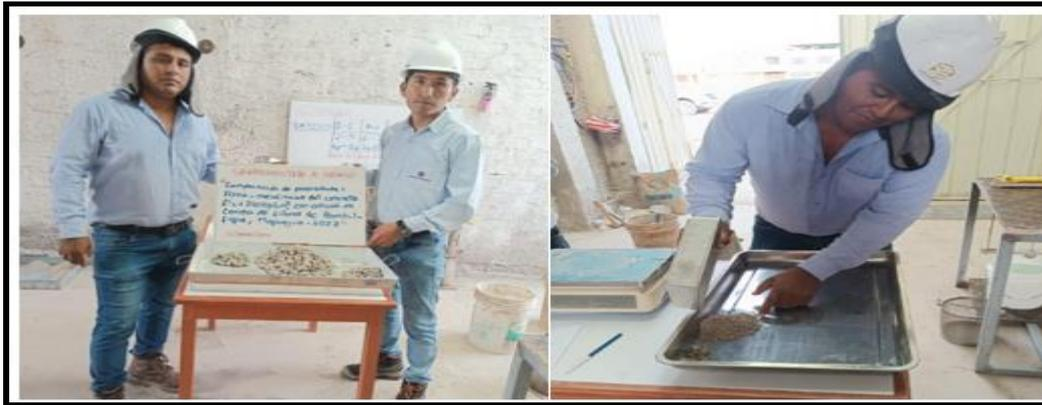
Figura 14. Análisis granulométricos del agregado gruesos y finos
