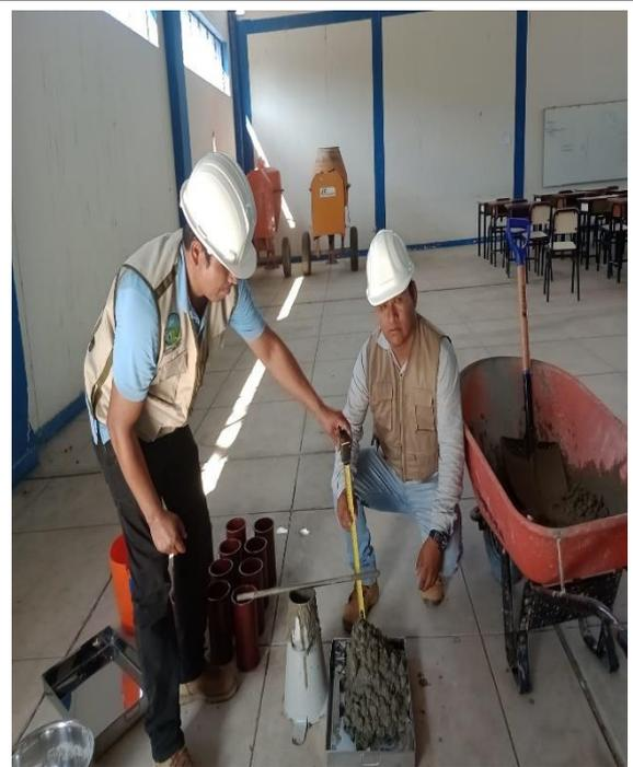
**Ensayo de revenimiento para determinar la trabajabilidad del concreto
