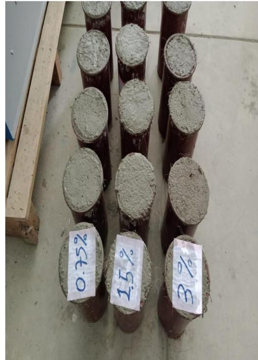
**Elaboración de probetas de concreto (NTP 339.033)**
