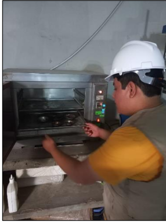
Secado de las muestras al horno Fuente: Elaboración propia (2024)
