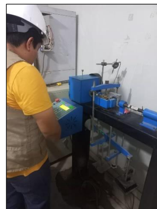
Ensayo de corte directo según las muestras de la investigación
