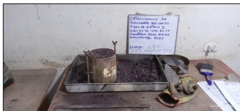
Ensayo de CBR Fuente: Elaboración propia (2024)
