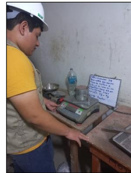
Realización ensayo Proctor modificado Fuente: Elaboración propia (2024)
