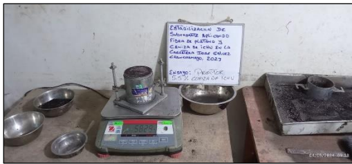
Ensayo de Proctor modificado Fuente: Elaboración propia (2024)
