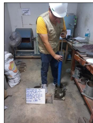
Proceso para el ensayo de CBR Fuente: Elaboración propia (2024)
