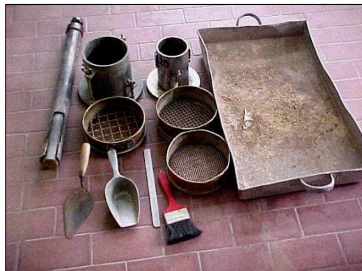
Figura 2. Materiales para la prueba de Proctor Modificado
