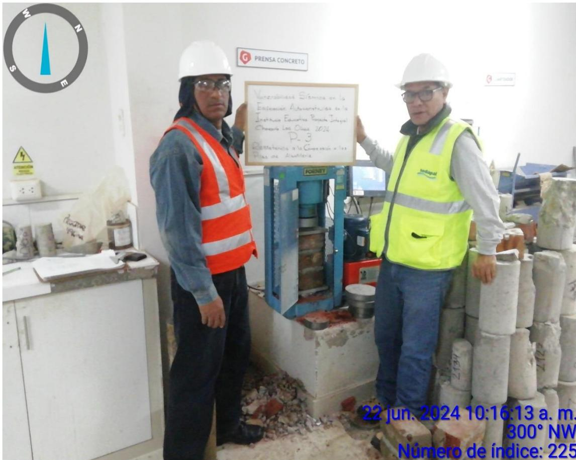
P-3: Resistencia a la Compresión de la Pila 3 de Albañilería
