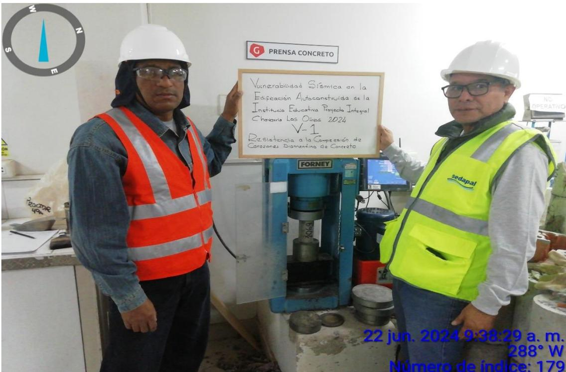
Vigas V-1: Resistencia a la Compresión De Corazones Diamantinos de Concreto
