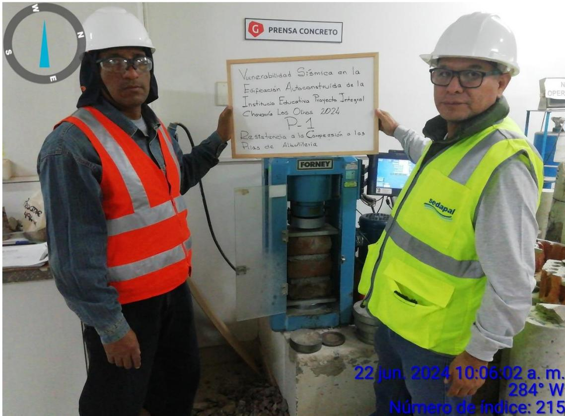
P-1: Resistencia a la Compresión de la Pila 1 de Albañilería
