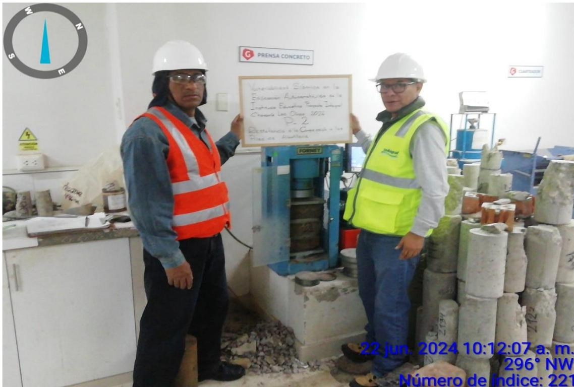
P-2: Resistencia a la Compresión de la Pila 2 de Albañilería
