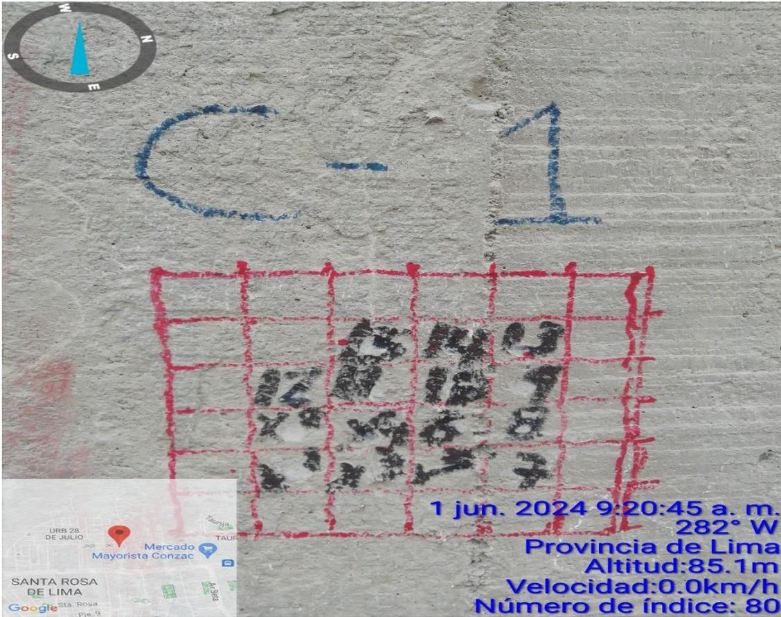
Prueba de Esclerometría Columna C-1
