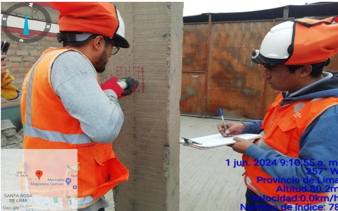
Prueba de Esclerometría Columna C-1
