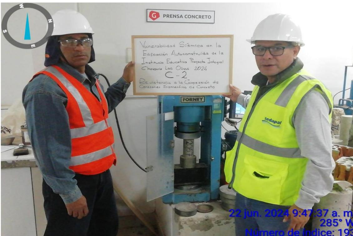
Columna C-2: Resistencia a la Compresión De Corazones Diamantinos de Concreto (testigos)
