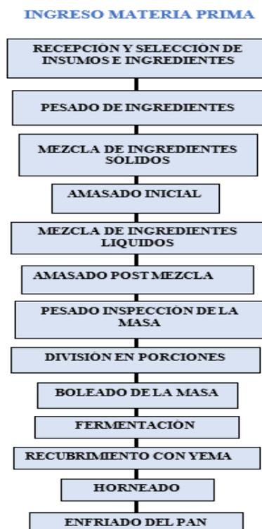
Figura 5. Diagrama de bloques del nuevo procedimiento.
