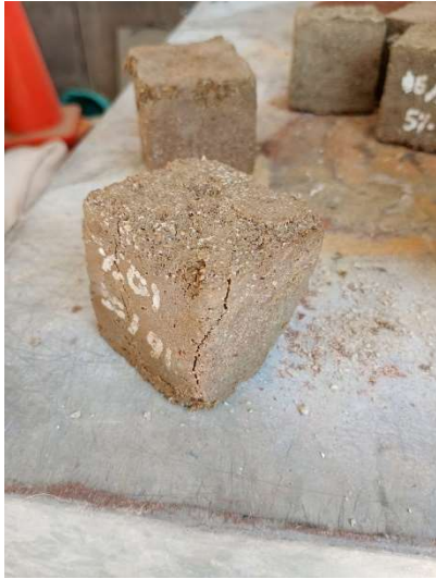
Figura 52, Rotura de probeta M10% de 14 dias.
