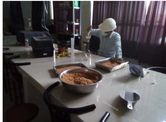
Figura 37, Ensayo de peso específico – Aserrin.
