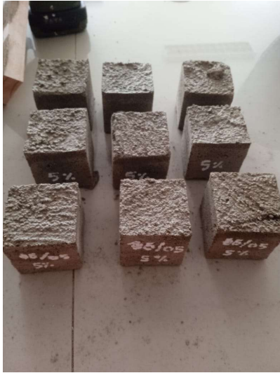
Figura 40, Desencofrado de probetas mortero con 5% de aserrín.
