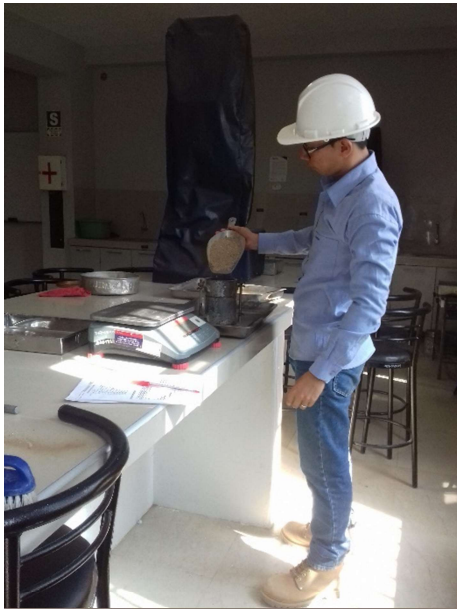
Figura 20, Ensayo de peso unitario suelto – Arena gruesa.
