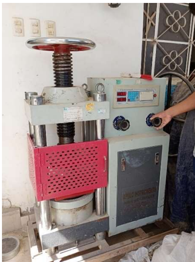
Figura 46, Ensayo de rotura de probetas.
