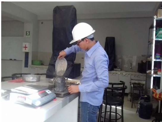
Figura 22, Ensayo peso unitario compactado – Arena gruesa.
