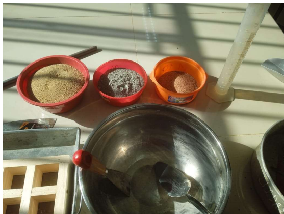
Figura 38, Preparación de agregados y material para probetas.
