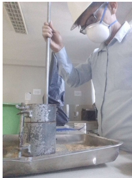
Figura 33, Proceso de compactación para ensayo de peso unitario
