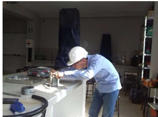
Figura 19, Toma de diámetro de molde.
