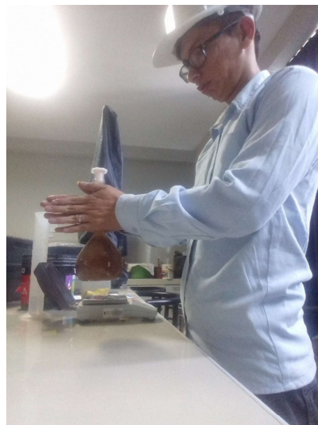
Figura 35, Proceso de ensayo de peso específico.
