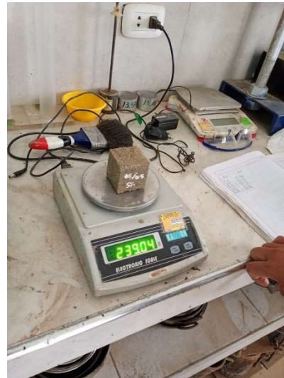
Figura 45, Toma de peso de probeta para rotura.
