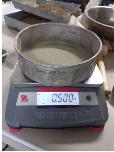
Figura 13, Muestra para ensayo de granulometría.
