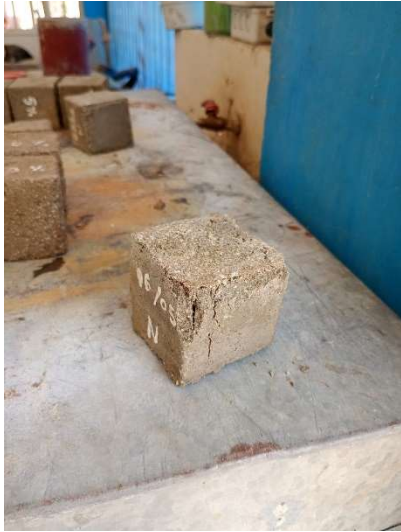
Figura 48, Rotura de probeta M de 14 días.
