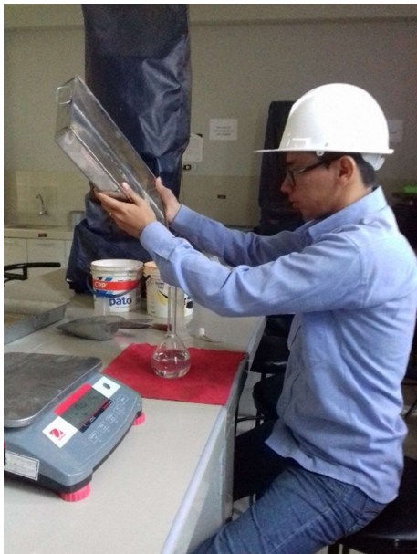
Figura 26, Introduccion de muestra para ensayo de peso específico.
