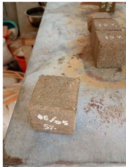
Figura 51, Rotura de probeta M5% de 28 días.
