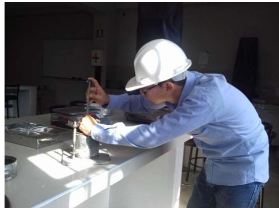
Figura 17, Toma de altura de molde.
