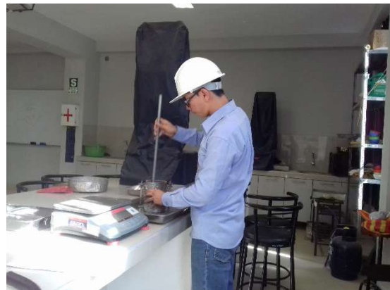
Figura 23, Proceso de compactación para ensayo de peso unitario.
