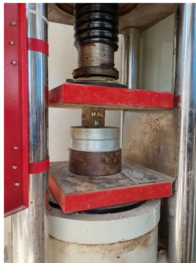
Figura 47, Ensayo de rotura de probetas a los 7 días.
