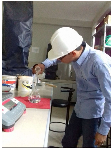
Figura 25, Proceso para ensayo peso específico – Arena.
