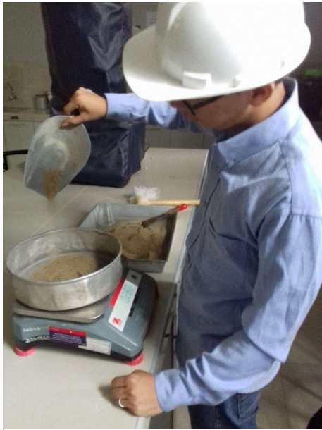
Figura 24, Toma de muestra para ensayo de peso específico – Arena.
