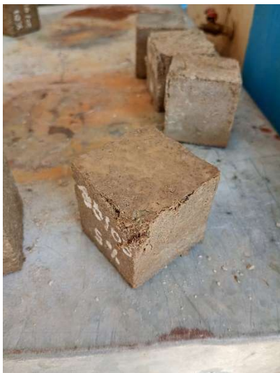
Figura 50, Rotura de probeta M5% de 7 días.
