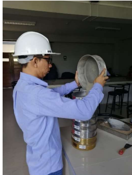
Figura 15, Ensayo de granulometría – Arena gruesa.
