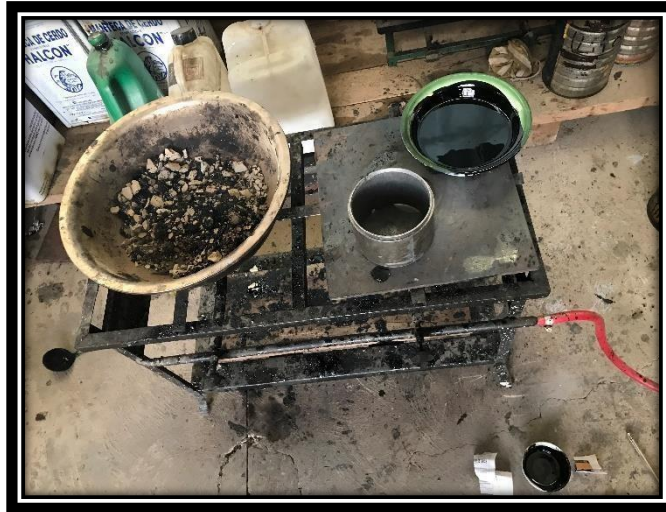
Figura 3.22. Agrega más cemento asfáltico para preparar la mezcla.
