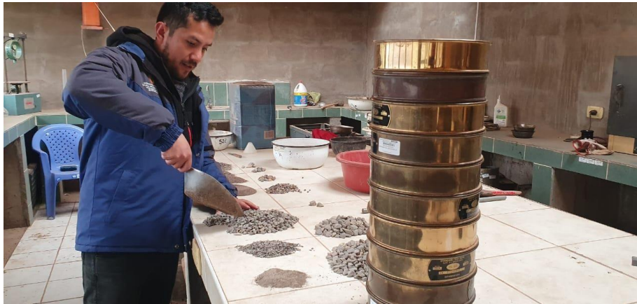
Figura 3.3. Se examina la granulometría de los agregados.
