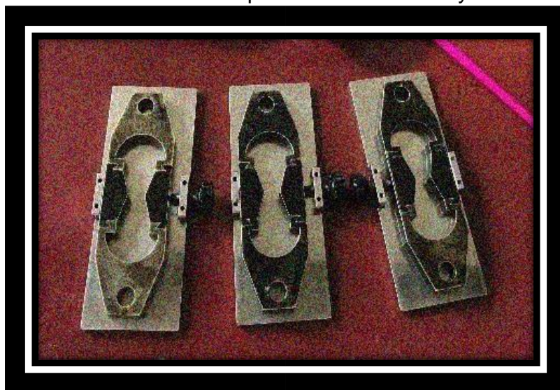
Figura 3.14. Moldes utilizados para realizar un ensayo de ductilidad
