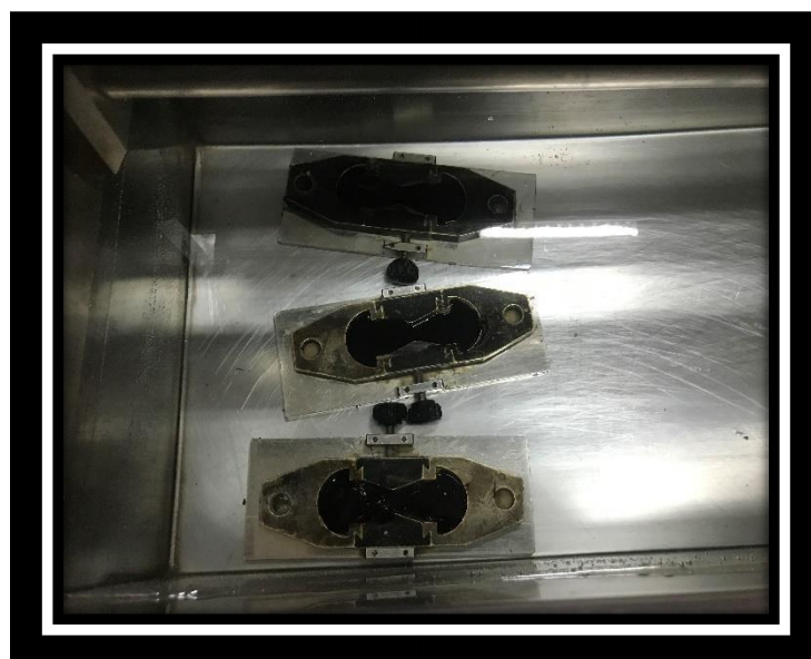
Figura 3.15. Para realizar el ensayo de laboratorio, una muestra de moldes se coloca a 25 °C.
