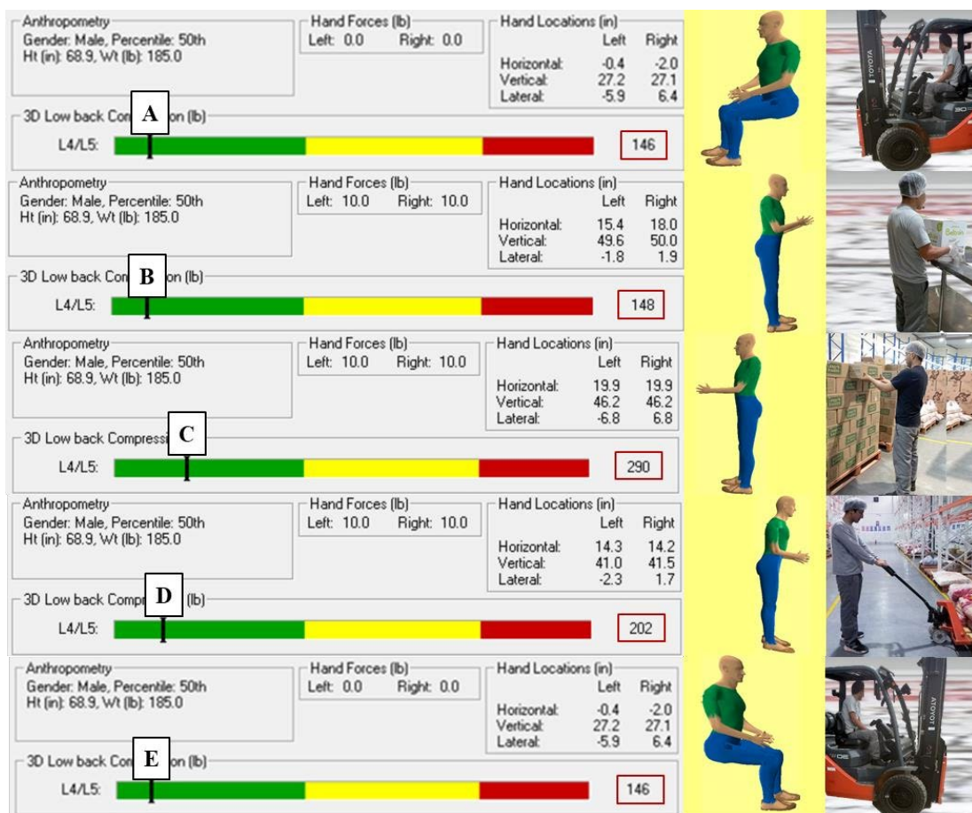
Figura N° 5. Evaluación de riesgos ergonómicos con software 3D SSPP - DESPUÉS
