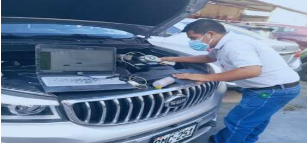
Figura 2. Verificación del sistema de gas
