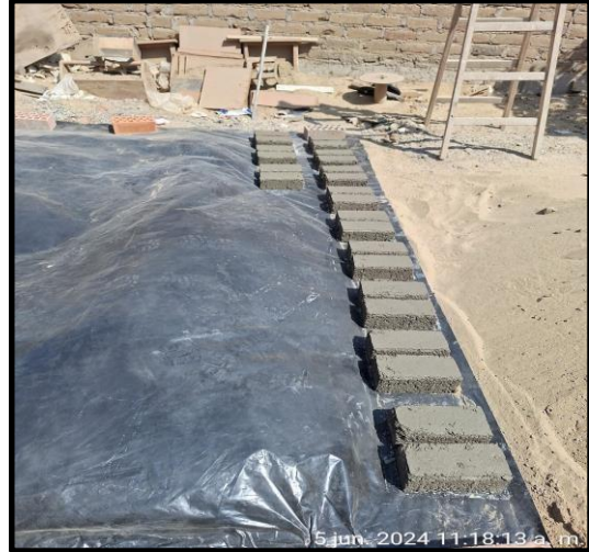
Imagen 6. Fabricación de los adoquines, colocación del material en el molde mientras la vibradora está en función para eliminar vacíos y seguidamente su desmolde.
