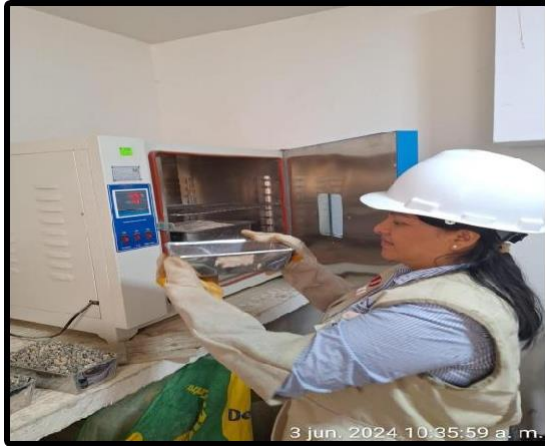
Imagen 4. Selección de las muestras de los agregados para su análisis de propiedades físicas como contenido de humedad, peso específico, granulometría y absorción
