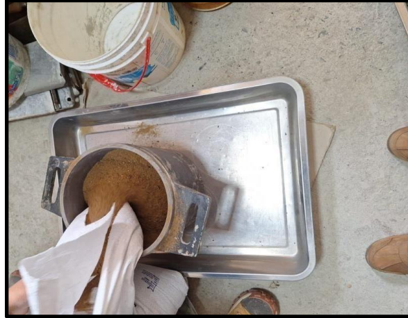
Imagen 4. Selección de las muestras de los agregados para su análisis de propiedades físicas como contenido de humedad, peso específico, granulometría y absorción
