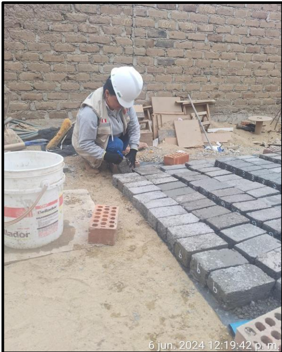
Imagen 7. marcado de adoquines según sus porcentajes de reemplazo de ceniza de coronta de maíz y colocación de las muestras para su curado hasta los 28 días e. Rotura de las muestras a los 7, 14 Y 28 días de curado
