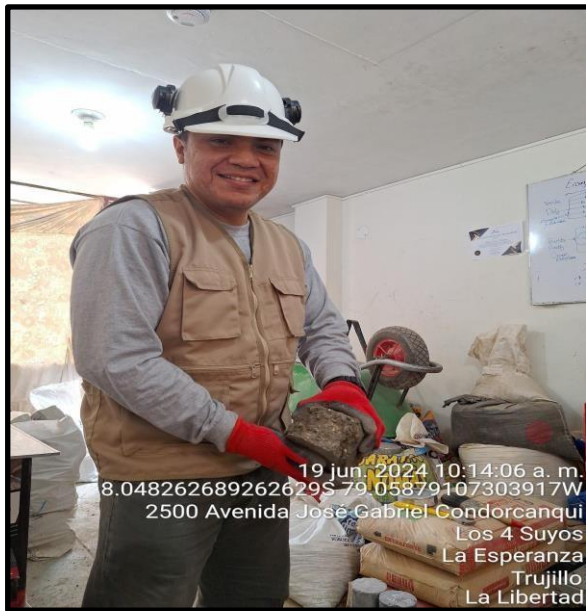
Imagen 11. Rotura de la muestra a los 14 días de curado
