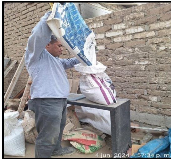
Imagen 5. pesado de la ceniza de coronta de maíz y de los agregados
