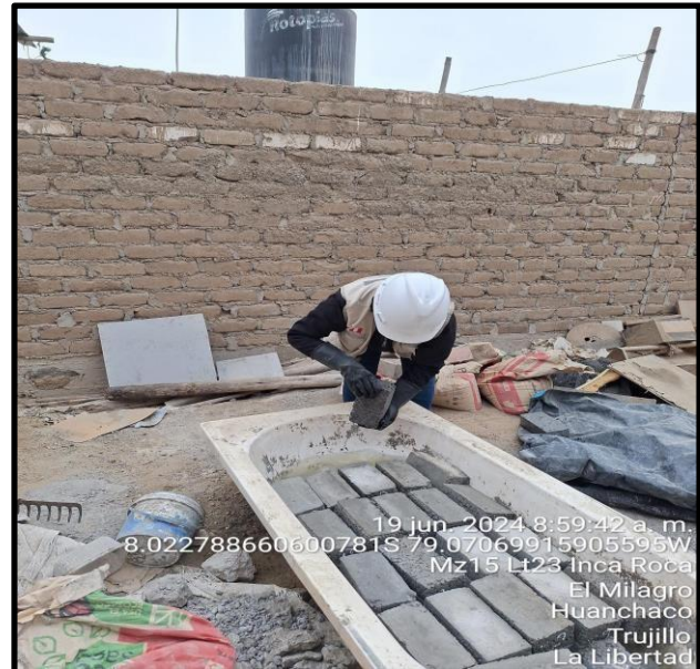
Imagen 9 Retirada de los adoquines del agua para ejercer su rotura y verificar su resistencia ante el peso ejercido
