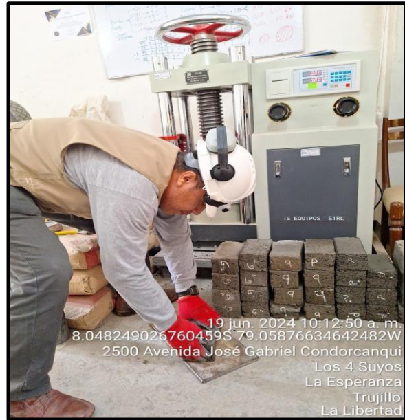
Imagen 11. Rotura de la muestra a los 14 días de curado
