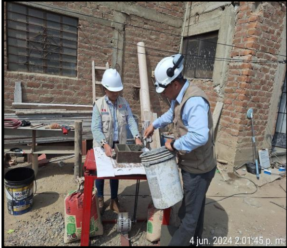
Imagen 6. Fabricación de los adoquines, colocación del material en el molde mientras la vibradora está en función para eliminar vacíos y seguidamente su desmolde.
