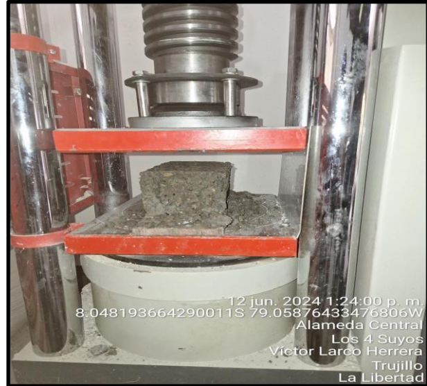
Imagen 8. Rotura de las muestras a los 7 días de curado, ensayo de resistencia a la compresión y flexión
