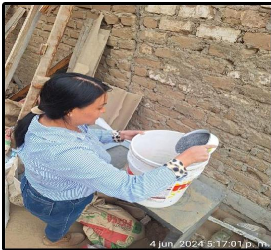
Imagen 5. pesado de la ceniza de coronta de maíz y de los agregados
