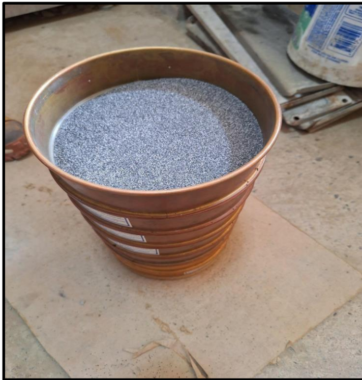
Imagen 3. Análisis de las propiedades físicas de la coronta de maíz (tamizado del material)
