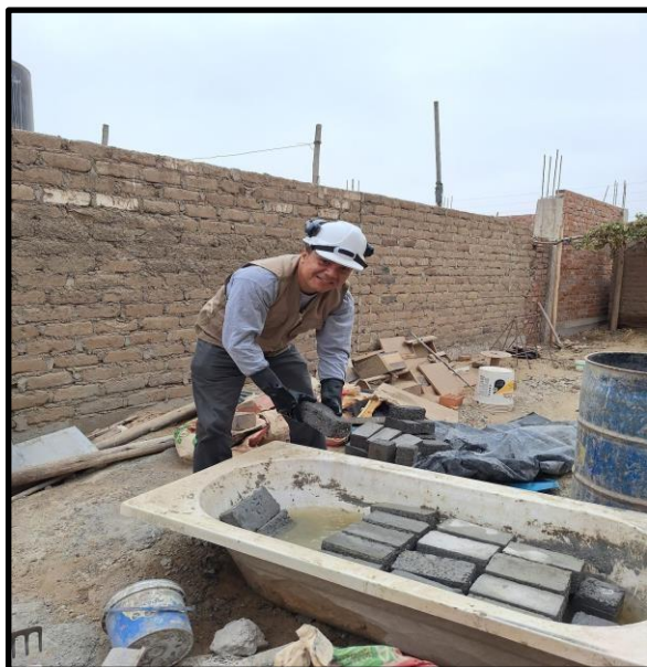
Imagen 9 Retirada de los adoquines del agua para ejercer su rotura y verificar su resistencia ante el peso ejercido
