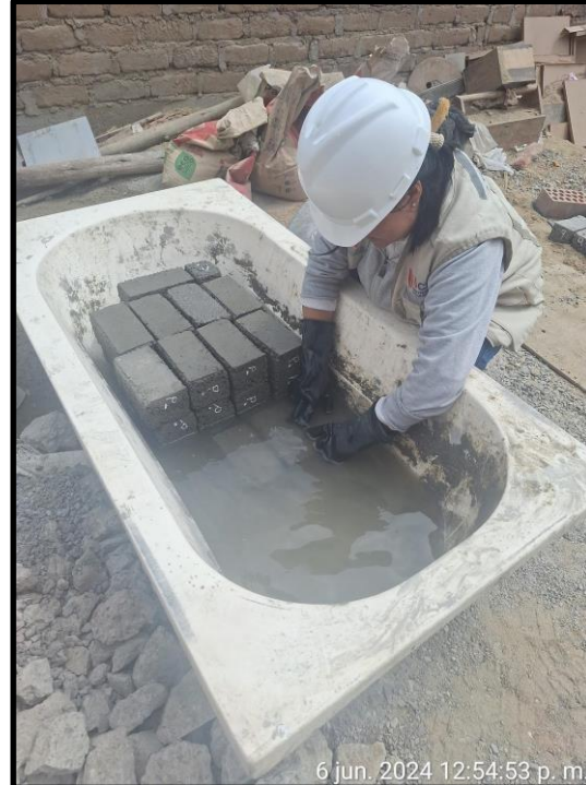
Imagen 7. marcado de adoquines según sus porcentajes de reemplazo de ceniza de coronta de maíz y colocación de las muestras para su curado hasta los 28 días e. Rotura de las muestras a los 7, 14 Y 28 días de curado
