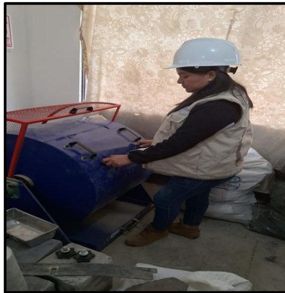
Imagen 13. Análisis de los agregados grueso fino para verificar su desgaste del agregado grueso y en el caso del fino hallar su finura obtenida y verificar si el material es bueno.
