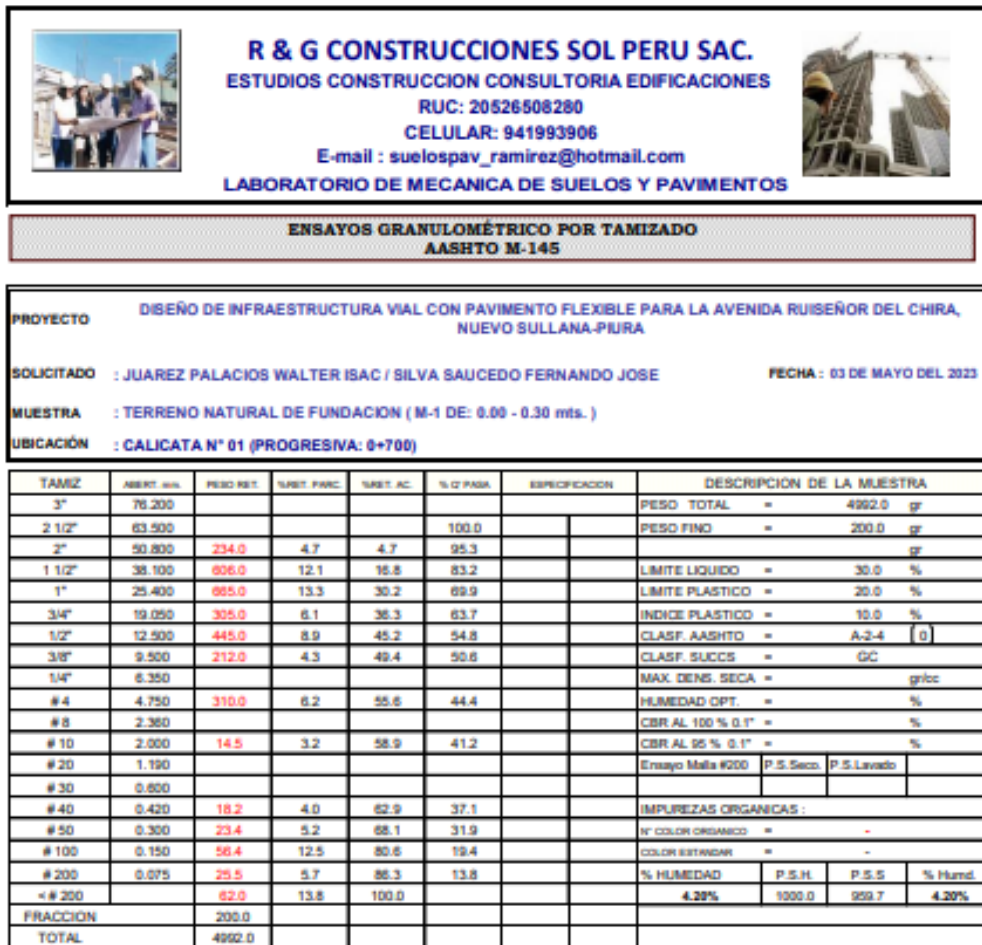
Figura 15: Ensayo granulométrico por tamizado- Calicata N°01 (Muestra 01)
