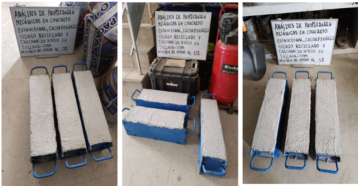
Imagen 05: Elaboración de Vigas para ensayo de resistencia a la flexión
