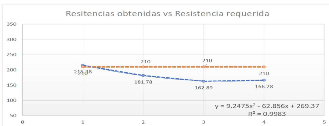
Figura 5. Análisis de regresión lineal de la resistencia a la compresión a los 28 días de curado
