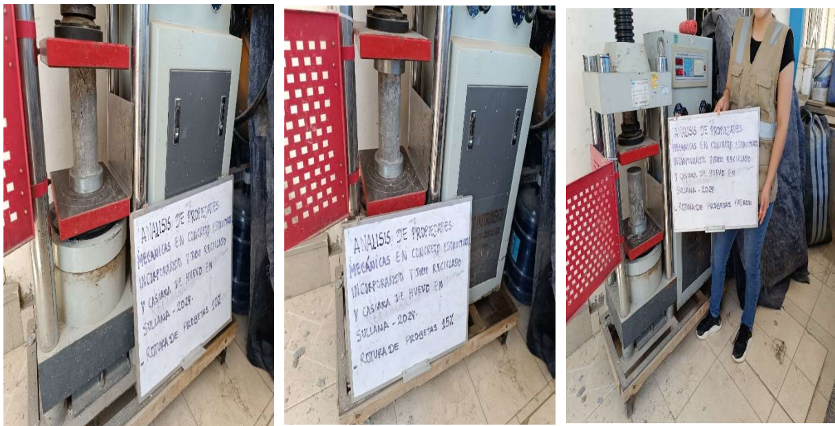
Imagen 06: Rotura de probetas
