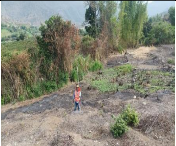
FOTO 08: Indica el trabajo de campo para levantar el terreno existente.
