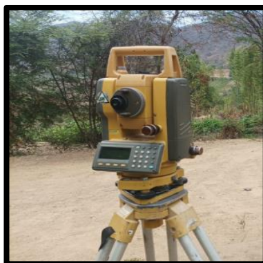
FIGURA 14. Se aprecia el equipo de medición, modelo ES-105 marca "TOPCOM"
