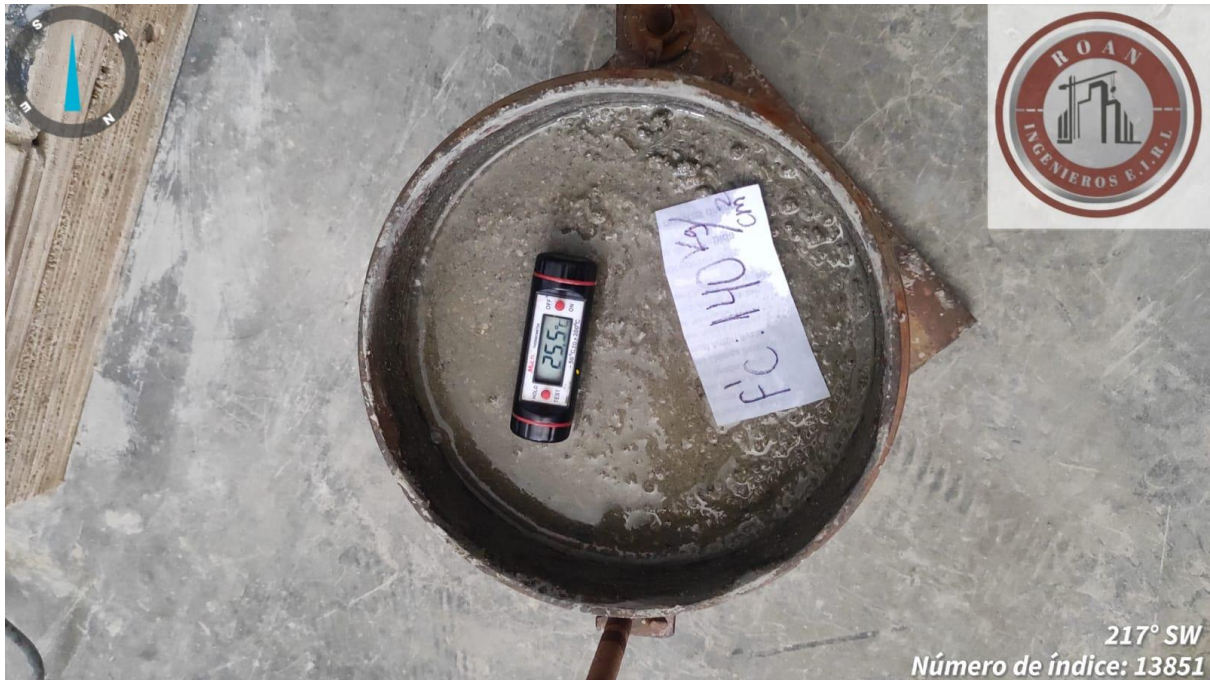
Toma de temperatura del mortero convencional para mampostería
