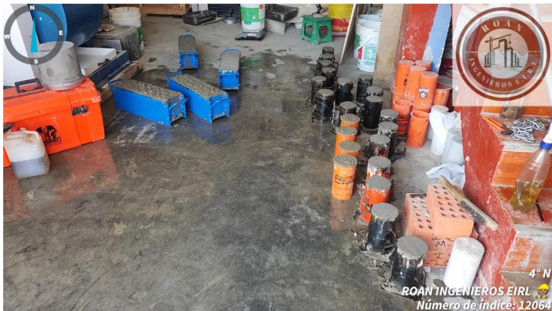
Llenado de probetas y vigas de mortero convencional
