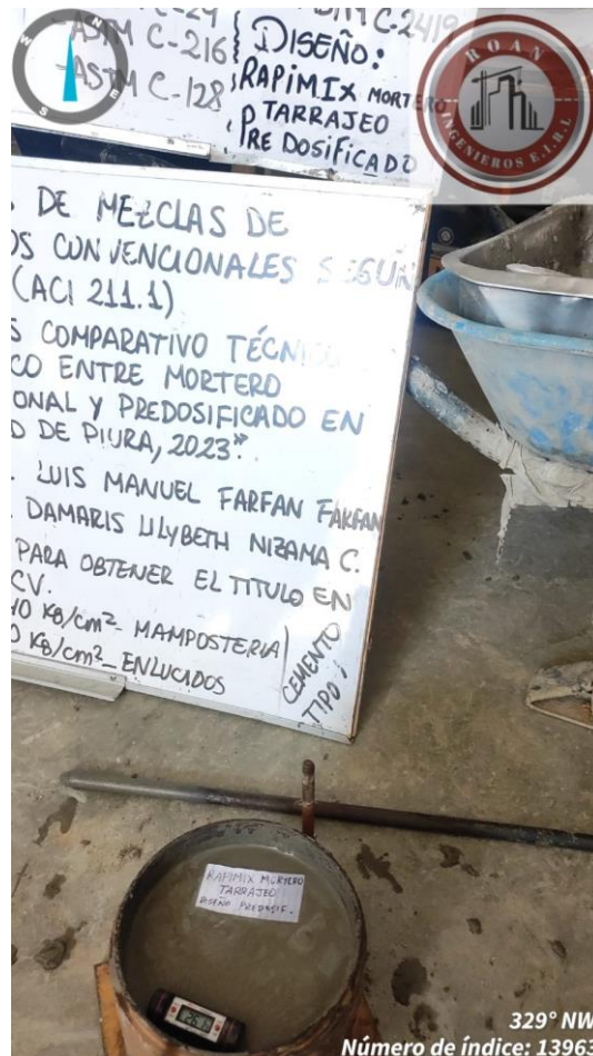
Toma de temperatura mortero predosificado para enlucidos
