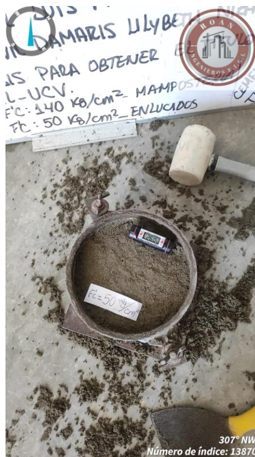
Toma de temperatura del mortero convencional para enlucidos
