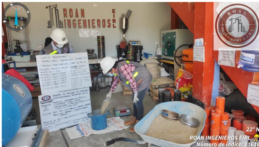
Llenado de la olla para calcular su peso
