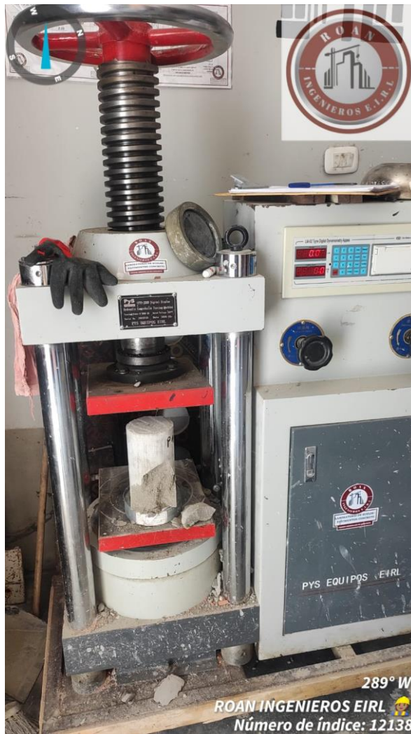
Pruebas de resistencia a la compresión
