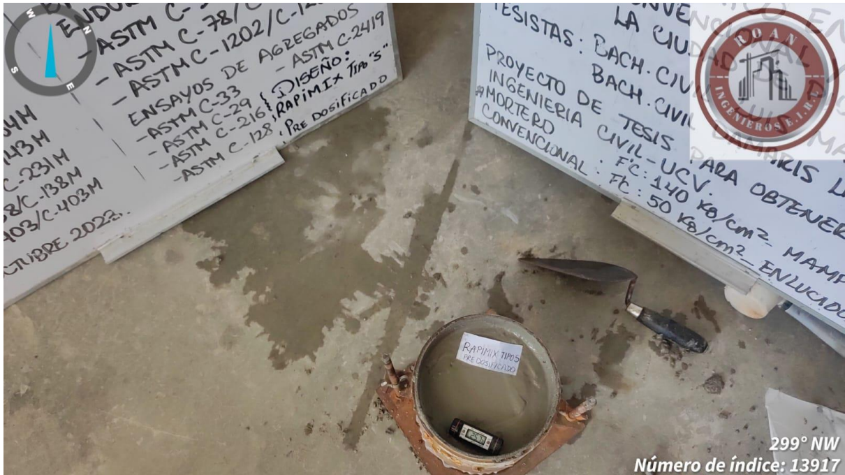
Toma de temperatura mortero predosificado para mampostería
