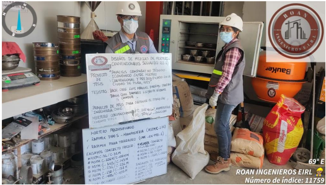
Colocación de muestra de agregado en horno
