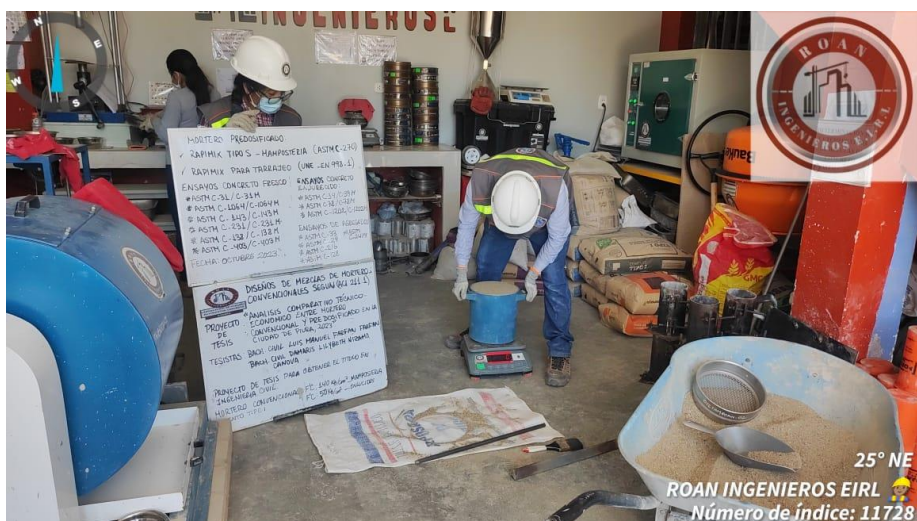
Colocación de la olla en la balanza para calcular peso
