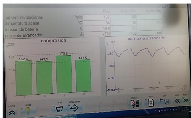
Figura 14 Medición de compresión del motor
