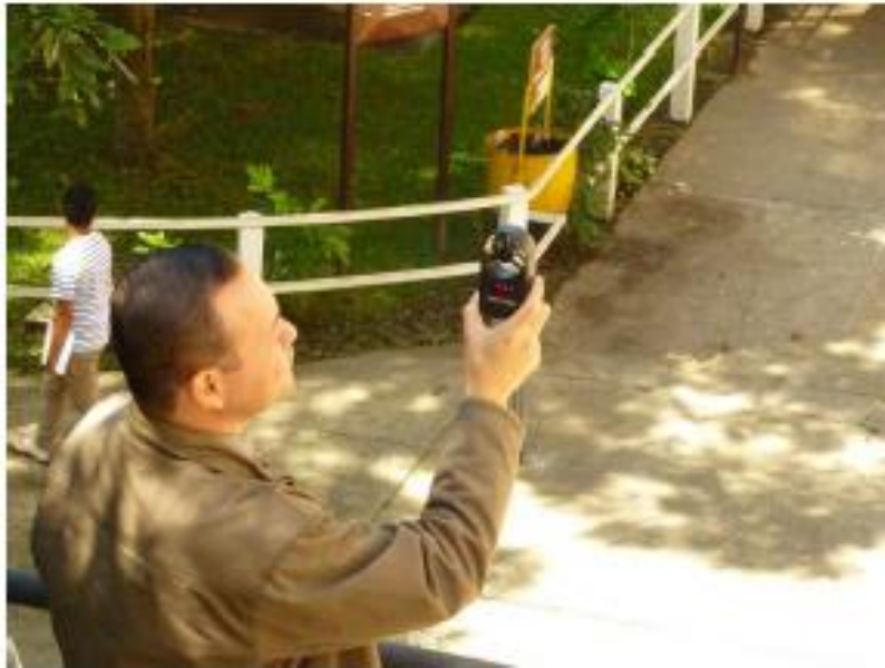
Fig. 1. Medición de viento en gradas de emergencia de edificio L.
