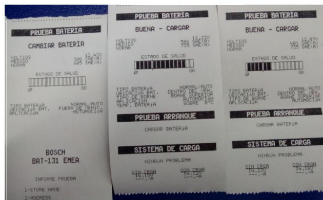
Figura 11 Estado del acumulador de energía
